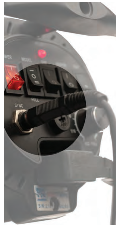
▲ تصویر ۱۹۶ اتصال سیم سینکرون به فلاش
