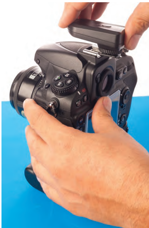
▲ اتصال ریموت فرستنده به دوربین | تصویر ۱۳۵
