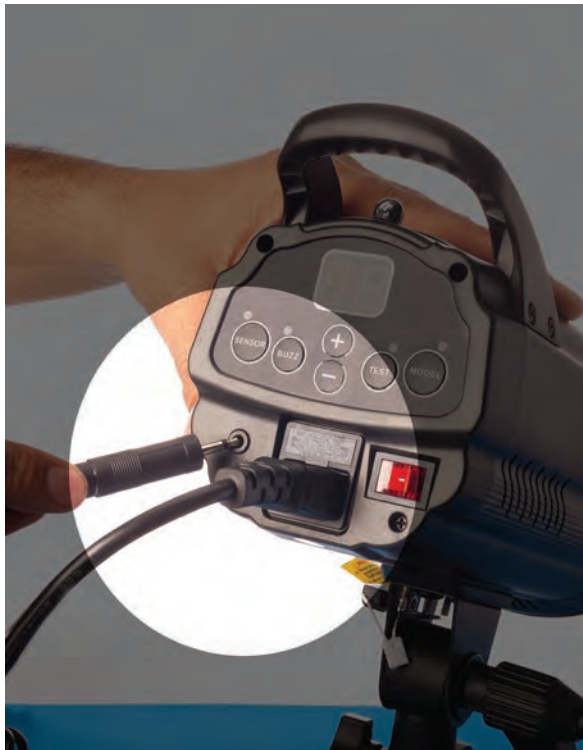
▲ اتصال سیم سینکرون رادیوتریگر به فلاش | تصویر ۱۳۶
