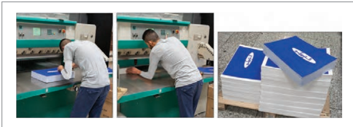
تصویر ۷ برش نهایی، کنترل ابعاد نهایی توسط برشکار طبق دستور کار و ماکت طراح
