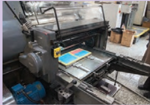
تصویر ۱۰ نصب قالب روی ماشین لترپرس
