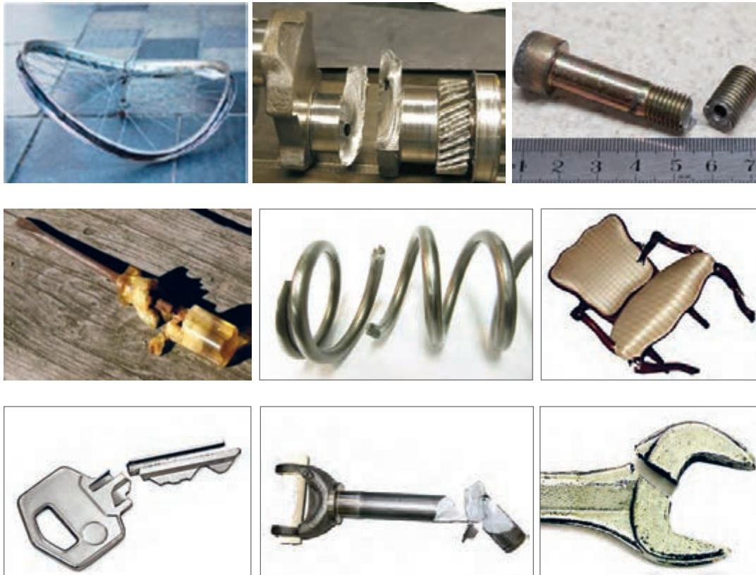
شکل ۴-۱- خرابی و شکستگی در قطعات و سازه‌ها
