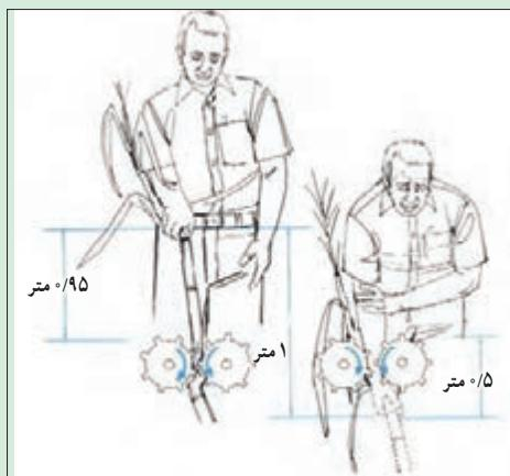
شکل ۱-۲۷- سعی در رفع گیر کردن ماشینی که در حال کار است یک مخاطره شدید محسوب می‌شود
