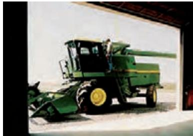
شکل ۲-۱۹- با نگهداری ماشین در مکان سرپوشیده و مناسب می‌توان در بسیاری از هزینه‌های تعمیراتی آینده صرفه‌جویی نمود.
