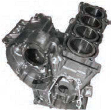
شکل ۵-۲۰—بدنه موتور (چدن خاکستری)
