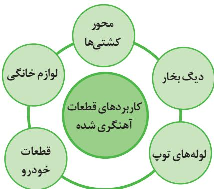
فلزاتی را می توان آهنگری کرد که ترد نباشند و ویژگی چکش خواری خوبی داشته باشند. برای نمونه، چدنها چون ترد هستند بر اثر ضربات چکش یا پتک ترک می خورند و نمی توان آنها را آهنگری کرد. میل لنگ و دسته پیستون خودرو نمونه هایی از قطعات آهنگری شده هستند.
