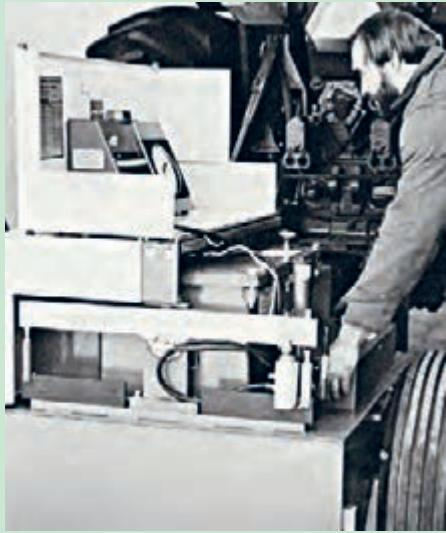
شکل ۳-۳۶- اندازه‌گیری توان یک تراکتور با دینامومتر
