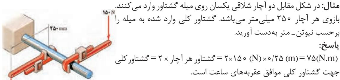
مثال: در شکل مقابل دو آچار شلاقی یکسان روی میله گشتاور وارد می‌کنند. بازوی هر آچار ۲۵۰ میلی‌متر می‌باشد. گشتاور کلی وارد شده به میله را بر حسب نیوتون-متر به دست آورید.
