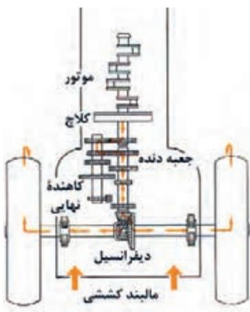
شکل ۳-۳۲- تراکتورها توان دورانی میل لنگ را به توان کششی تبدیل می‌کنند.
