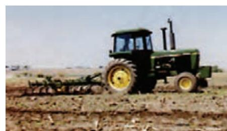
ج) برای بارهای سبک‌تر از دندنهای سبک تر استفاده کنید. توجه داشته باشید سبک کردن بیش از حد دندنه به بیش باری روی تراکتور و خاموش شدن آن منجر می‌شود.
