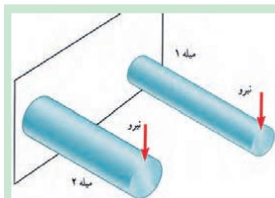
شکل ۴-۳۰- بارگذاری خمشی دو میله با جنس و طول یکسان
