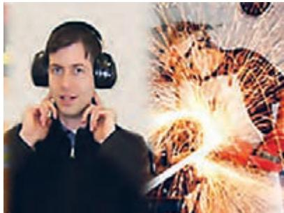
شکل ۱-۲- استفاده از گوشی های ایمنی نقش مهمی در کنترل سروصداي محیط کار دارد
