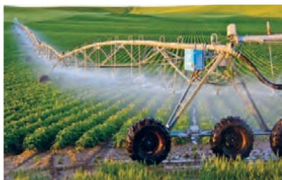
شکل ۲-۹- سیستم مکانیزه آبیاری تحت فشار
