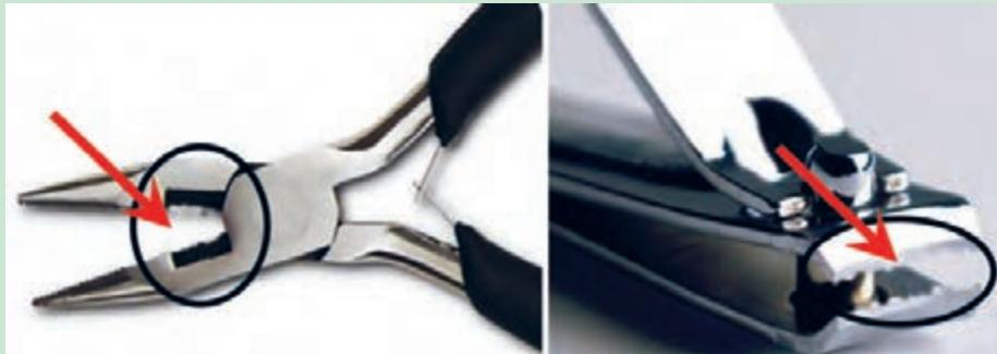
شکل ۴-۱۹- لبه‌های برنده خراب شده در ناخن‌گیر و دمباریک
