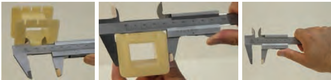
شکل ۱۱- نحوه اندازه گیری با کولیس
