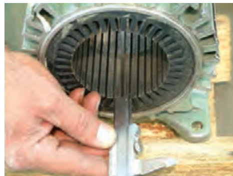
شکل ۲۷- اندازه گیری طول و قطر داخلی استاتور
