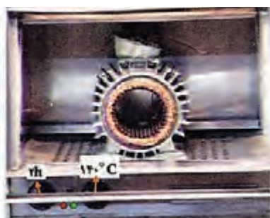
شکل ۵۹- قرار دادن استاتور در کوره حرارتی برای گرفتن رطوبت سیمها
