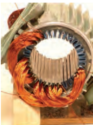
شکل ۶۸- قرار گرفتن سومین گروه کلاف در شیارها
