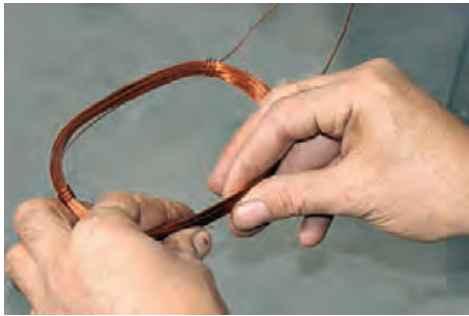
شکل ۳۸-۲ مرتب کردن سیم‌ها جهت کلاف گذاری
