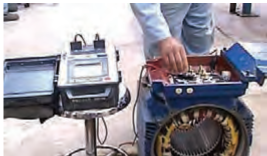
آزمایش تست بدنه موتور با دستگاه میگر
