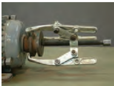
شکل ۱۷- در آوردن پولی از محور موتور
