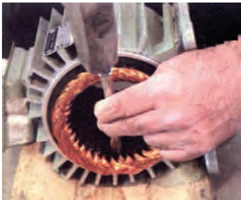
شکل ۲۱- بریدن سیم‌ها توسط قلم
