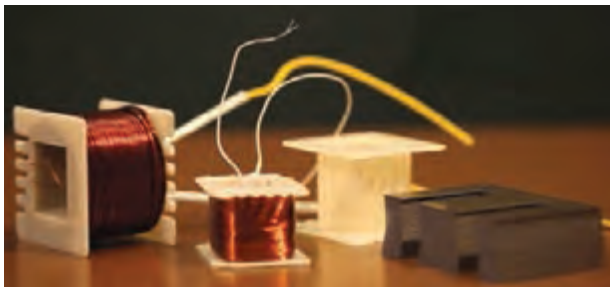
شکل ۳۴- تجهیزات سیم‌پیچی ترانسفورماتور
