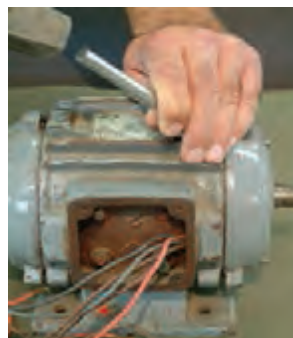
شکل ۱۸- باز کردن پیچ‌های موتور و درپوش‌ها
