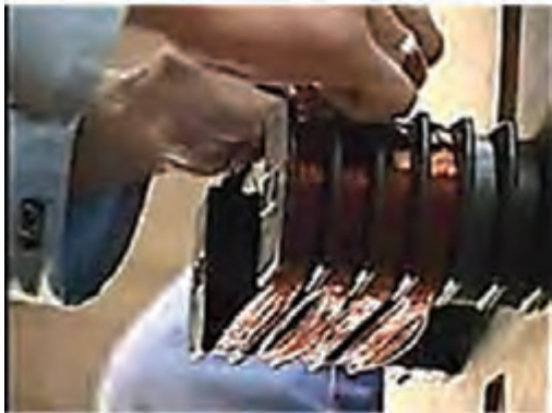
شکل ۳۴- بستن کلاف‌های پیچیده شده روی قالب
