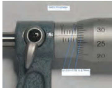
شکل ۱۴- اندازه‌گیری قطر اجسام با میکرومتر
