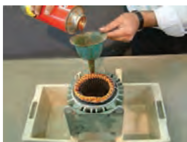
شکل ۶۰- شارلاک زدن سیم پیچی استاتور
