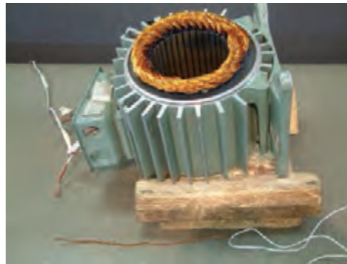
شکل ۳۹- جا زدن سیم پیچ
