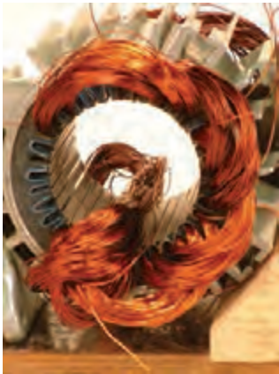
شکل ۶۹- درآوردن بازوهای ۱،۲،۳ برای قرار دادن کلاف آخر
