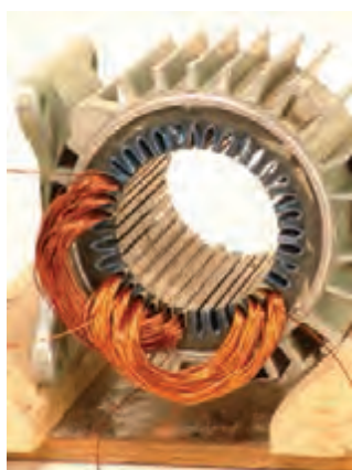
شکل ۶۷- قرار گرفتن دومین گروه کلاف در شیارها
