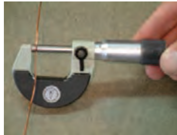
شکل ۲۶- اندازه گیری قطر سیم و شمارش تعداد دور یک بازو
