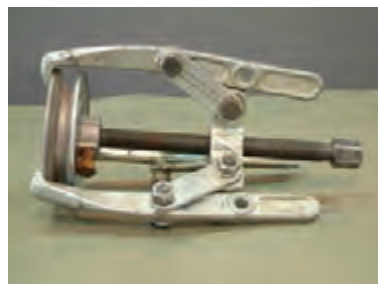
شکل ۱۷- در آوردن پولی از محور موتور
