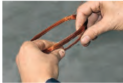
شکل ۳۸-۱ طریقه در دست گرفتن کلاف
