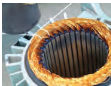
شکل ۵۸- نخ بندی سیم پیچی موتور
