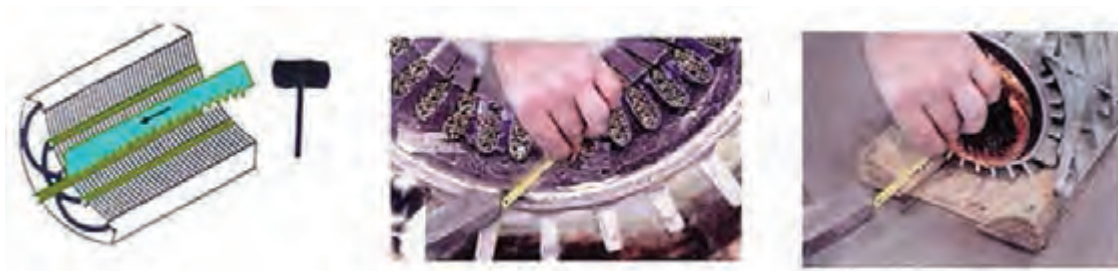
شکل ۲۳- خارج کردن پرسیان از شیار
