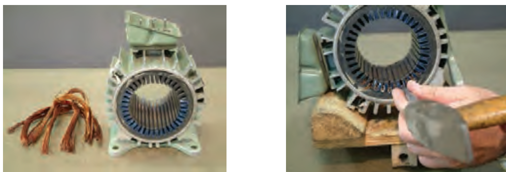
شکل ۲۴- سیم های خارج شده از شیارها
