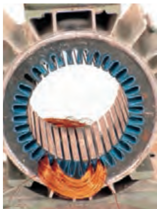
شکل ۶۶- قرار گرفتن اولین گروه کلاف در شیارهای استاتور
