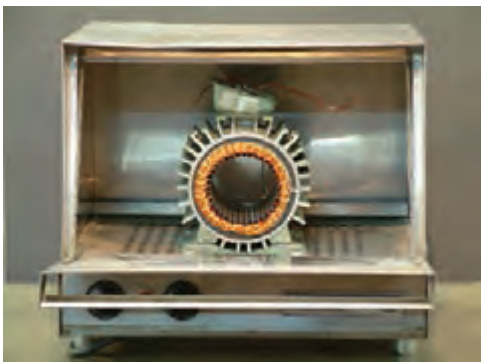
شکل ۲۲- گرم کردن سیم پیچ
