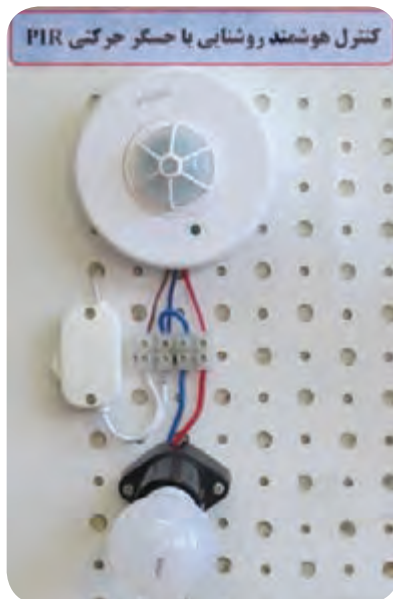
شکل ۲۹-۲ نحوه سیم‌کشی حسگر حرکتی PIR
