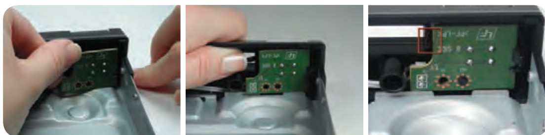
شکل ۶-۳۳ محل زائده پلاستیکی شکل ۶-۳۴ فشار دادن زائده پلاستیکی شکل ۶-۳۵ دمونتاز برد کوچک
