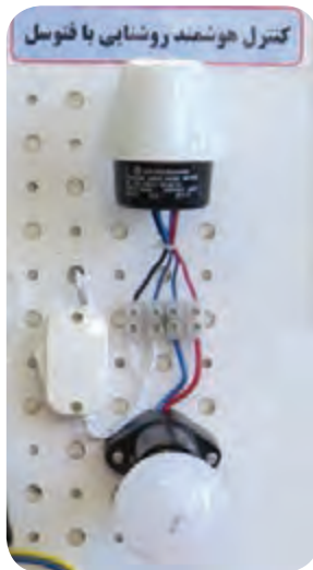
شکل ۲-۱۹- نحوه سیم‌کشی فتوسل
