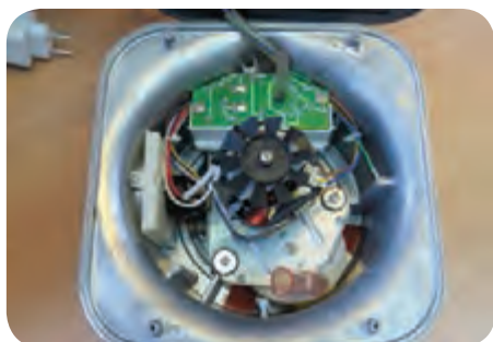
شکل ۲۴-۱- موتور، برد الکترونیکی و پروانه
