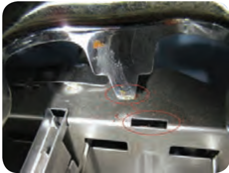
شکل ۶-۵۸ خار نر و ماده جهت اتصال
