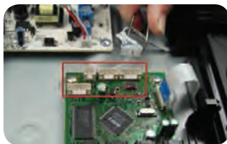
شکل ۱۹-۶ جدا کردن سوکت‌ها از برد پردازشگر
