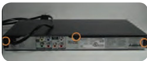
شکل ۶-۱۵ پیچ‌های پشت دستگاه
