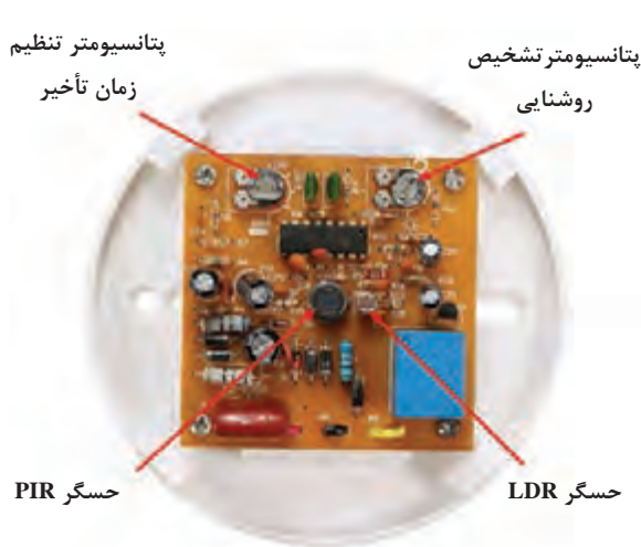
شکل ۲-۲۷- مدار داخلی یک نمونه حسگر سقفی
