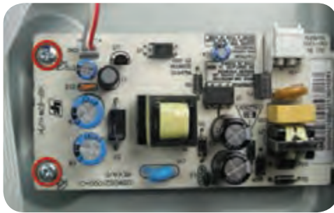
شکل ۶-۲۴ محل پیچ‌های محکم‌کننده برد منبع تغذیه
