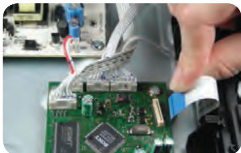
شکل ۱۸-۶ آزادسازی کابل پردازشگر
