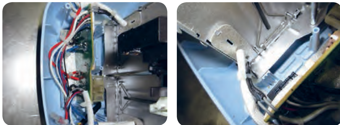
الف شکل ۶-۴۹ محل قرار گرفتن حسگر حرارتی
