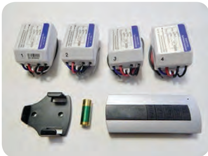
شکل ۲-۳۵- یک نمونه دستگاه کنترل از راه دور ۴ کاناله
