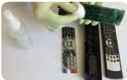
شکل ۱-۱۰- تمیز کردن کنتاکت‌ها با الکل
