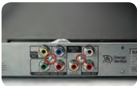
شکل ۲۲-۶ باز کردن پیچ‌نهایی برد پردازشگر
