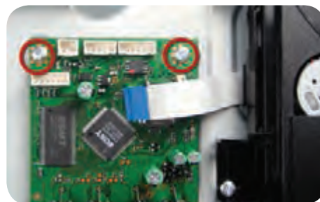
شکل ۲۱-۶ باز کردن پیچ‌های اتصال دهنده برد پردازشگر به کف دستگاه
