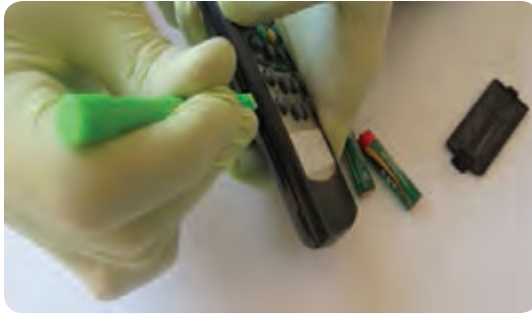
شکل ۸-۱ آزاد کردن خارهای قاب دستگاه ریموت کنترل
