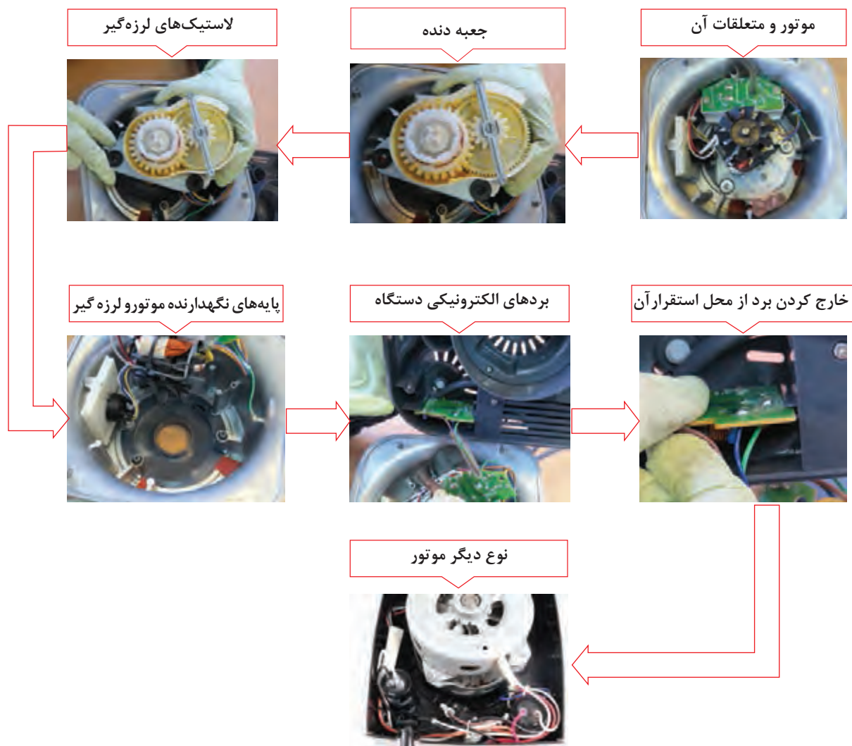
شکل ۱-۲۷- اینفوگرافی جدا کردن برد الکترونیکی دستگاه غذاساز
