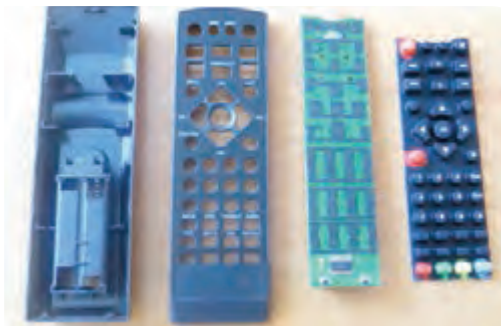
شکل ۳-۱. اجزای دستگاه ریموت کنترل
