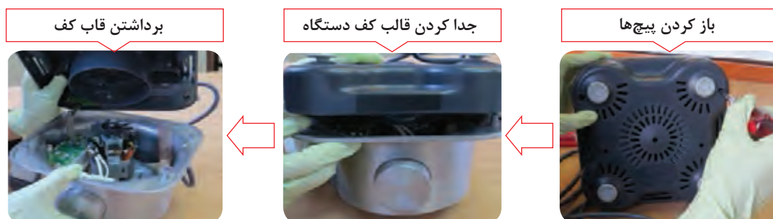
شکل ۲۲-۱- اینفوگرافی باز کردن کف دستگاه
