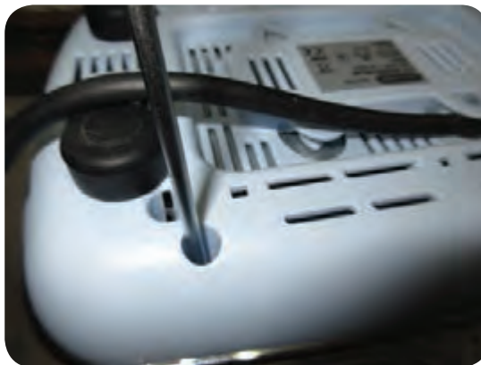
شکل ۶-۴۲ تشخیص نوع و محل پیچ‌های باز شده
