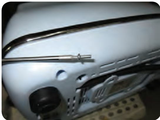
شکل ۶-۴۳ استفاده از ابزار خاص برای پیچ‌های ویژه
