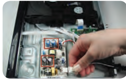
شکل ۶-۲۳ آزادکردن سوکت منبع تغذیه
