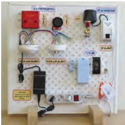
شکل ۳-۵۴- تابلوی اعلام حریق
