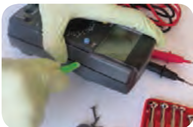
شکل ۱-۱۵- جدا کردن دو قسمت بدنه
