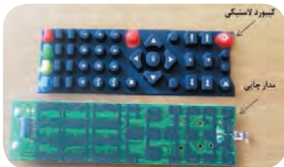
شکل ۴-۱. صفحه کلید و برد دستگاه ریموت کنترل
