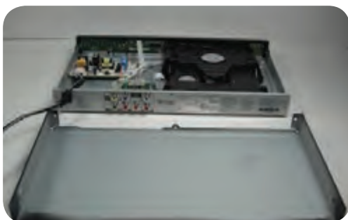
شکل ۶-۱۷ قاب پایینی جدا شده است
