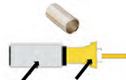
شکل ۳-۲۲- قراردادن حلقه روی کابل
