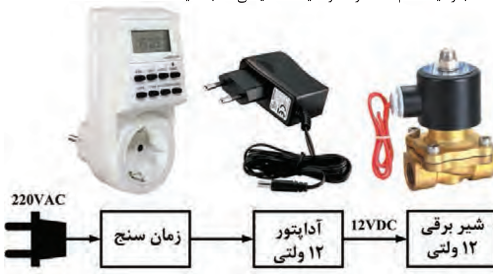
شکل ۲-۴۸- نصب شیر برقی ۱۲ ولت
