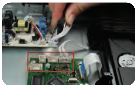
شکل ۲۰-۶ جدا شدن تمامی سوکت‌ها از برد
