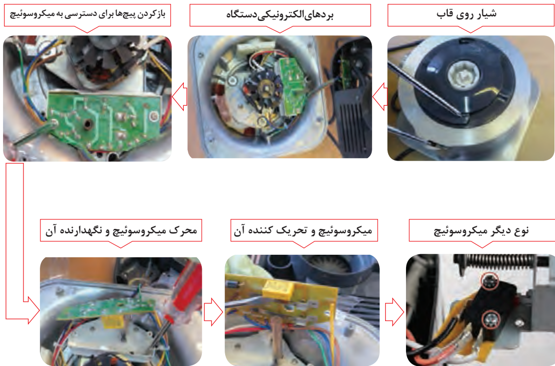
شکل ۲۵-۱- اینفوگرافی جدا کردن میکروسوییچ
