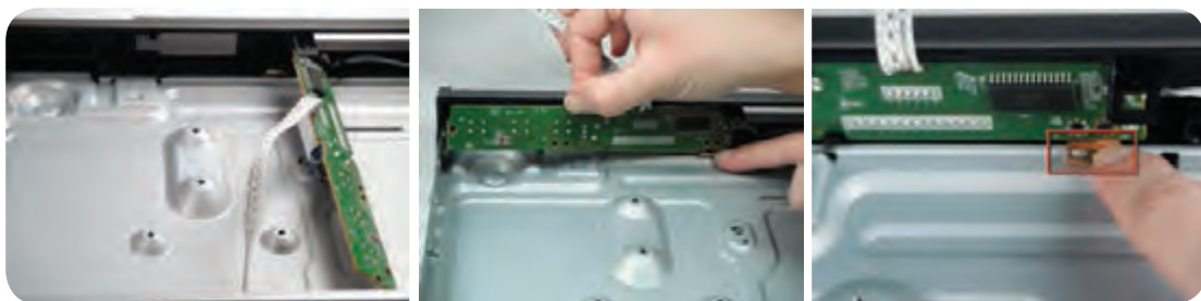
شکل ۶-۳۰ زائده سمت راست شکل ۶-۳۱ فشار دادن زائده و خارج کردن برد شکل ۶-۳۲ پنل دمونتاز شده
