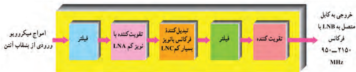
شکل ۴-۲۶ بلوک دیاگرام ساده LNB
