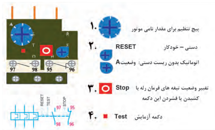
شکل ۵-الف) تنظیم رله اضافه بار یا بی‌متال
