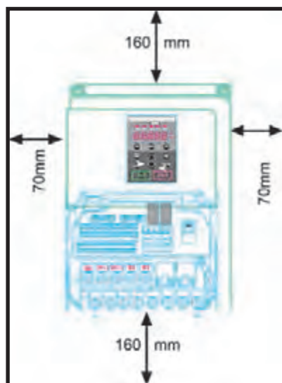
شکل ۷- رعایت فاصله جانبی اینورتر با سایر وسایل
