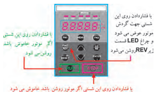
شکل ۲۱- این سه شستی روی اغلب کی پدها برای راه اندازی موتور در حالت Forward و Reverse وجود دارند.
