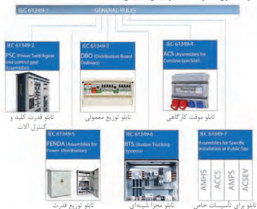
شکل ۳- دسته‌بندی انواع تابلوهای برق فشار ضعیف
