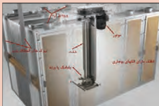
شکل ۳۴- موتور ۷۵ کیلووات با جریان نامی ۱۷۰ آمپر
