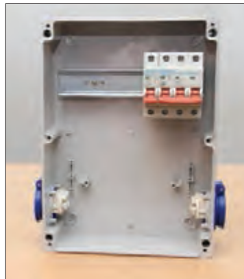
شکل ۲۲- نصب کلید جریان باقیمانده (نشتی)
