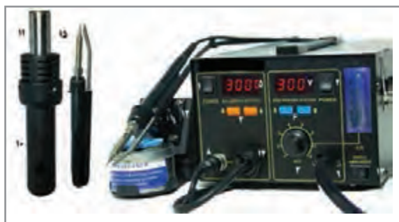
شکل ۱-۲ قسمت‌های مختلف یک نمونه دستگاه هویه هوای گرم
