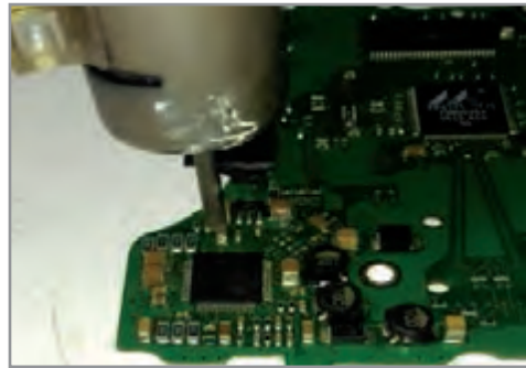
شکل ۲-۴ دمونتاز آی سی های چهار طرفه (خرچنگی)
