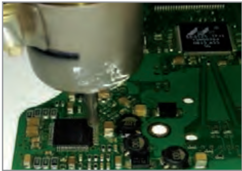
شکل ۲-۴ دمونتاز آی سی های چهار طرفه (خرچنگی)
