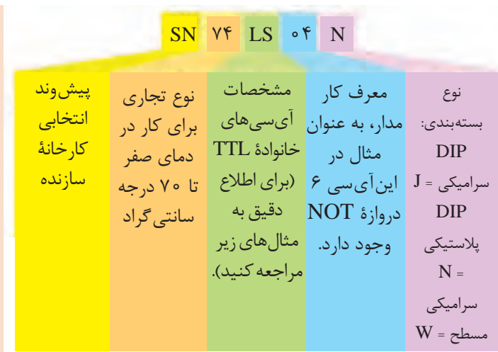
مثال‌هایی مربوط به مشخصات آی‌سی‌های خانواده TTL
