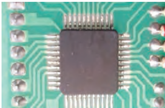
شکل ۱۰-۳ قرار دادن قطعه در محل خود
