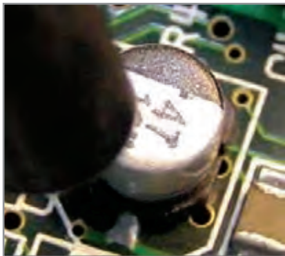
شکل ۲-۳ دمونتاز خازن سرامیکی و الکتrolیت SMD
