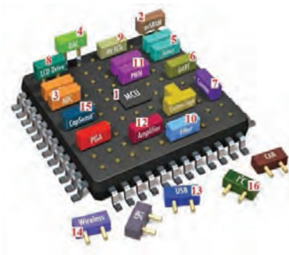
ب) ساختار داخلی میکروکنترلر ARM
