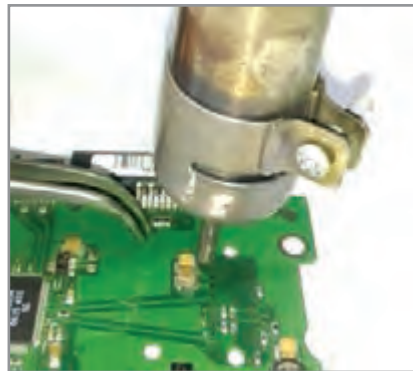
شکل ۲-۳ دمونتاز خازن سرامیکی و الکتrolیت SMD
