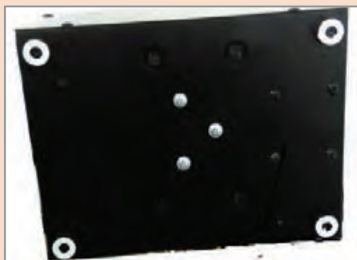
شکل ۱-۴ سه پیچ قفل‌کننده کمپرسور به بدنه
