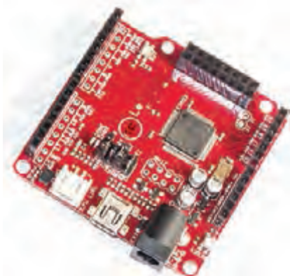
ب) برد مدار چاپی پروژه میکروکنترلر
