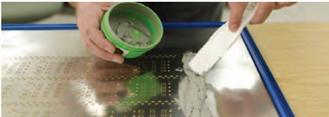
شکل ۱۲-۳ خمیر اندود کردن لحیم به کمک شابلون
