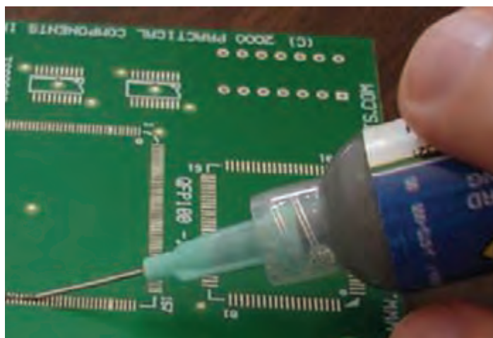
شکل ۳-۴ اضافه کردن مایع فلاکس در محل قرار گیری قطعه
