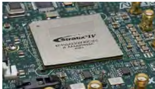
شکل ۲۳-۵ کاربرد آی‌سی FPGA در مدارهای پیشرفته
