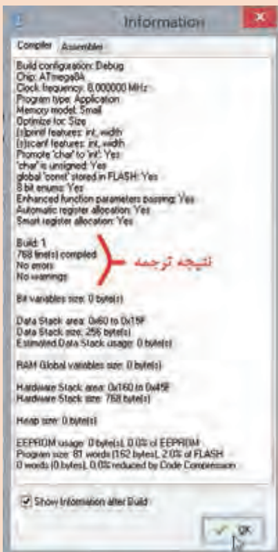
شکل ۷-۹ نتیجه کار مترجم (Compiler) زبان C
