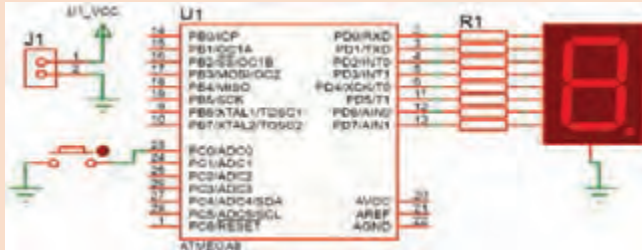
شکل ۷-۳۸ مدار شمارنده یک رقمی
