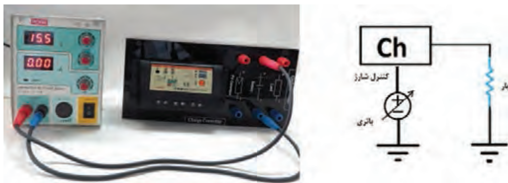
شکل ۱۹- حالت کنترل دشارژ
