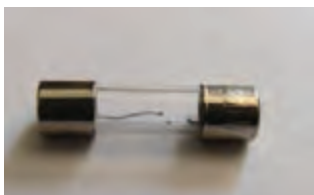
شکل ۴۹- فیوز سر راه باتری سوخته است.
