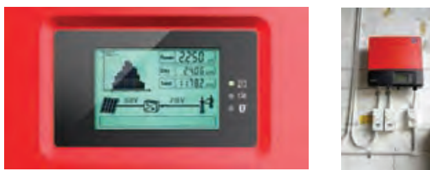
شکل ۴۰- صفحه نمایش یک اینورتر با توان ۲/۲۵ کیلو وات
