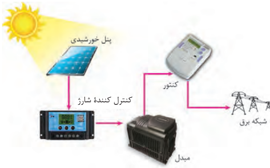
شکل ۵۱- نقشه ارتباط عناصر سیستم فتوولتائیک On_Grid
