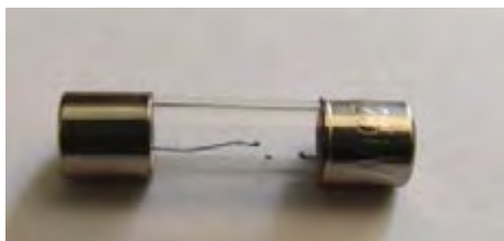
شکل ۱۶ - فیوز آسیب دیده است.
