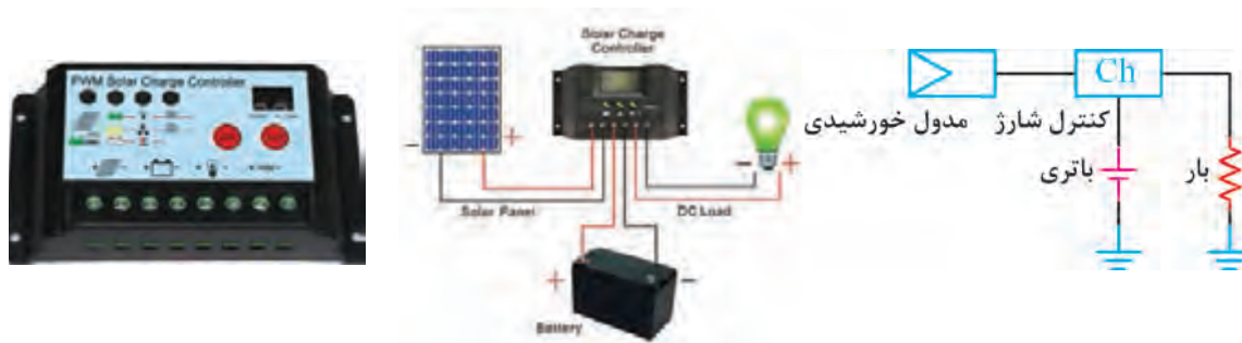
شکل ۳۳- یک نمونه کنترل کننده شارژ باتری (اتصال و شمای فنی)
