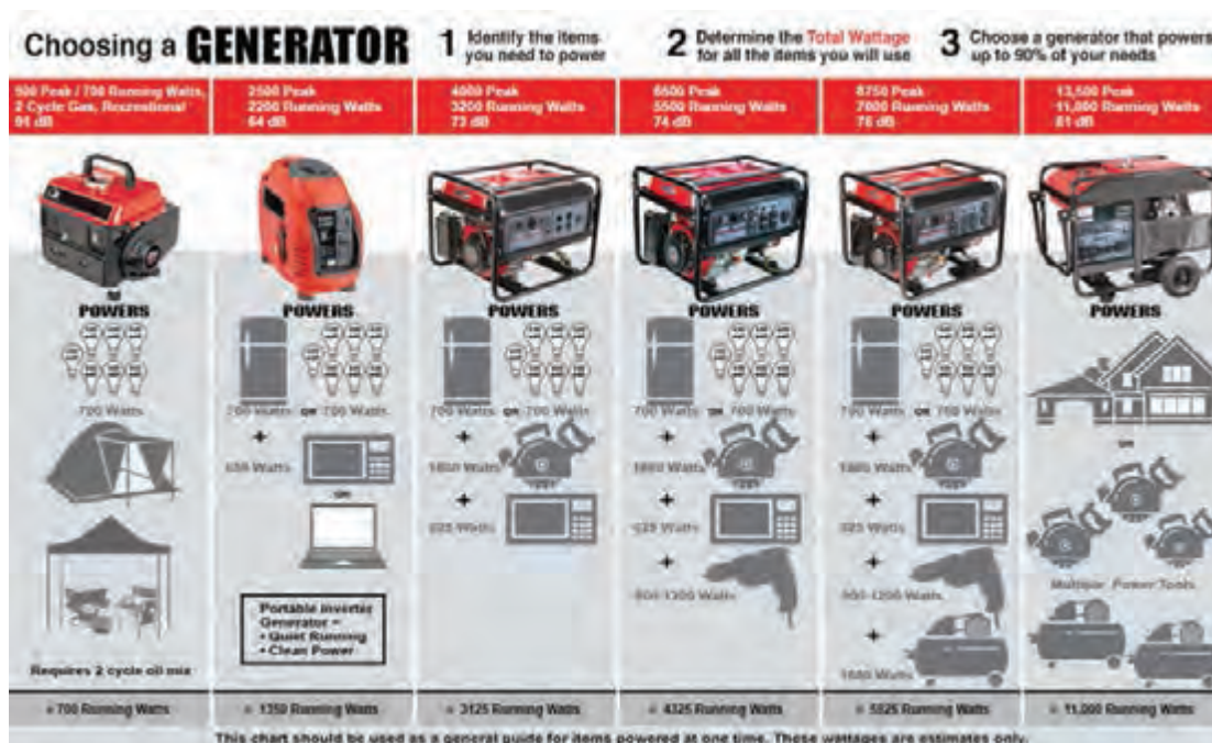
شکل ۱۰- چند نمونه موتور ژنراتور و مقایسه توان تولیدی آنها
