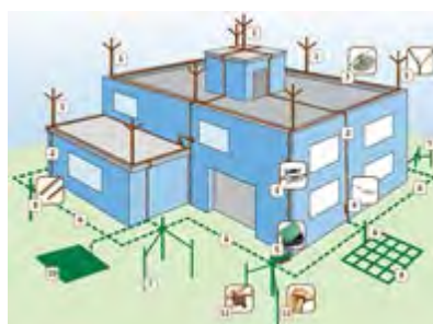
شکل ۳۸ – پراکنده کردن صاعقه در زمین
