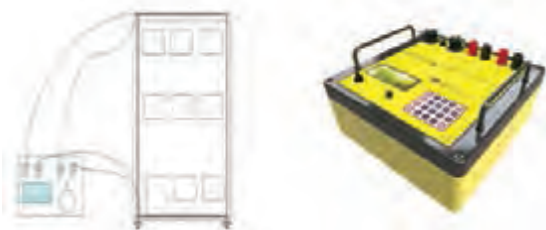
شکل ۳۰ - دستگاه چهار سیمه و طریقه اندازه‌گیری
