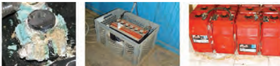
شکل ۲۱- سولفاته و نشستی باتری
