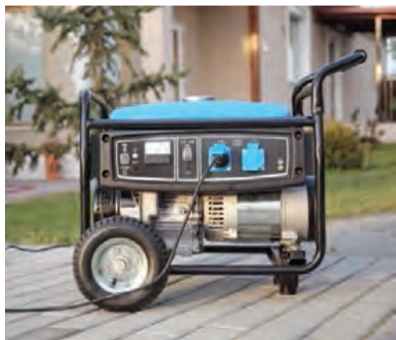
شکل ۷- موتور ژنراتور بنزینی یا گازسوز
