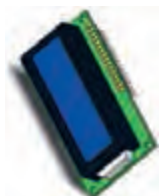
LCD کاراکتری برای نمایش اطلاعاتی مانند فاصله
