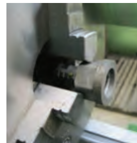
الف: بستن قطعه شش گوش در سه‌نظام
