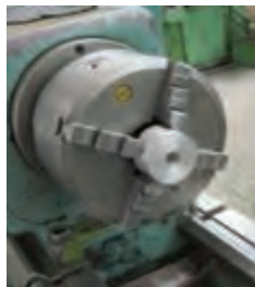
ب: بستن قطعه گرد در چهار نظام
