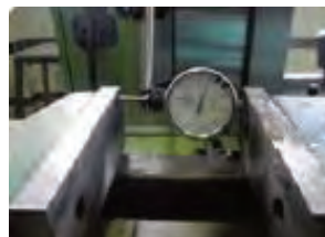
تنظیم گیره به کمک ساعت اندازه گیری
