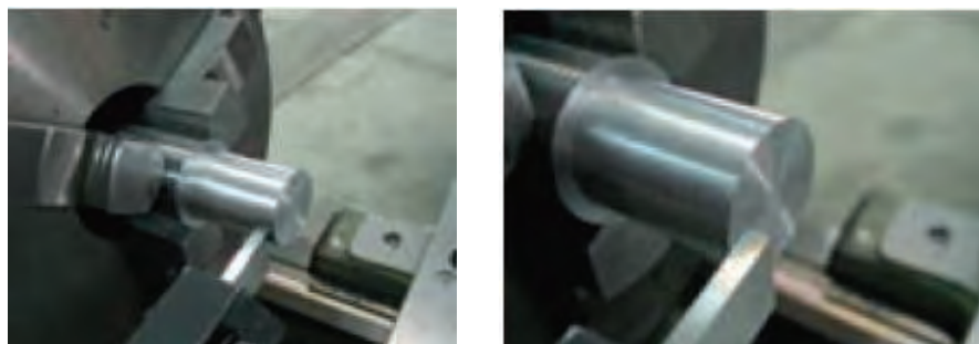
الف: مماس کردن رنده به پیشانی کار ب: حرکت طولی برای موقعیت شیار
