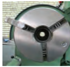
الف: استقرار فک روی پیچ ارشمیدس
