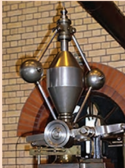
شکل ۲۰- دو نمونه صنعتی از گاورنر که در صنایع به کار برده می‌شوند
