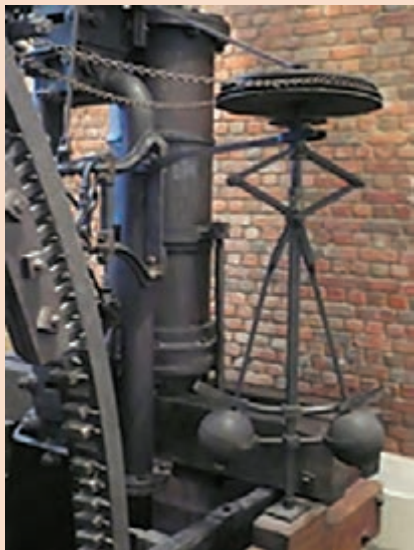
شکل ۲۰- دو نمونه صنعتی از گاورنر که در صنایع به کار برده می‌شوند
