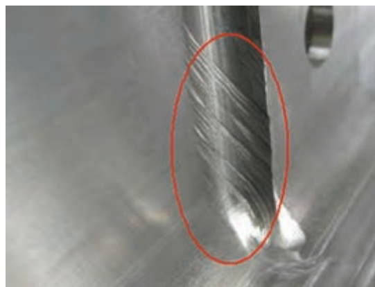
شکل ۱۸- برخی از اثرات مخرب ارتعاش در فرایند ماشین کاری که به چترینگ معروف است.
