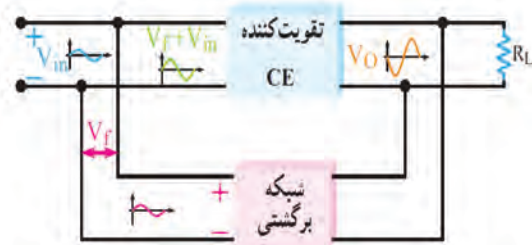
شکل ۱۰-۱۷- بلوک دیاگرام تقویت کننده با فیدبک مثبت
