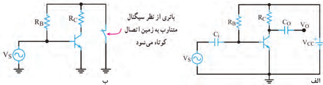
شکل ۱۰-۱۰-۱- باتری در برابر سیگنال ac
