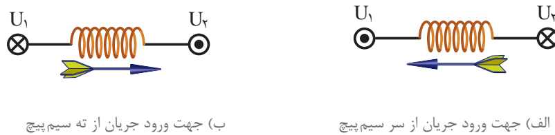
شکل ۲۰- جهت جریان جاری در سیم‌پیچ‌ها
