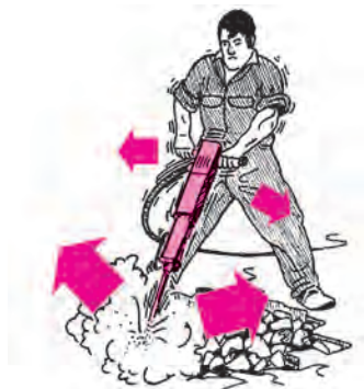
شکل ۳- عوارض ناشی از ارتعاش
