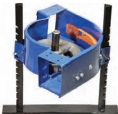
مخزن دان (هاپر) و الکتروموتور
