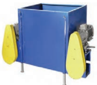
مخزن دان (هاپر) و الکتروموتور
