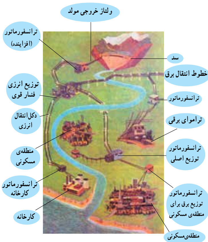
شکل ۴-۱- توزیع انرژی الکتریکی تولید شده به وسیله سد
