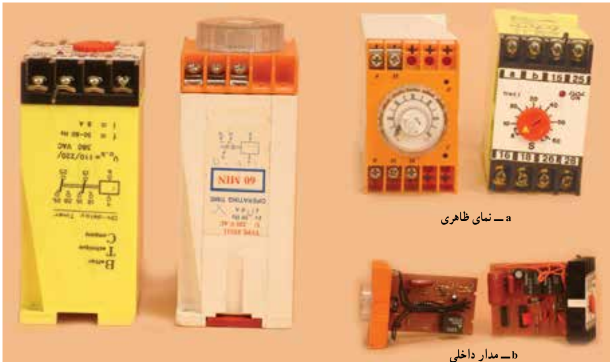
شکل ۸-۲۳- نمای ظاهری و مدار داخلی تایمر الکترونیکی
