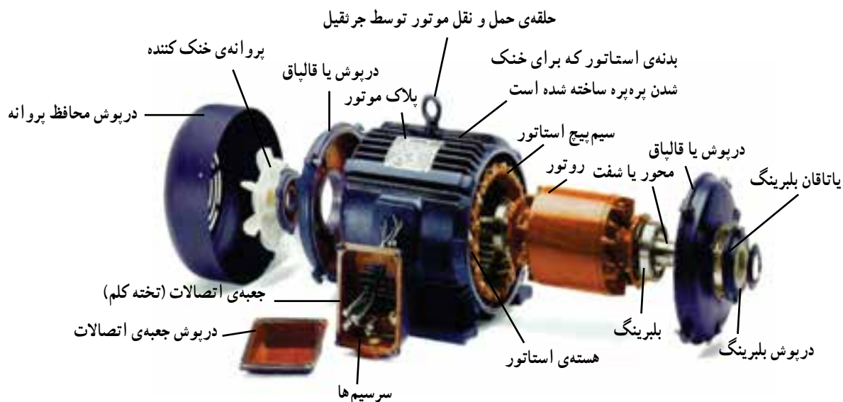
شکل ۷-۱۳- اجزای تشکیل دهنده یک موتور القایی با رتور قفس سنجابی
