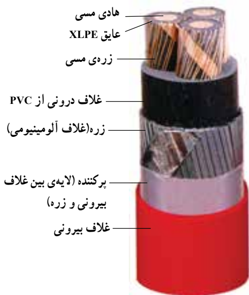
شکل ۴-۳۹- کابل با غلاف آلومینیومی
