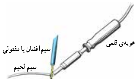
شکل ۲۹-۴- اصول صحیح قلع اندود کردن سرسیم
