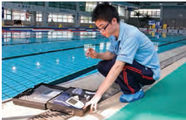
شکل ۶- نمونه برداری از آب استخر
