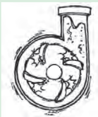
شکل ۲۹-۵. کاویتاسیون در پروانه پمپ
