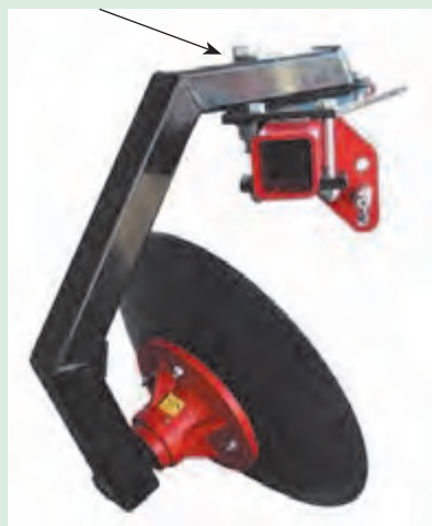
شکل ۴۱-۲. اتصال بشقاب به شاسی
