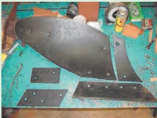
شکل ۲۰-۱. چیدمان اجزای باز شده خیش در کنار یکدیگر
