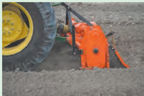
شکل ۴۸-۱. تاثیر درپوش بر خرد شدن خاک
