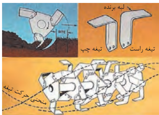
شکل ۱۵-۱. آرایش مارپیچ تیغه‌های گاواهن دوار
