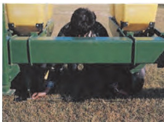
شکل ۲۵-۳. جابجایی ردیف‌های کاشت در ردیف کار
