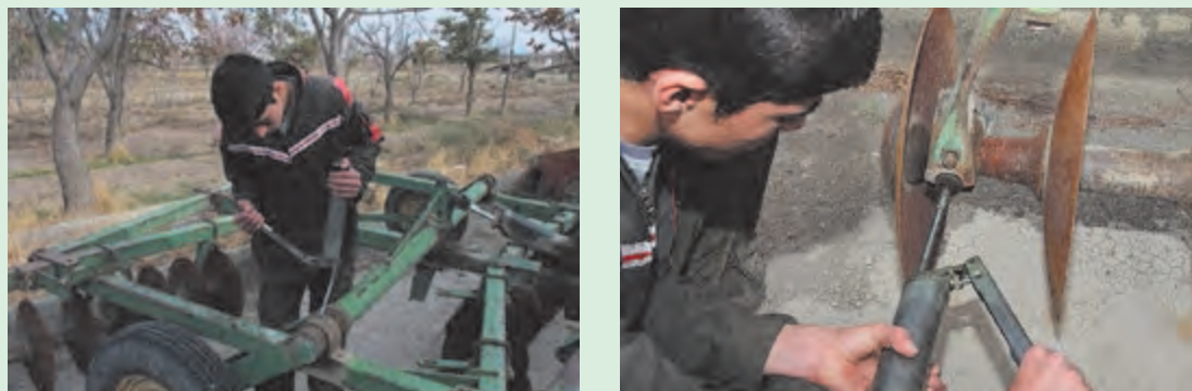
شکل ۱۶-۲. گریس کاری دیسک
