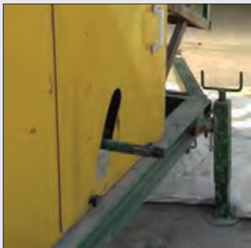
شکل ۳۸- پایه نگهدارنده ماشین بوجاری تراکتوری
