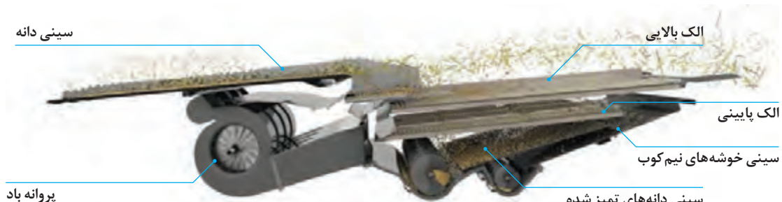
شکل ۲۵- مسیر حرکت محصول درو شده در واحد تمیز کننده
