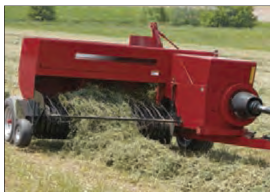
شکل ۷۱- واحد بردارنده بسته‌بند
