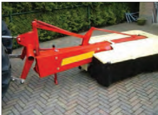
شکل ۲۹- دروگر در وضعیت حمل و نقل
