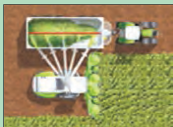
شکل ۶۰- کنترل اتوماتیک لوله تخلیه در چا پرهای جدید
