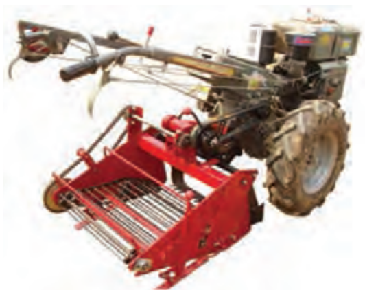
شکل ۷- سیب‌زمینی‌کن نقاله‌ای مخصوص تراکتور دو چرخ
