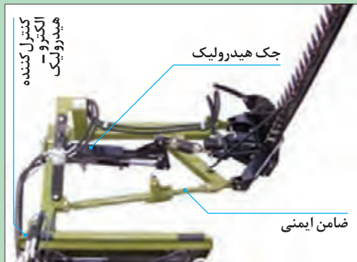
شکل ۱۷- دروگر شانه‌ای با سیستم محرک ارتعاشی
