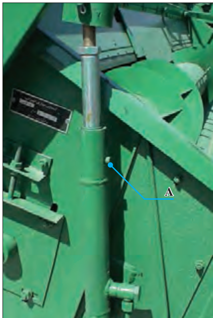
شکل ۴۲- جک هیدرولیک تنظیم ارتفاع چرخ و فلک
