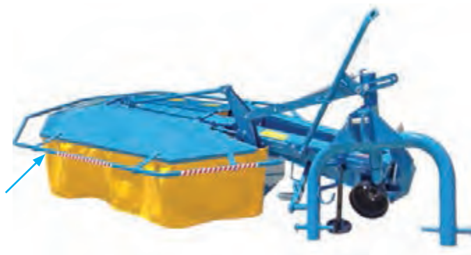
شکل ۶- حفاظ ایمنی دروگر استوانه‌ای
