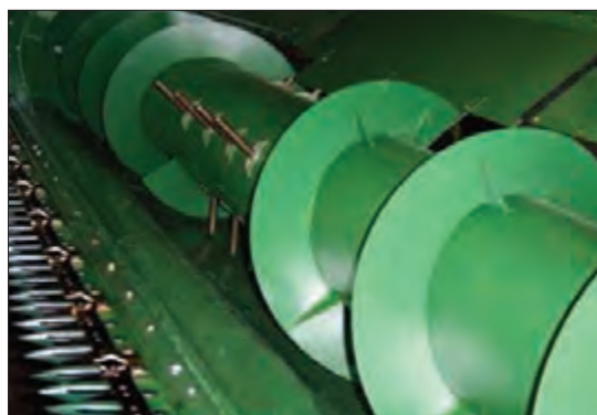
شکل ۸- نقاله پیچی واحد برش
