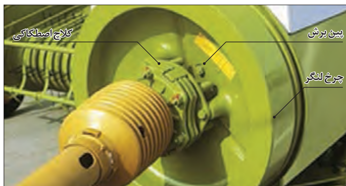
شکل ۸۰- چرخ لنگر و کلاچ ایمنی
