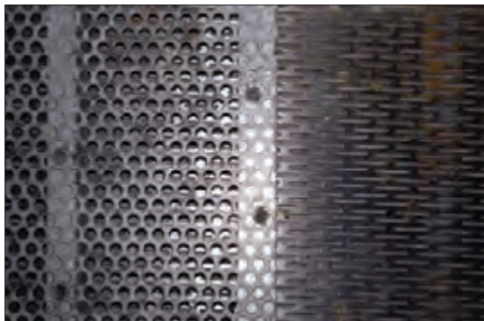
شکل ۳۱- دو نمونه غربال با سوراخ‌های متفاوت
