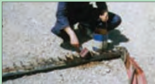
شکل ۵۰- تمیز کردن شانه برش با گازوئیل
