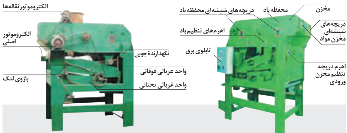
شکل ۱۸- ماشین بوجاری فاقد استوانه حفره‌دار از دو نما
