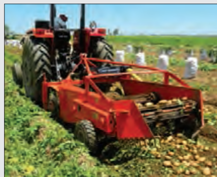
شکل ۱۷- برداشت سیب‌زمینی با سیب‌زمینی‌کن نقاله‌ای
