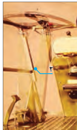
شکل ۳۶- نشانگر تنظیم ارتفاع برش
