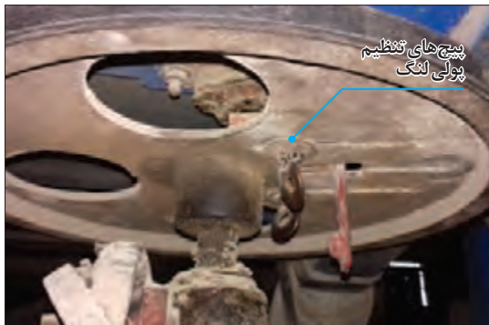
شکل ۳۴- پیچ تنظیم کورس غربال کابلی
