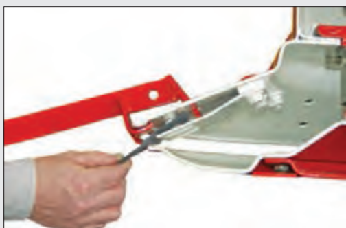
شکل ۲۲- شکل شماتیک از تعویض تیغه دروگر استوانه‌ای
