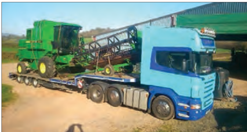
شکل ۳۳- حمل کمباین به وسیله یدک کش
