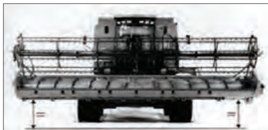
شکل ۳۷- اندازه‌گیری تراز بودن پلاتفرم
