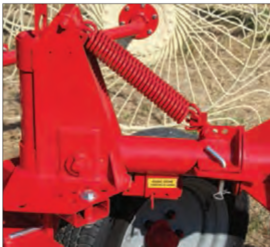
شکل ۶۰- فنرهای شناوری شانه خورشیدی
