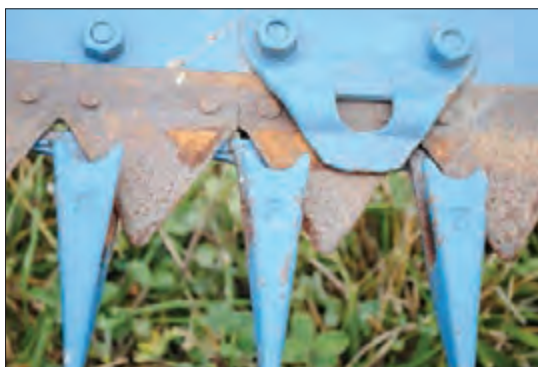
شکل ۱۰- موقعیت انگشتی و تیغه در دروگر شانه‌ای
