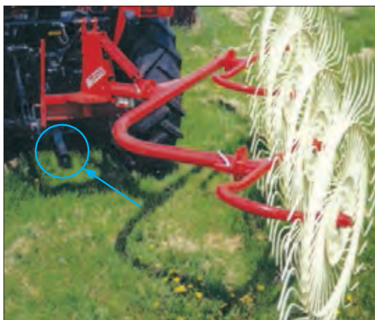
شکل ۵۹- اتصال شانه خورشیدی به تراکتور
