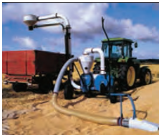
شکل ۲۹- نقاله بادی و طرز کار آن
