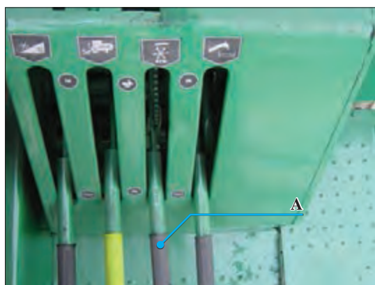
شکل ۳۹- اهرم تنظیم سرعت پروانه چرخ و فلک
