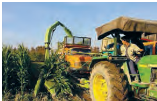
شکل ۳۲- تناسب لوله تخلیه با ماشین حمل
