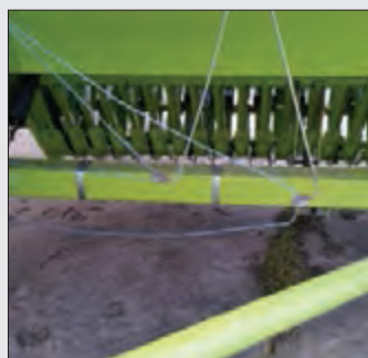
شکل ۹۱- مسیر نخ کردن بسته‌بند و جایگاه سوزن
