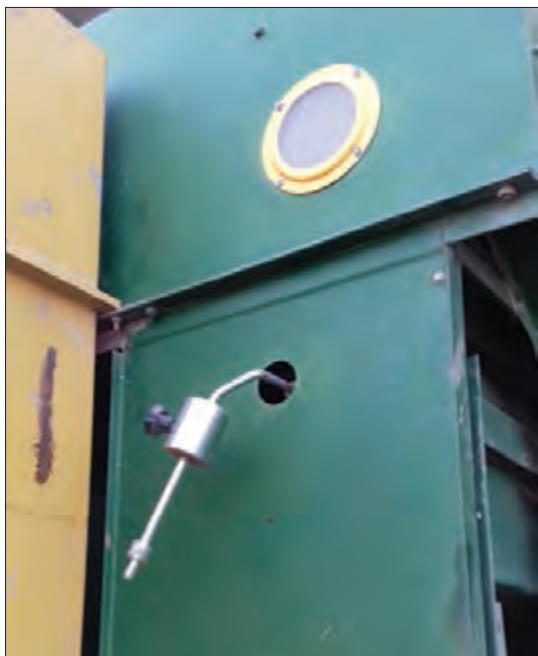
شکل ۳۳- وزنه تنظیم ضربه زن غربال بالایی
