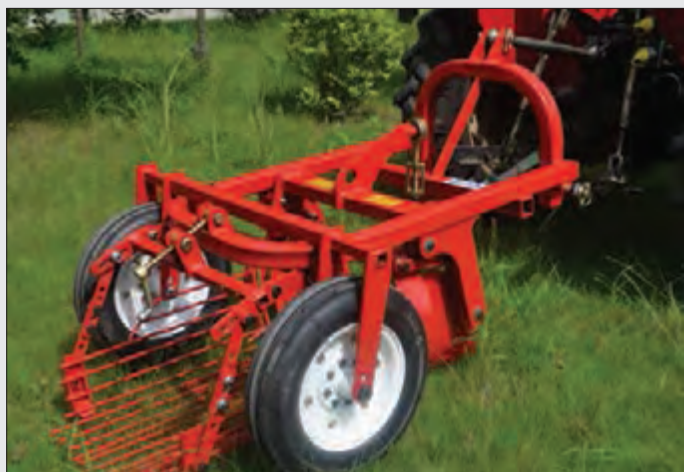
شکل ۱۳- اتصال سیب زمینی کن لرزان به تراکتور
