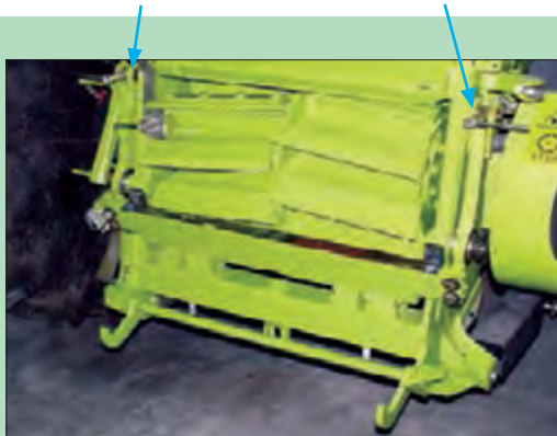
شکل ۲۸- اهرم‌های تنظیم تیغه ثابت در چاپر خودگردان
