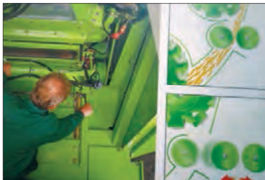
شکل ۲۱- خارج کردن بلال خردکن از مدار
