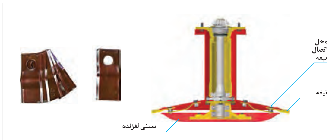
شکل ۴- تیغه و محل قرارگیری آن روی استوانه
