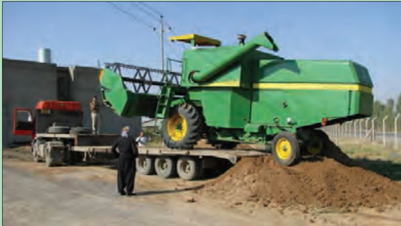
شکل ۳۵- نحوه قرار گرفتن کمباین روی یدک کش
