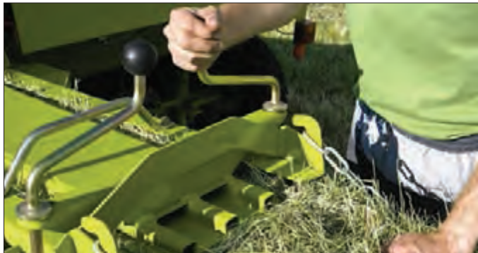
شکل ۱۰۱- تیرک‌های فشاردهنده و تنظیم آن
