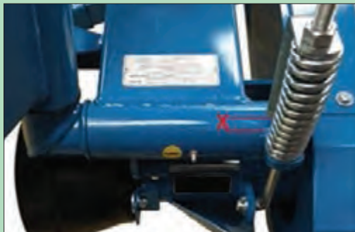
شکل ۲۱- شاخص تنظیم کشش تسمه دروگر استوانه‌ای
