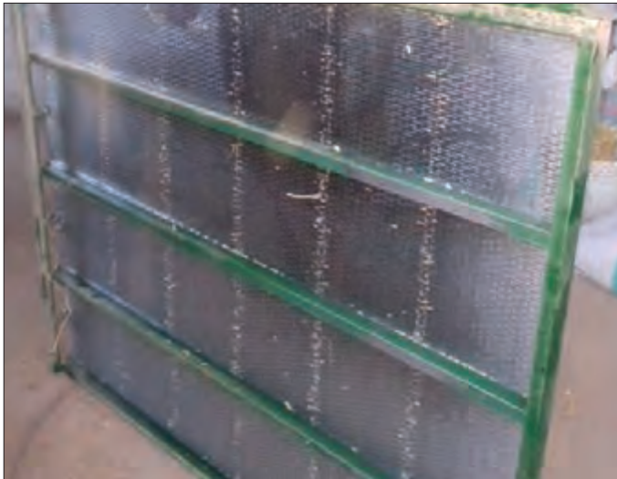
شکل ۳۹- قرار دادن غربال به صورت آویزان
