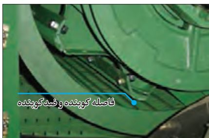
شکل ۴۳- تنظیم فاصله کوبنده
