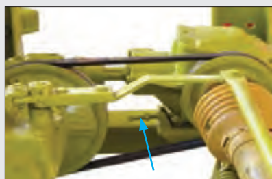
شکل ۵۰- پیچ تنظیم کشش تسمه
