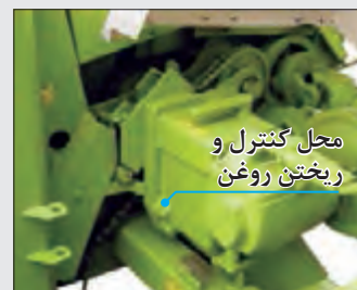
شکل ۴۵- جعبه دنده باردهی غلتک‌های تغذیه
