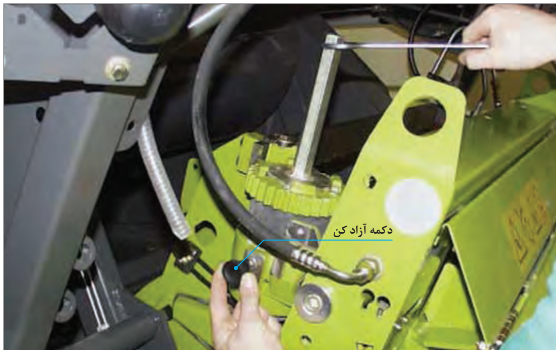
شکل ۶۴- کنترل دستی حرکت عمودی سنگ سنباده در چپر خودگردان
