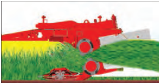
شکل ۵۶- دروساقه کوب و طرز کار آن
