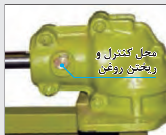
شکل ۴۶- جعبه دنده زانویی تیغه درو
