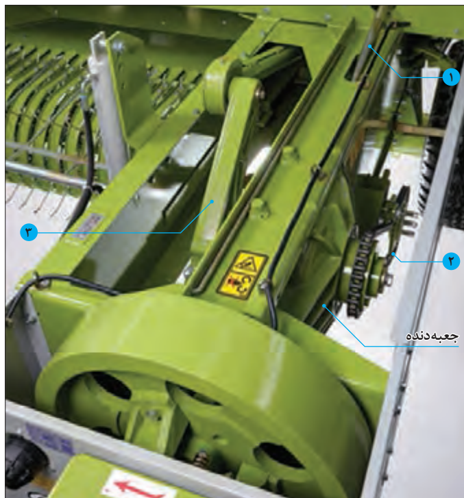
شکل ۸۲- مسیر انتقال توان در بسته‌بند
