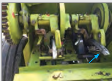
شکل ۹۳- تحویل نخ به نخ‌گیر
