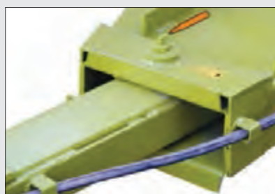
شکل ۴۹- گریس خورهایی که باید بعد از ۵۰ ساعت کار گریس کاری شوند.
