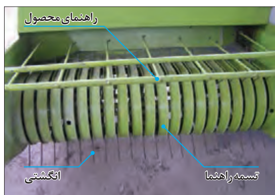
شکل ۷۲- اجزای واحد بردارنده بسته‌بند
