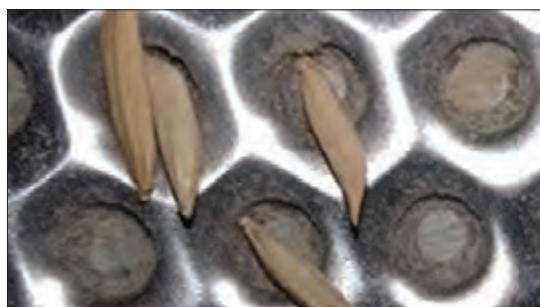
شکل ۱۶- قرار گرفتن دانه‌ها در سوراخ‌های استوانه حفره‌دار
