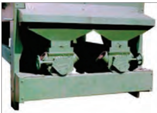
شکل ۳۶- تنظیم کننده‌های استوانه حفره‌دار
