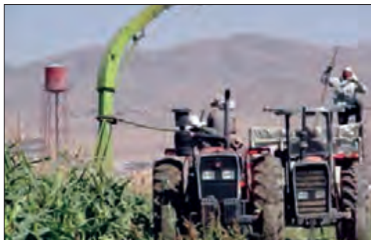
شکل ۳۲- تناسب لوله تخلیه با ماشین حمل
