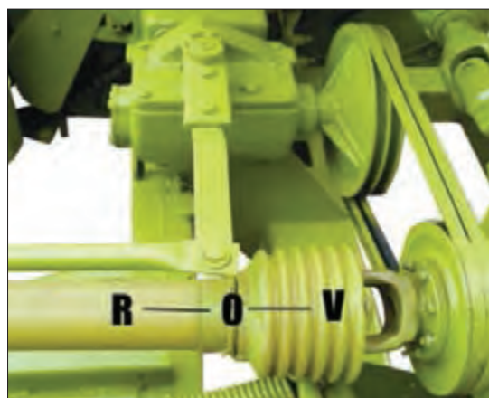
شکل ۱۸- تنظیم جهت دوران غلتک‌های تغذیه
