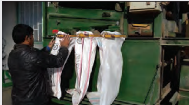
شکل ۳۷- نصب کیسه‌های بارگیری روی کیسه‌بندها
