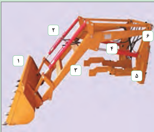
شکل ۶۵-۱- اجزای بیل تراکتوری
