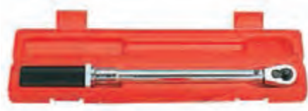
شکل ۱۲-۲- محافظت از ترک متر
