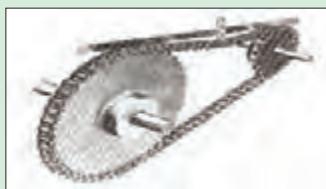
شکل ۲۶-۲- اندازه‌گیری کشش زنجیر
