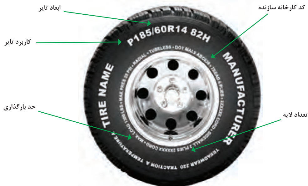
شکل ۴-۶۰- مشخصات فنی و ظاهری تایر
