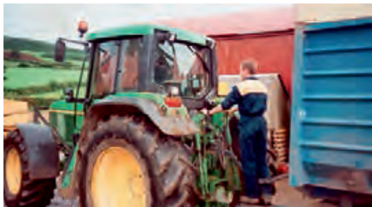
شکل ۵۲-۱- خطر ایستادن روی مالبند پی نورد و تراکتور
