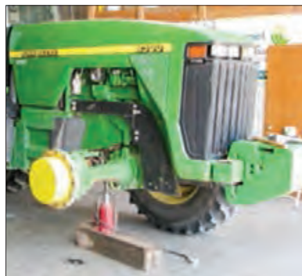
شکل ۴-۶۹- جک زدن زیر تراکتور
