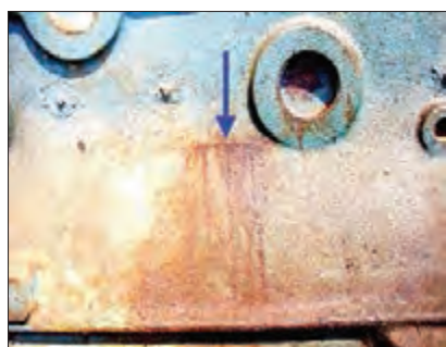
شکل ۳۰-۳ ترکیدن بلوک سیلندر در اثر سرما
