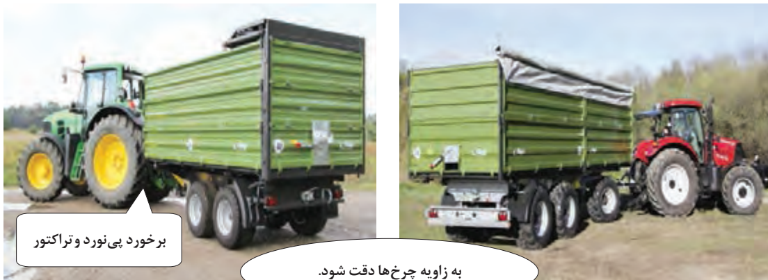
شکل ۴۷-۱ تراکتور متصل به پی نورد در حین تغییر جهت
