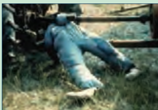
شکل ۳۷-۱- سرعت دوران گاردان بیشتر از سرعت عکس‌العمل شماست.
