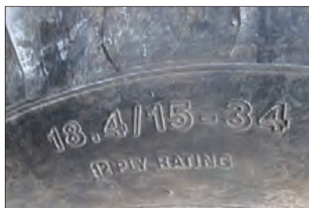
شکل ۴-۶۳- ابعاد تایر تراکتور
