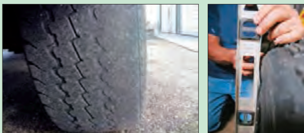
شکل ۴۱- تأثیر تنظیم نبودن زوایای چرخ جلو
