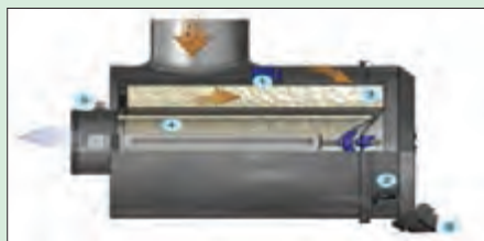
شکل ۹-۳- مسیر عبور هوا در صافی روغنی
