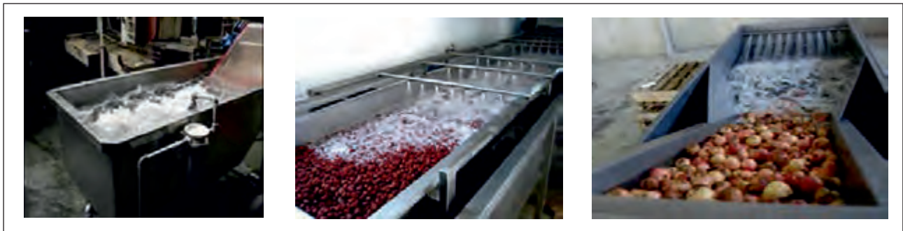
شکل ۱-۳۰- دستگاه شست و شوی میوه
