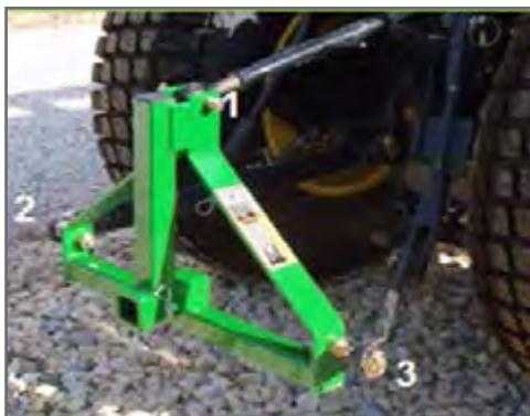
شکل ۸- نقاط اتصال سه‌گانه تراکتور
