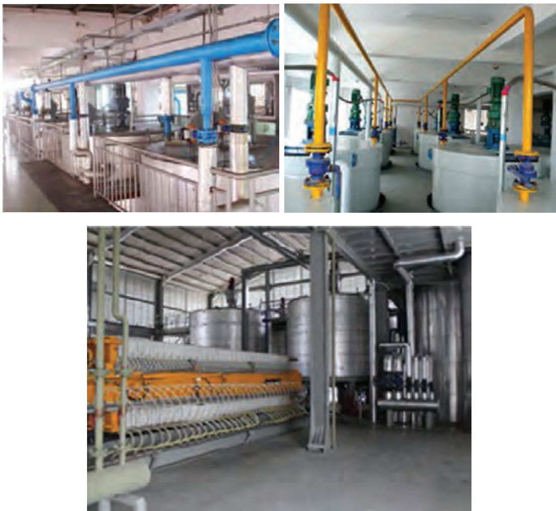
شکل ۱۰- سیستم تجهیزاتی جزء به جزء کردن روغن
