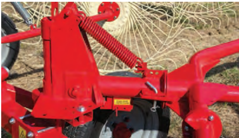
شکل ۱۵- مکانیزم شناوری شانه خورشیدی
