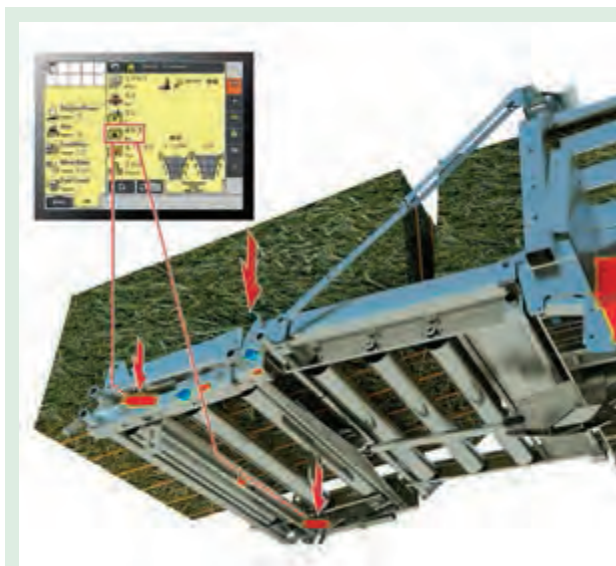
شکل ۴۹- کاربرد لودسل در بسته‌بند مکعبی
