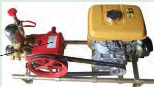
شکل ۶۱- پلاک مشخصات پمپ
