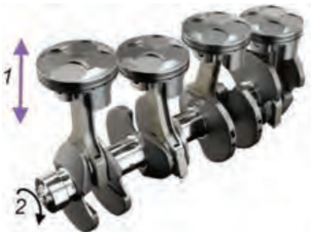
شکل ۱۹- کاربرد مکانیزم لنگ و لغزنده در موتور
