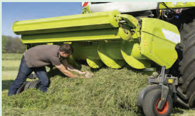
شکل ۲۹- کاربرد حسگر فلزیاب در یک نمونه ماشین خردکن علوفه
