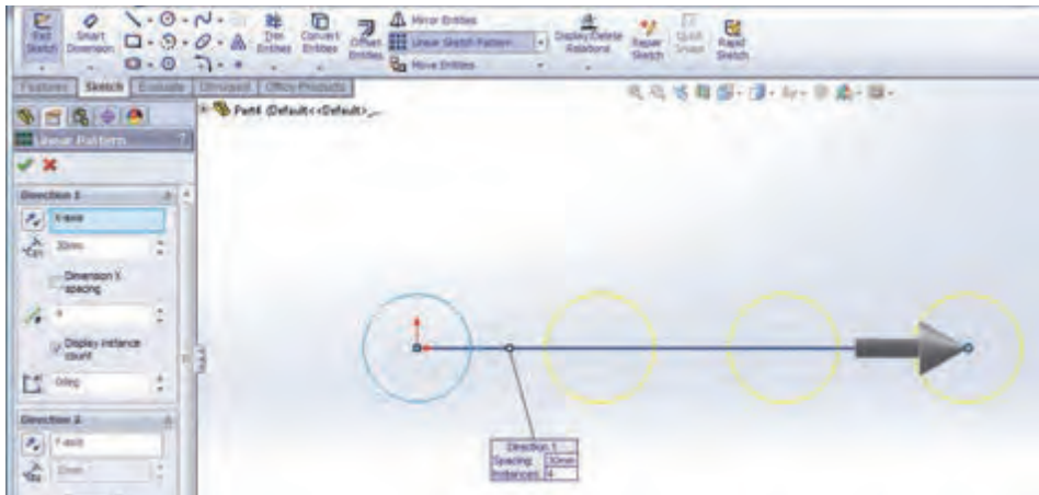
شکل ۲۵- دستور ویرایشی تکرار ترسیمات دو بعدی به صورت خطی
