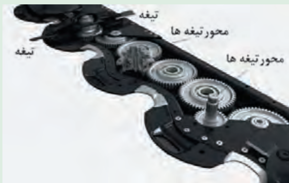
شکل ۵۱ - چرخ دنده‌های محرک تیغه‌ها در دروگر بشقابی
