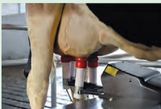
شکل ۵۵- اتصال مکندۀ ربات و آغاز فرایند شیردوشی
