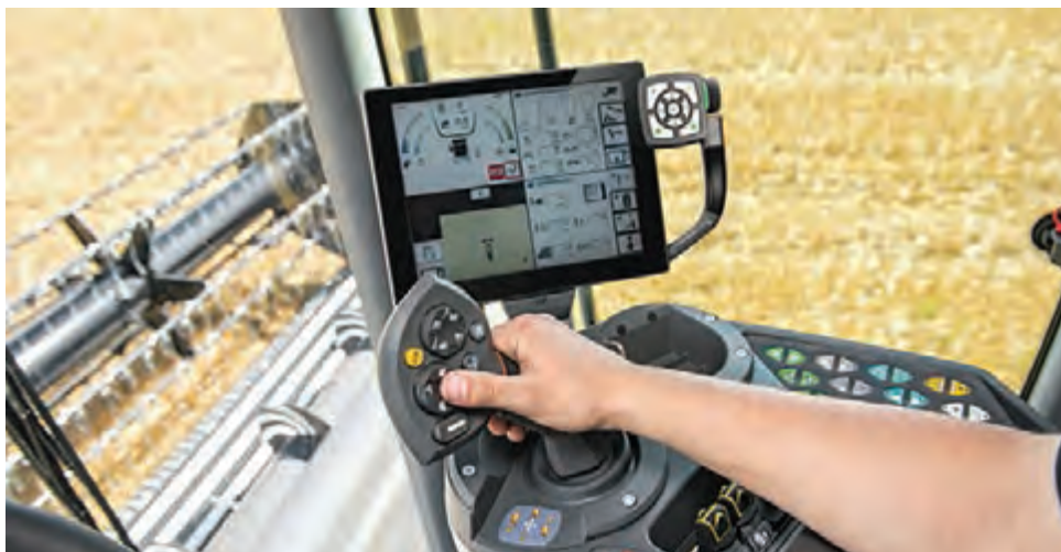
شکل ۱۵- نمونه‌ای از سامانه نظارت بر عملکرد کمباین
