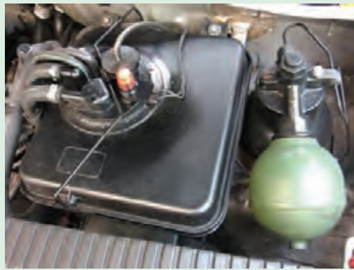
شکل ۳۶- آکومولاتور سیستم تعلیق اتومبیل زانتیا
