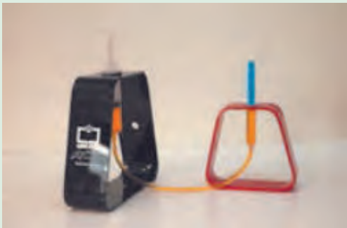
شکل ۱۰- آزمایش اصل تشدید نیرو
