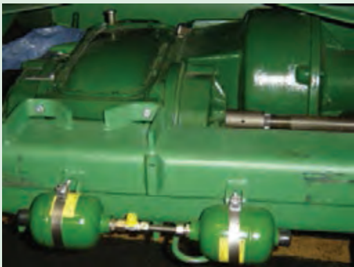
شکل ۳۷- آکومولاتور سیستم تعلیق هد کمباین جاندر ۱۰۵۵
