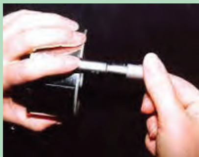
شکل ۱۹- اندازه‌گیری قلاب بدنه
