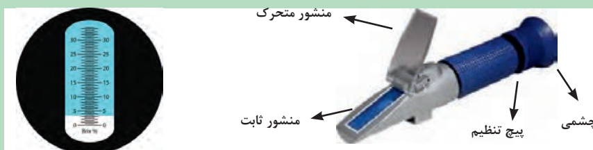
شکل ۱۱- نمایی از داخل دوربین
