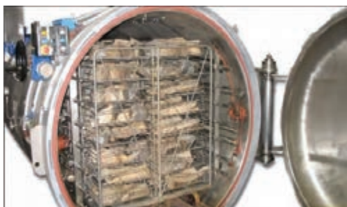
شکل ۹- ری تورت پخت مقدماتی ماهی
