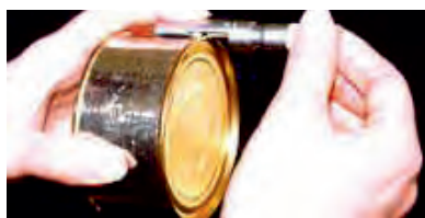
شکل ۳- اندازه‌گیری طول دوخت
