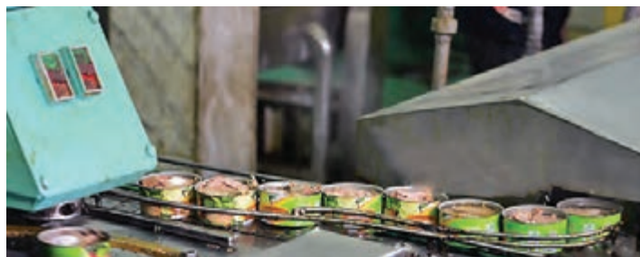
شکل ۲- ورود به تونل بخار
