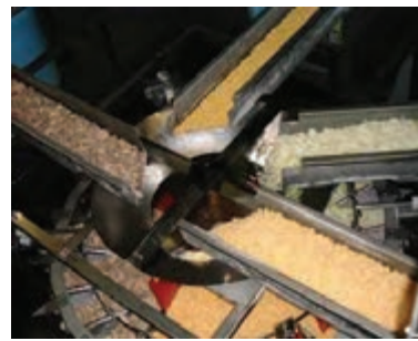
شکل ۵ - سیستم توزین چندگانه
