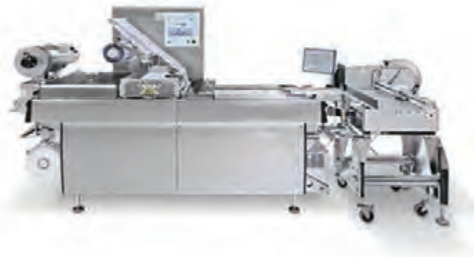
شکل ۱۶- دستگاه بسته‌بندی بیسکویت
