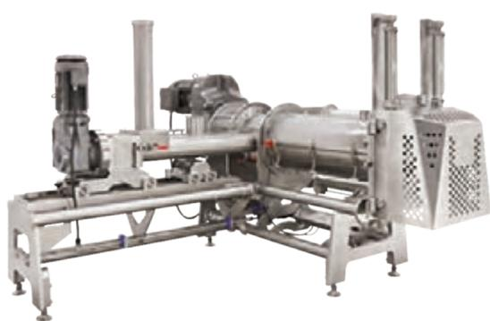
شکل ۳- مخلوطکردن بیسکویت به روش مداوم
