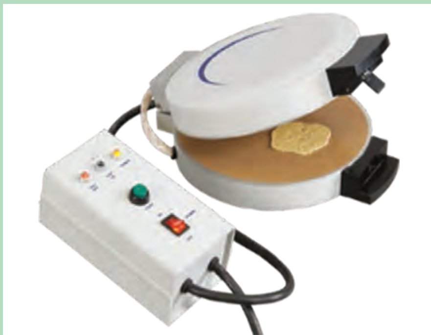
شکل ۵ - دستگاه پرس گلوتن
