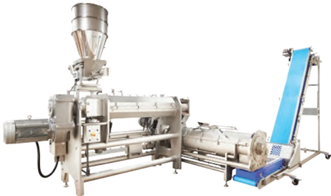
شکل ۷- مخلوط کردن به روش مداوم
