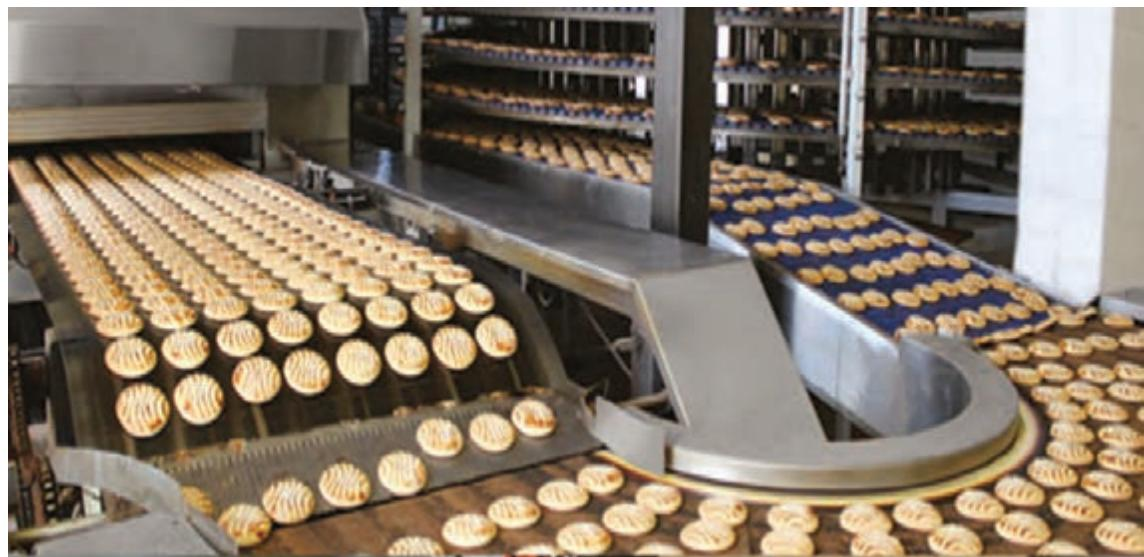
شکل ۶- انتقال کلوچه‌های پخته از فر تونلی به دستگاه خنک‌کننده
