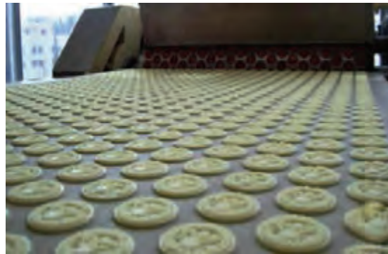
شکل ۷- قالب‌زنی بیسکویت با ماشین قالب‌زن دوار
