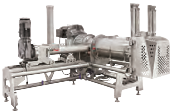
شکل ۳- مخلوط کردن بیسکویت به روش مداوم
