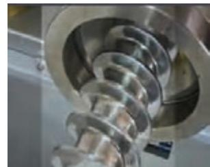
شکل ۱۰- مارپیچ اکسترودر
