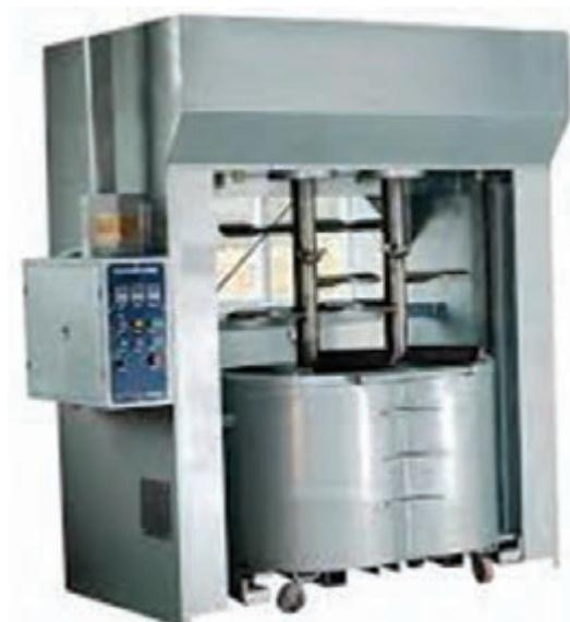
شکل ۱- مخلوط کن عمودی با مخزن قابل جدا شدن
