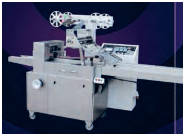
شکل ۷- دستگاه بسته‌بندی پیلوپک
