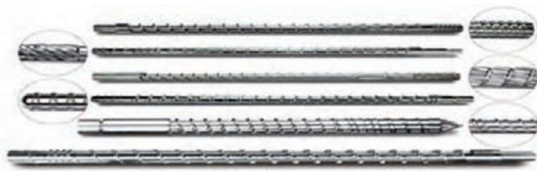
شکل ۱۱- انواع مارپیچ برای ورزیدن خمیر در اکسترودر
