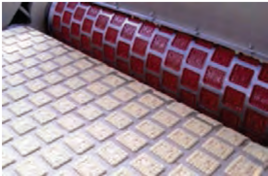
شکل ۷- قالب‌زنی بیسکویت با ماشین قالب‌زن دوار
