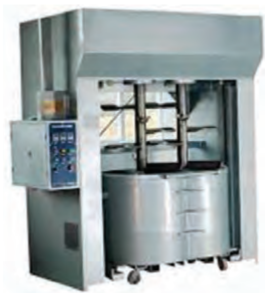
شکل ۱- مخلوط‌کن عمودی با مخزن قابل جدا شدن
