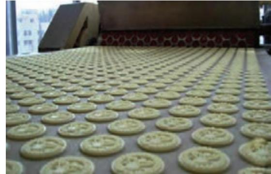
شکل ۷- قالب‌زنی بیسکویت با ماشین قالب‌زن دوار
