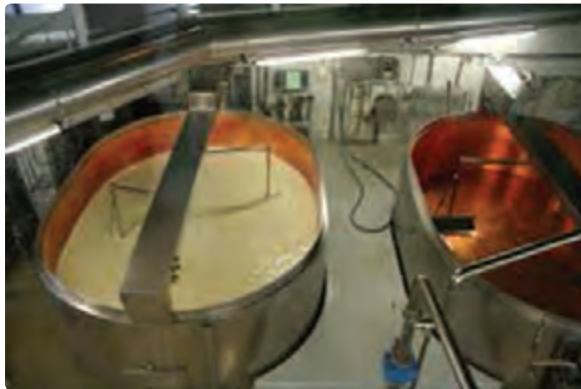
شکل ۳-۳- مخزن اختلاط بستنی
