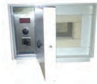
شکل ۲-۱۶- وسایل مورد استفاده برای آزمایش اندازه‌گیری خاکستر
