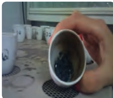
شکل ۲-۱۶- وسایل مورد استفاده برای آزمایش اندازه‌گیری خاکستر
