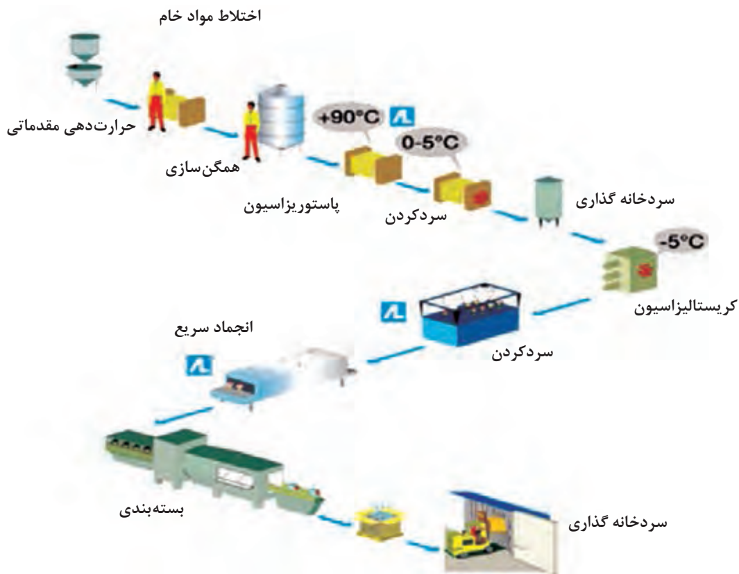
شکل ۳-۸ - فرایند تولید بستنی
