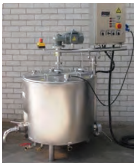
شکل ۱-۱۷- سیستم پاستوریزاسیون غیرمداوم
