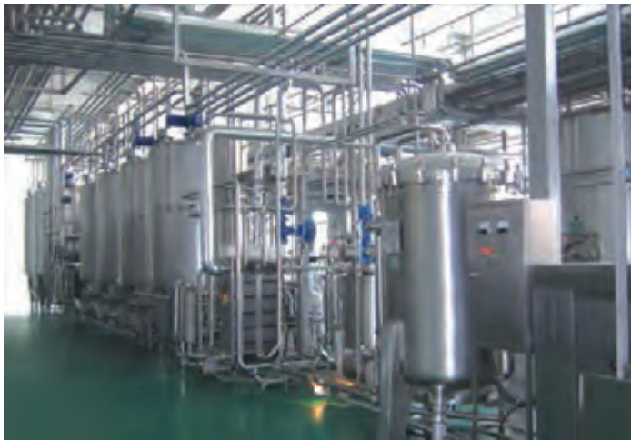
شکل ۱-۱۵- خط تولید شیر پاستوریزه
