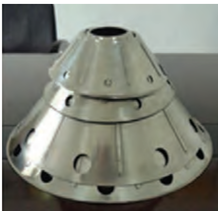
شکل ۵-۶- سپراتور و صفحات داخلی آن
