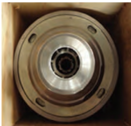
شکل ۵-۶- سپراتور و صفحات داخلی آن
