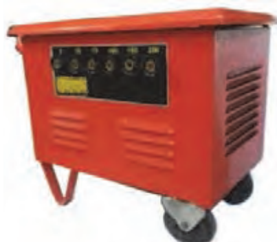
شکل ۸- ترانس با مکانیزم تغییر آمپر پله‌ای
