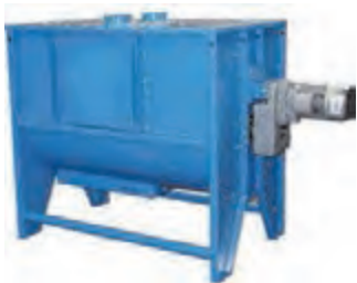
شکل ۸- مخلوط‌کن افقی و مارپیچ‌های آن
