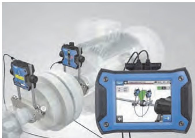
شکل ۷۸- هم‌راستا کردن محورها با دستگاه لیزر
