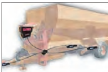
سیستم توزین و کنترل فیدر میکسر
