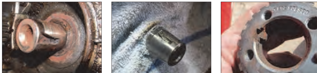
شکل ۸۱-نمونه‌ای از معایب مربوط به خارها
