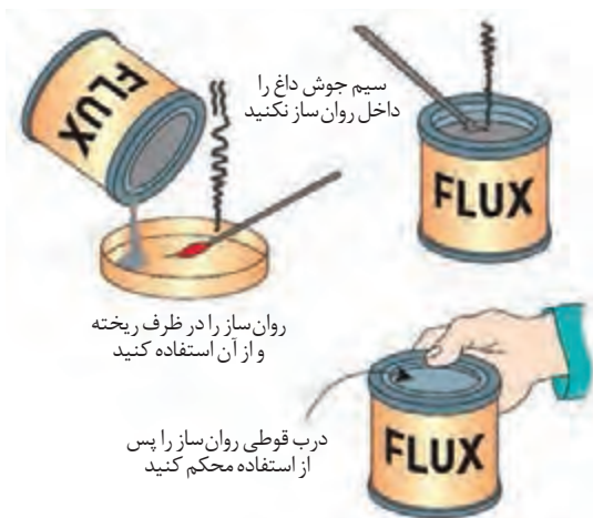
شکل ۲۸- روش استفاده از روان ساز
