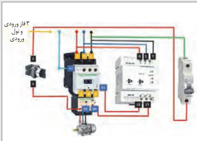
شکل ۳۳- مدار راه اندازی موتور سه فاز با حفاظت کامل و با استفاده از کلید ۱-۵
