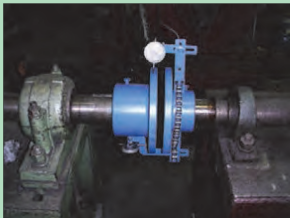
شکل ۷۷- هم‌راستا کردن محورها با ساعت اندازه‌گیری
