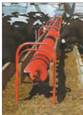
شکل ۲۲- توزیع خوراک به وسیله نقاله پیچی
