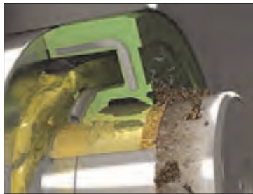
شکل ۶۸- کاسه نمد و نحوه عمل آن
