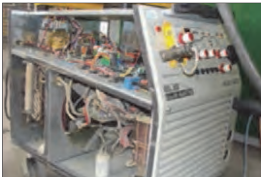
شکل ۱۱- ساختمان داخلی رکتیفایر
