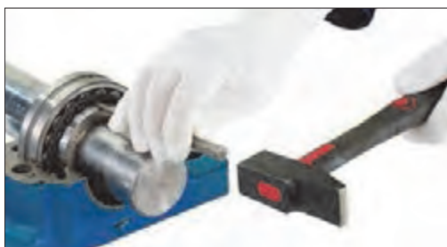
شکل ۶۲- جدا کردن بیرینگ از بوش مخروطی
