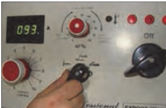
شکل ۱۲- کلیدهای مختلف برای تنظیم دستگاه جوشکاری
