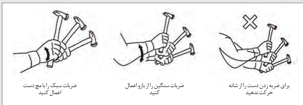
شکل ۵۰- روش ضربه زدن با چکش
