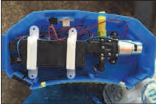
شکل ۳۱- اتصال باتری و پمپ سم پاش
