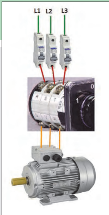
شکل ۲۷- نحوه کابل کشی و برق رسانی به یک موتور سه فاز آسنکرون با کلید زبانهای (۰-۱)
