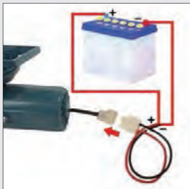
شکل ۴۲- اتصال پمپ با سوکت به باتری
