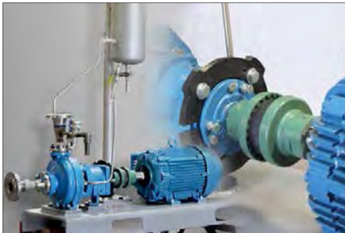
شکل ۸- انتقال قدرت مستقیم از موتور به دستگاه
