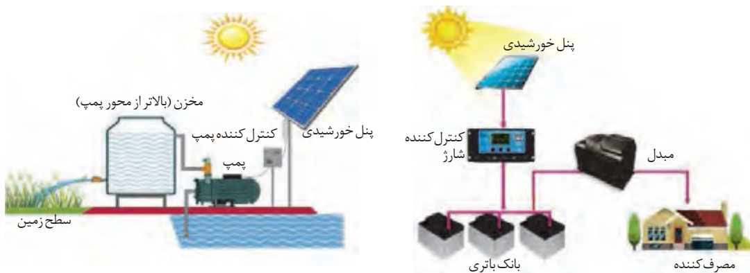
شکل ۱۰- سامانه مستقل از شبکه برق
