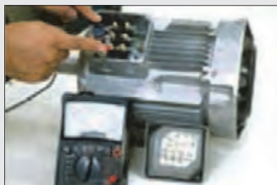
شکل ۶- آزمایش الکتروموتور با استفاده از مولتی‌متر
