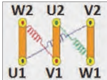
اجرای اتصال مثلث با بستن عمودی تیغه‌های مسی تخته کلم
