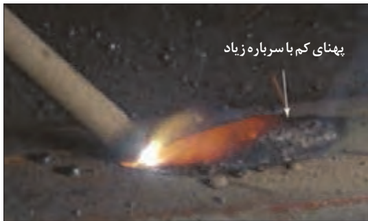
شکل ۳۰- جوشکاری با طول قوس بسیار کم
