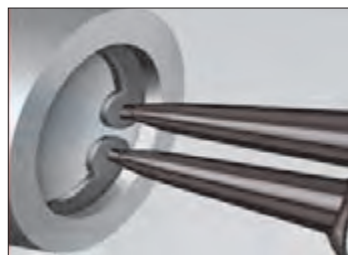
شکل ۸۲-در آوردن خار حلقوی با استفاده از خار جمع کن
