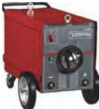
شکل ۹- ترانس با مکانیزم تغییر آمپر پیوسته
