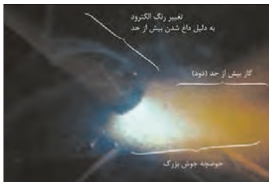
شکل ۲۷- جوشکاری با آمپر بسیار بالا
