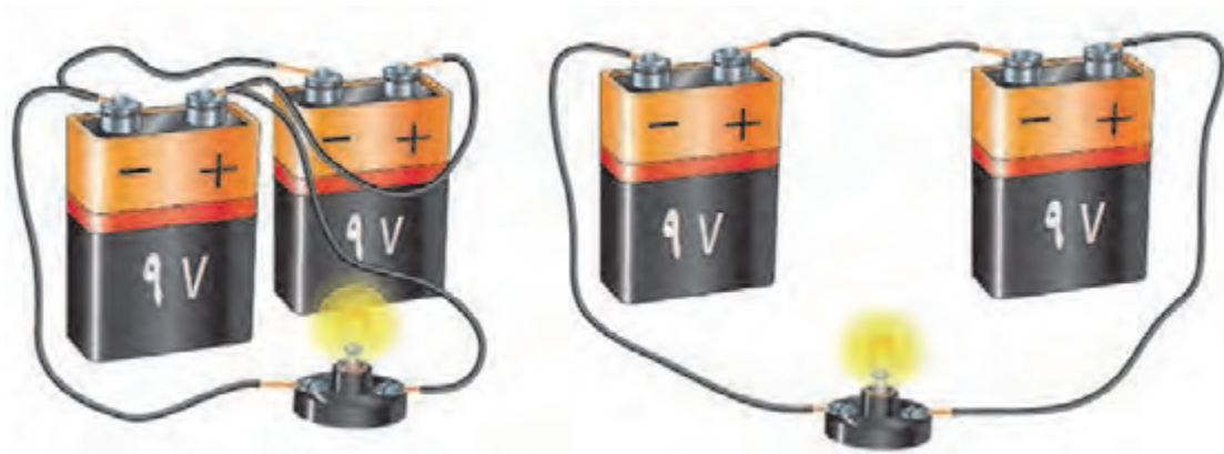
شکل ۱۵- اتصال سری و موازی پیل الکتریکی
