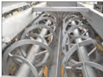
شکل ۸- مخلوط‌کن افقی و مارپیچ‌های آن
