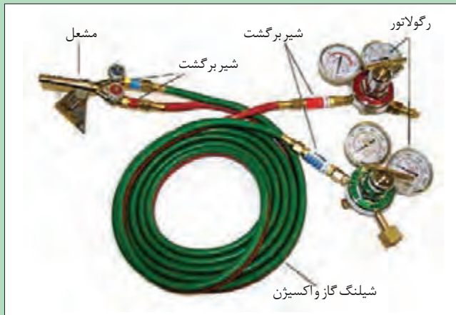
شکل ۱۸- محل نصب سوپاپ‌های یک طرفه (شیر برگشت)
