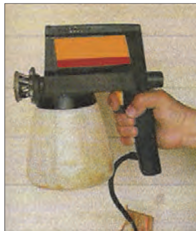
شکل ۶۱- پیستوله بدون کمک هوای فشرده (Airless)
