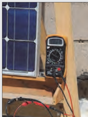
شکل ۲۲- اندازه‌گیری ولتاژ بی‌باری
