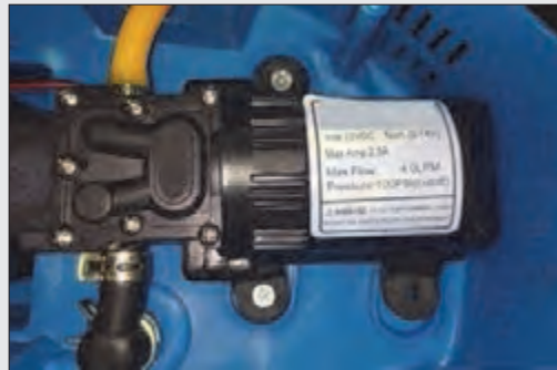
شکل ۳۲- اتصال پمپ و رعایت جهت حرکت سیال
