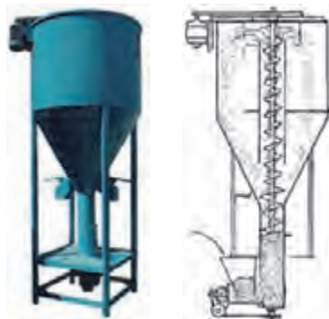
شکل ۷- مخلوط‌کن عمودی و نحوه عملکرد آن
