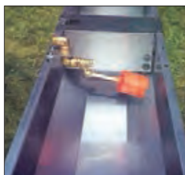
شکل ۲۵- آبشخور با سطح ثابت
