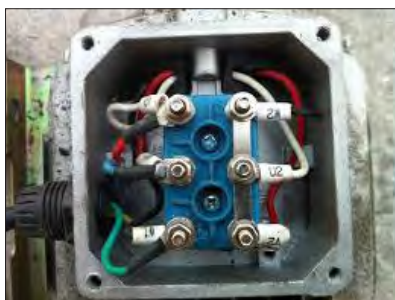
شکل ۳- پلاک اتصالات موتور الکتریکی
