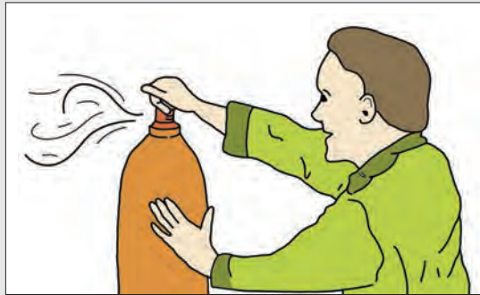
شکل ۱۳- روش تمیز کردن محل اتصال کپسول
