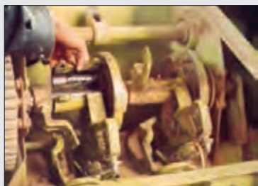
شکل ۴۶- برداشتن پوسته گره زن
