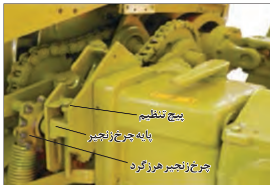
شکل ۷- زنجیر سفت کن با چرخ زنجیر واسطه
