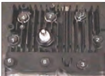
شکل ۳۴- ترتیب بستن پیچ‌های سرسیلندر
