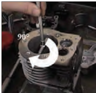
شکل ۲۸- کنترل دو پهنی سیلندر
