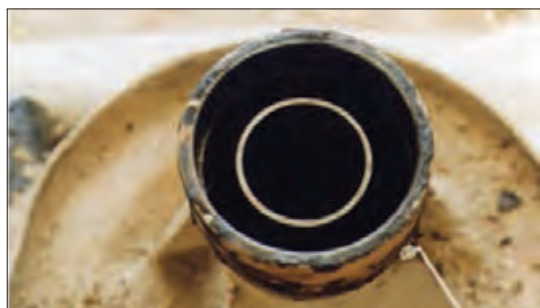
شکل ۴۳- ساییدگی جای بلبرینگ
