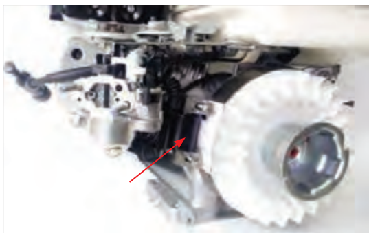
شکل ۳۶- تنظیم فاصله بین کوپل جرقه‌زنی و فلاپیول
