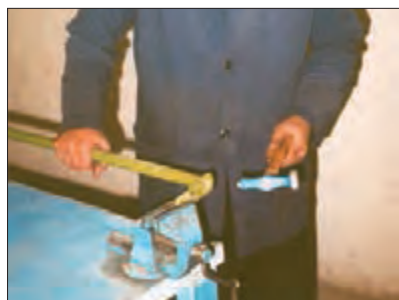
شکل ۱۵- صاف کردن پایه بلبرینگ
