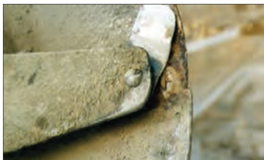
شکل ۴۲- خوردگی لبه استوانه
