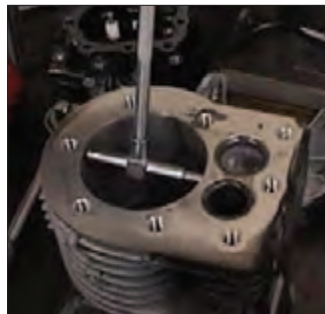
شکل ۲۸- کنترل دو پهنی سیلندر
