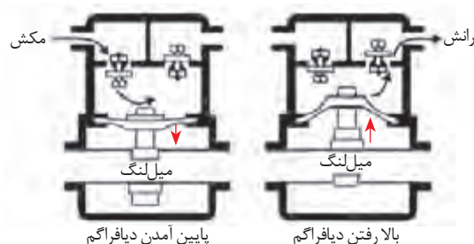
شکل ۴۱- طرز کار پمپ دیافراگمی
