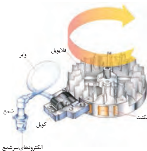
شکل ۷- طرز کار سیستم جرقه‌زنی
