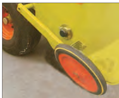
شکل ۲۸- چرخ تنظیم کج شده
