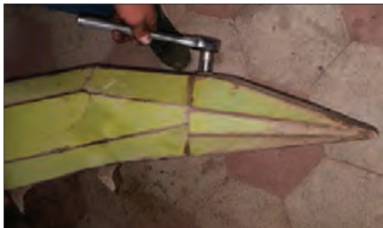
شکل ۲۲- تعویض کلگی دماغه
