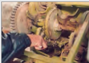
شکل ۴۴- باز کردن کفشک گره زن
