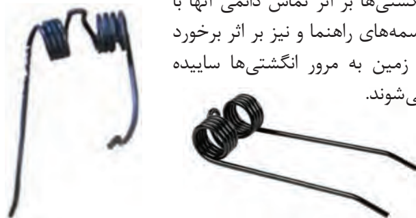
شکل ۴- تفاوت انگشتی سالم و انگشتی معیوب
