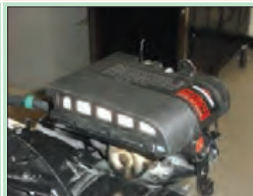
۴- در پوش فیلتر هوا را باز کنید.
