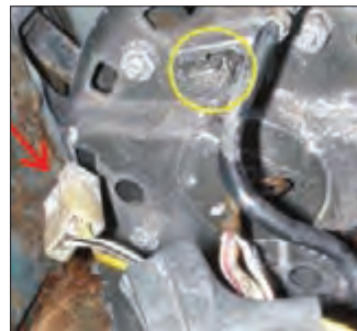
شکل ۲۶- جدا کردن کاتچویی سیم‌کشی لامپ شارژ
