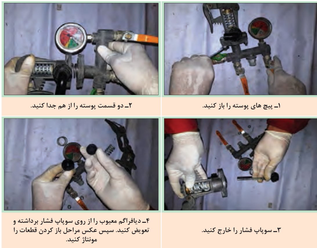
شکل ۵۲- تعویض دیافراگم رگولاتور مدل کمت
