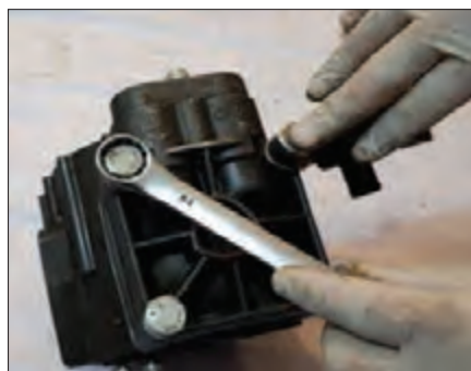
شکل ۴۵- باز کردن درپوش
