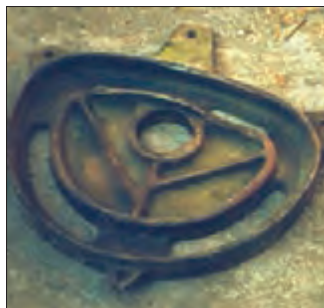
شکل ۱۸- صفحه بادامکی معیوب
