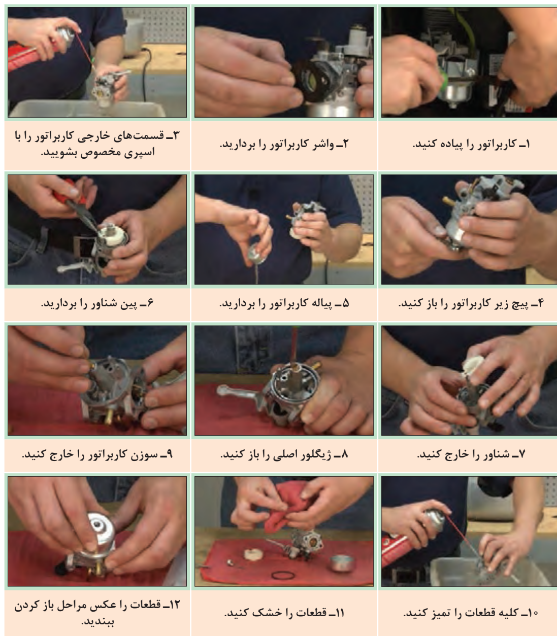
شکل ۲۵- باز کردن و تمیز کردن قطعات کاربراتور
