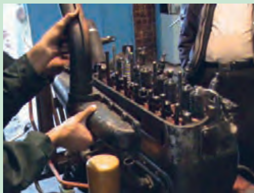
شکل ۴۳. باز کردن مانیفولد تراکتور U650
