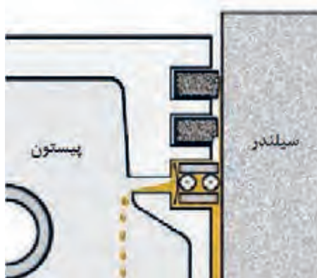
شکل ۱۲. بازگرداندن روغن اضافه توسط رینگ روغن
