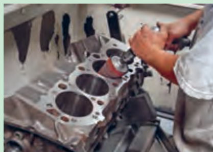
شکل ۳۹. ترمیم لبه بالای سیلندر
