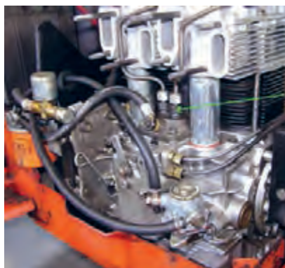
شکل ۲۷. پمپ انژکتور واحدی و موقعیت آن روی تراکتور باغی با موتور لمباردینی
