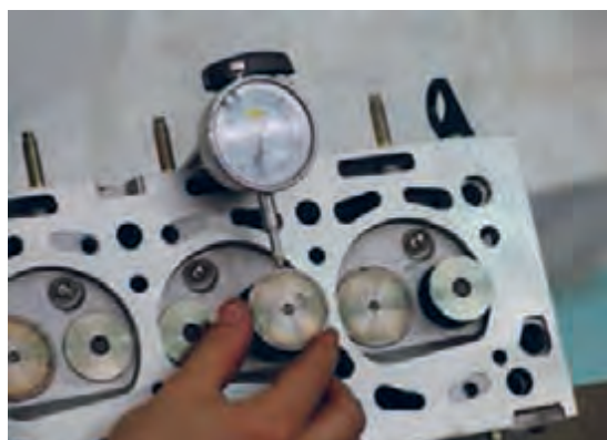
شکل ۷۳. روش کنترل لقی بین سوپاپ و گیت
