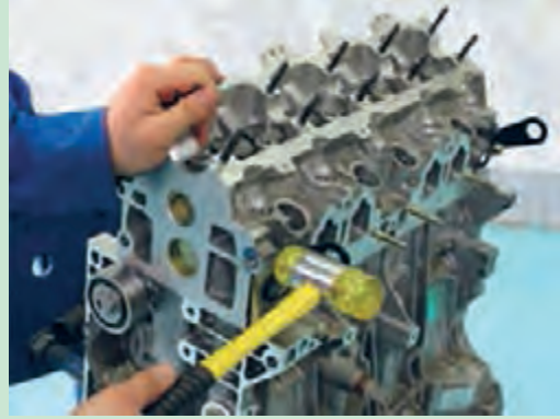
شکل ۴۹. آزاد کردن چسبیدگی سر سیلندر
