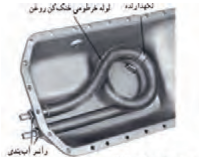
الف- عبور لوله مایع خنک‌کننده از کارتر ب- عبور مایع خنک‌کننده از پایه فیلتر JD314 ج- رادیاتور روغن U650 شکل ۴۶. انواع خنک‌کن روغن رایج در تراکتورها
