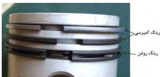
شکل ۹. ترتیب قرار گرفتن رینگ ها و موقعیت شیاری عرضی پیستون زیر ناحیه قرار گرفتن رینگ روغنی
