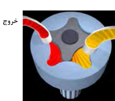
شکل ۴۳. پمپ روغن روتوری
