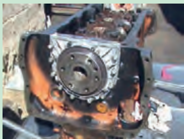
شکل ۹۸. جا زدن و بستن کاسه نمد ته میل لنگ
