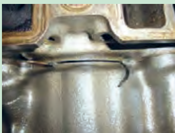
شکل ۶۲. ترک در سیلندر و بلوکه سیلندر
