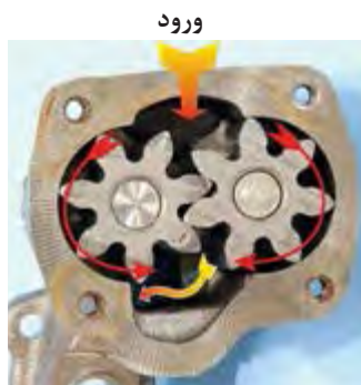
شکل ۴۲. پمپ روغن دنده ای
