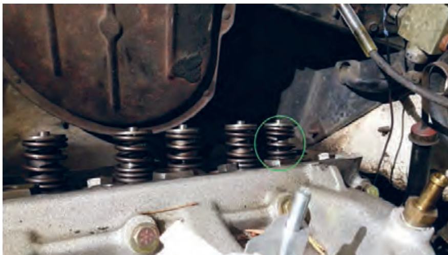
شکل ۷۱. شکستن فنر سوپاپ
