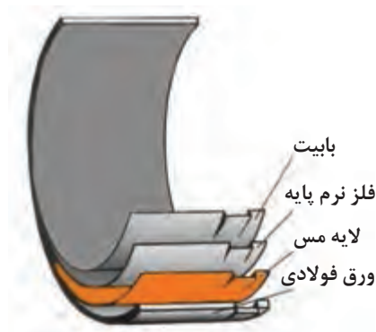
شکل ۱۹. انواع لایه بندی یاتاقان
