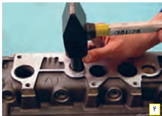
شکل ۶۹. روش تعویض پولک سر سیلندر
