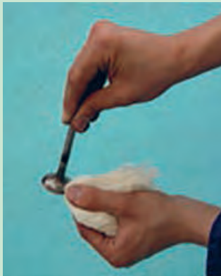
شکل ۸۰. تمیز کردن سوپاپ
