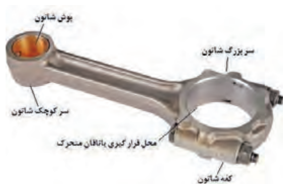
شکل ۱۳. اجزاء شاتون
