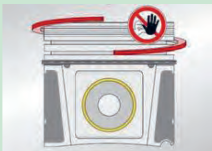
شکل ۵۳. خارج کردن رینگ بدون رینگ بازکن
