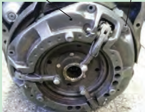
شکل ۲۵. جدا کردن مجموعه کلاچ از فلاپیول
