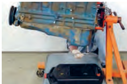
شکل ۳۳. موتور نصب شده روی استند
