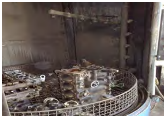
شکل ۶۱. شستشوی موتور به وسیله دستگاه شات بلاست
