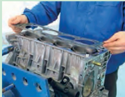
شکل ۵۰. برداشتن و اثر سر سیلندر
