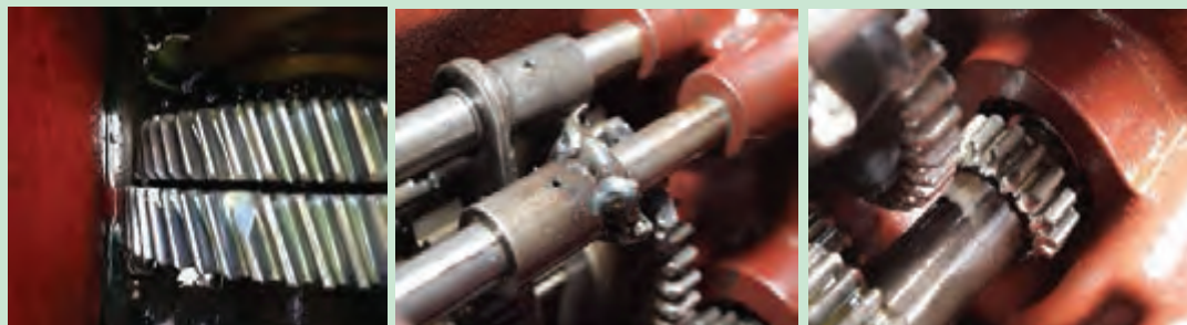
شکل ۴۰. برخی ایرادات قطعات جعبه دنده
