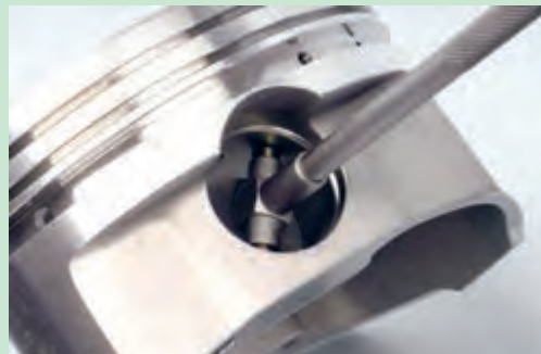
شکل ۸۱. اندازه گیری لقی گزن بین در پیستون
