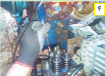
شکل ۳۷. فیلرگیری موتور تراکتور دوچرخ
