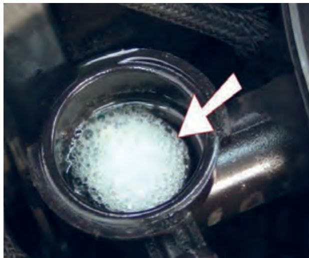
شکل ۳۳. خروج حباب از رادیاتور
