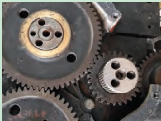
شکل ۱۰۹. علامت‌های تایمینگ روی چرخ دنده‌ها
