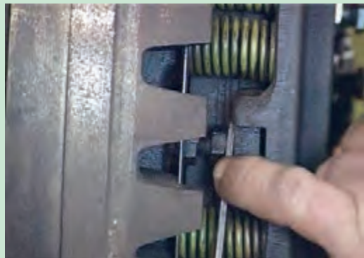
شکل ۳۹. تنظیم کلاچ محور تواندهی
