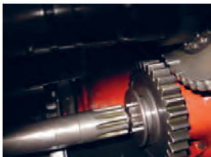
شکل ۲۰. محور تواندهی در حالت خلاص
