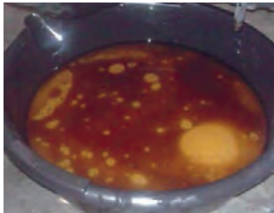
شکل ۳۴. مخلوط شدن آب و روغن در رادیاتور و کارتر
