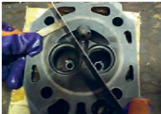
شکل ۶۵. کنترل تابیدگی سرسیلندر تراکتور دوچرخ
