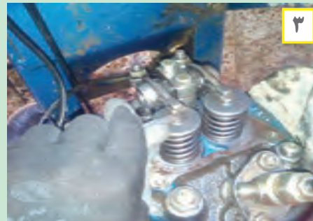
شکل ۳۷. فیلرگیری موتور تراکتور دوچرخ
