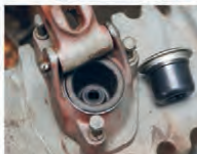
شکل ۶. مکانیزم کارانداز ترمز تراکتور MF۲۸۵
