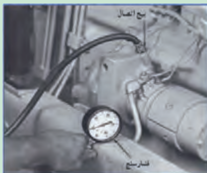
شکل ۵۰. فشار سنجی مدار روغن کاری
