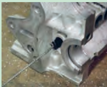
شکل ۵۹. تمیز کردن مجاری آب و روغن
