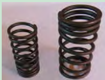
شکل ۱۸. فنرهای سوپاپ در تراکتور MF۲۸۵
