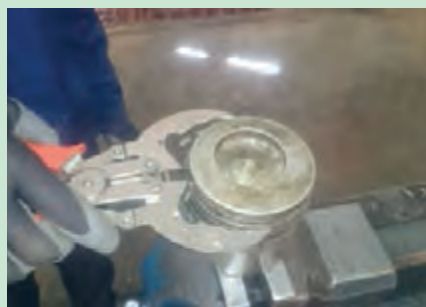
شکل ۵۲. نحوه خارج کردن رینگ از روی پیستون
