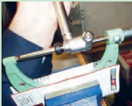
شکل ۷۶. اندازه‌گیری قطر سیلندر با میکرومتر داخلی
