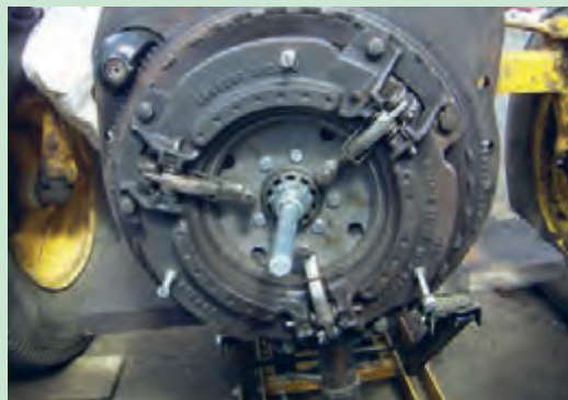
شکل ۳۷. سوار کردن مجموعه کلاچ روی فلاپیول
