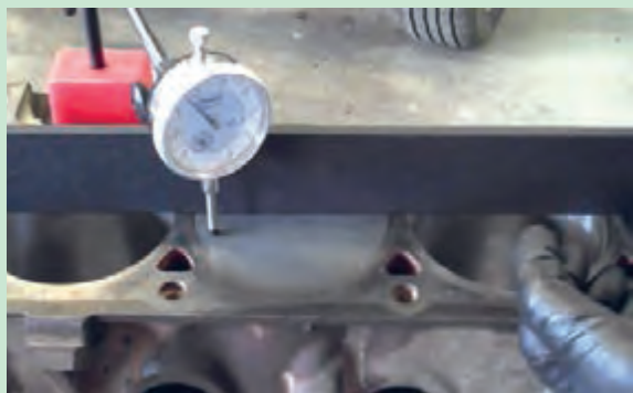
شکل ۱۰۳. کنترل سطح پیستون نسبت به سطح بلوکه سیلندر با فیلر و ساعت اندازه گیری
