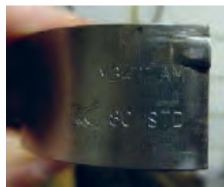
شکل ۲۳. تغییر ضخامت یاتاقان در سایزهای مختلف
