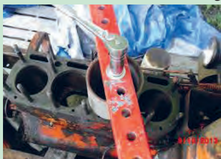
شکل ۹۰. جا زدن بوش با ابزار
