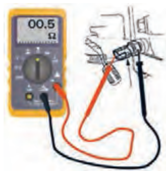
شکل ۴۹. کنترل فشنگی روغن
