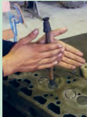
شکل ۷۹. چرخاندن سوپاپ به وسیله چوب سوپاپ گردان
