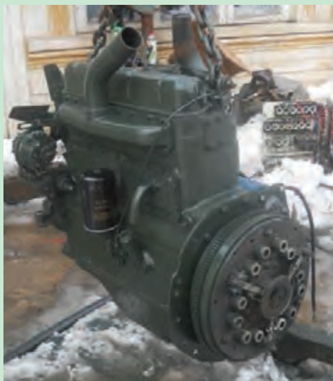
شکل ۲۴. پیاده کردن موتور تراکتور U650
