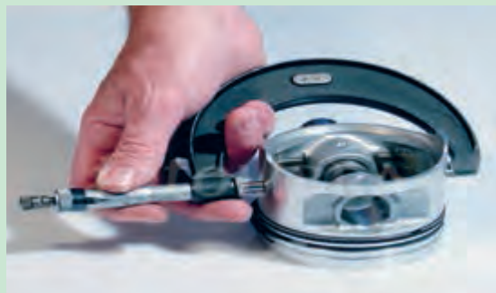
شکل ۷۵. اندازه‌گیری قطر پیستون با میکرو متر
