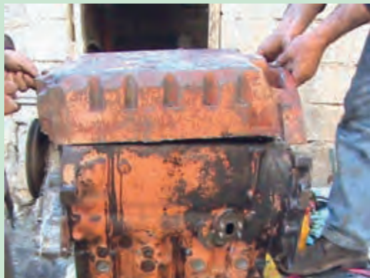
شکل ۱۱۵. نصب کارتر روی بلوکه سیلندر
