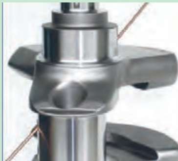
شکل ۶۰. تمیز کردن مجاری میل لنگ
