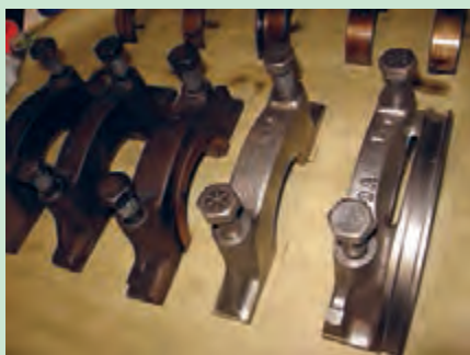
شکل ۴۸. برداشتن کپه های یاتاقان و چیدن آنها
