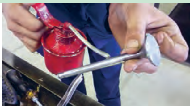
شکل ۸۴. روغن زدن به ساق سوپاپ جهت نصب بر روی سرسیلندر
