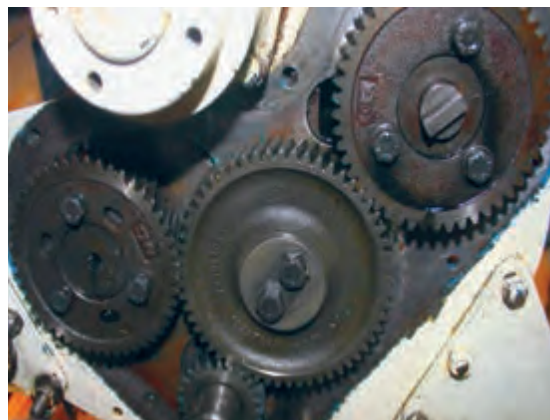
شکل ۲۷. چرخ دنده‌های تایمینگ در سینی جلو موتور
