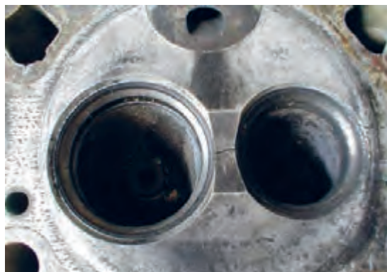
شکل ۶۶. ترک خوردگی سرسیلندر در محفظه احتراق
