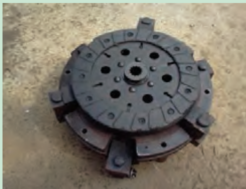
شکل ۲۵. جدا کردن مجموعه کلاچ از فلاپیول
