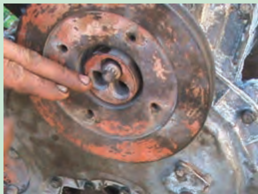
شکل ۱۱۳. پیچ‌های پولی سر میل لنگ
