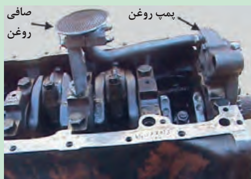
شکل ۳۸. پیاده کردن پمپ روغن
