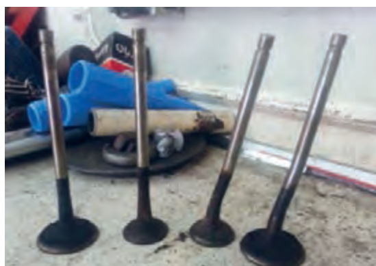
شکل ۶۷. کربن گرفتگی سرسیلندر و سوپاپ‌ها
