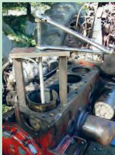
شکل ۵۵. خارج کردن بوش پیستون از بلوکه سیلندر با ابزار بوش کش
