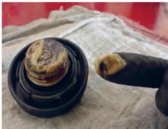
شکل ۳۴. مخلوط شدن آب و روغن در رادیاتور و کارتر
