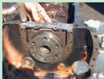
شکل ۹۷. جا زدن قطعه آب بندی کارتر
