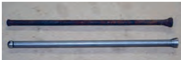
شکل ۷۶. زنگ زدن و شکستگی میل تپت
