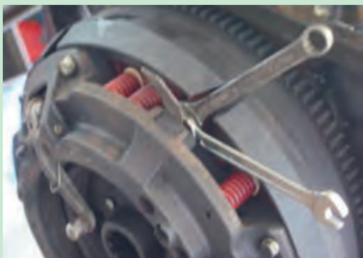
شکل ۳۹. تنظیم کلاچ محور تواندهی
