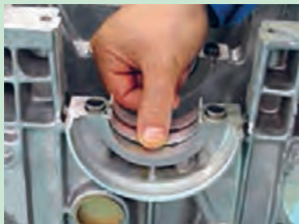
شکل ۵۰. برداشتن یاتاقان های ثابت و بغل یاتاقانی
