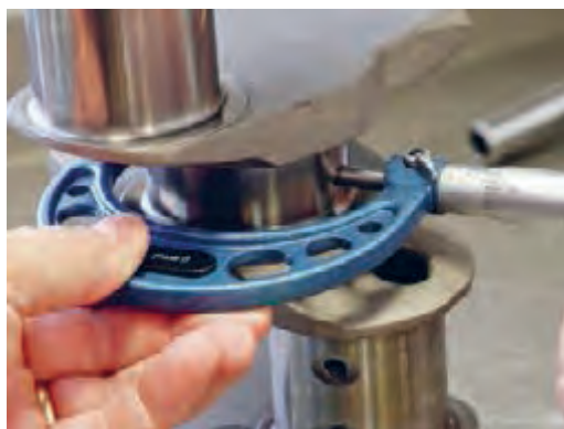
شکل ۷۱. اندازه گیری قطر میل لنگ
