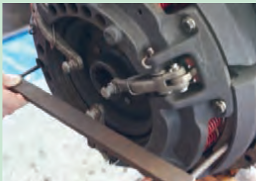
شکل ۳۸. تنظیم انگشتی‌های کلاچ
