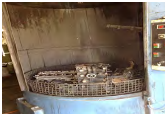
شکل ۶۱. شستشوی موتور به وسیله دستگاه شات بلاست
