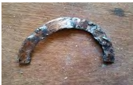
شکل ۷۳. نمونه بغل یاتاقانی معیوب
