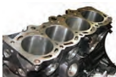
الف- سیلندر یکپارچه با بلوک سیلندر
