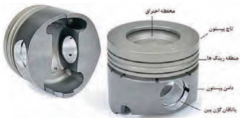
شکل ۶. پیستون و قسمت‌های مختلف آن
