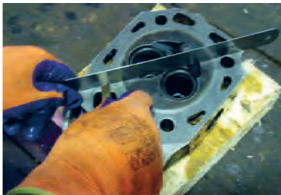
شکل ۶۵. کنترل تابیدگی سرسیلندر تراکتور دوچرخ
