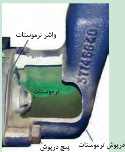
شکل ۱۷. نمای برش خورده ترموستات تراکتور MF۲۸۵
