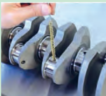
شکل ۶۰. تمیز کردن مجاری میل لنگ
