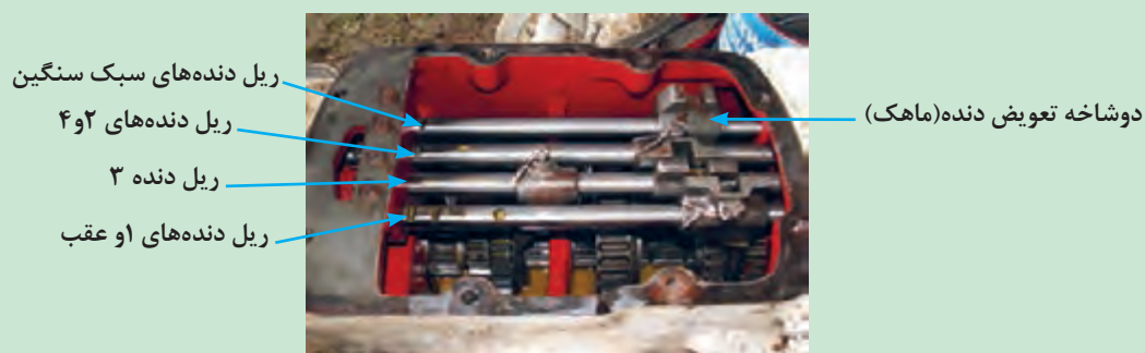
شکل ۳۰. جعبه دنده تراکتور MF۲۸۵
