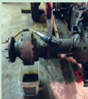
شکل ۳۲. کاهنده نهایی بعد از باز کردن چرخ
