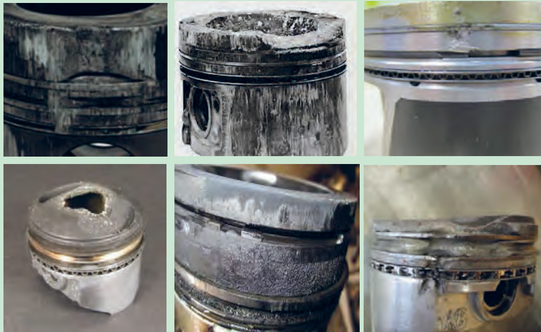
شکل ۷۴. نمونه ای از پیستون های معیوب
