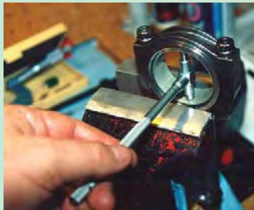
شکل ۸۳. کنترل بیضی شدن سر بزرگ شاتون
