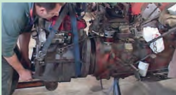
شکل ۳۲. جدا کردن موتور از جعبه دنده
