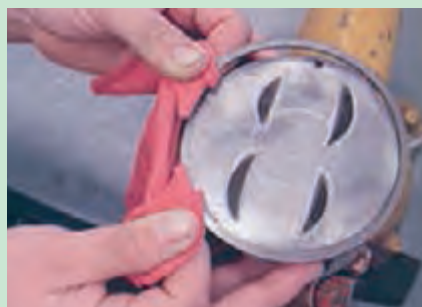
شکل ۵۳. خارج کردن رینگ بدون رینگ بازکن
