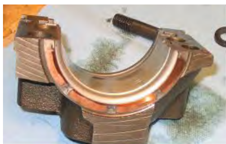
شکل ۷۳. نمونه بغل یاتاقانی معیوب
