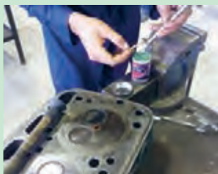
شکل ۷۸. زدن روغن سنباده به سوپاپ ها
