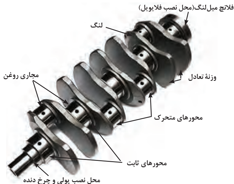
شکل ۱۶. اجزاء میل لنگ
