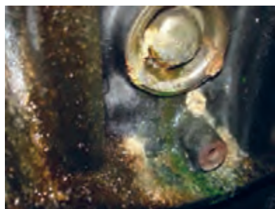
شکل ۷. نشتی از پولکی های موتور
