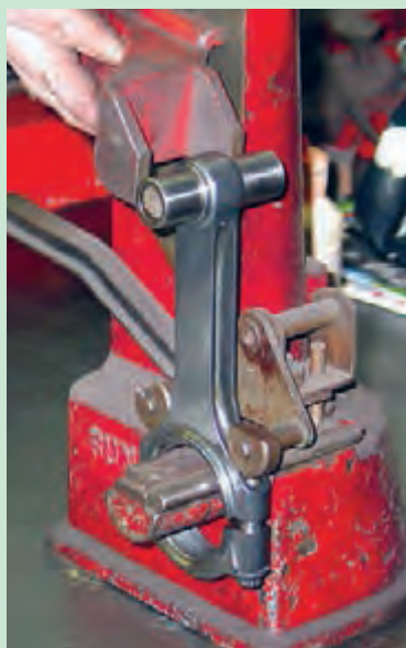
شکل ۸۲. پیچیدگی شاتون، اندازه گیری و اصلاح آن
