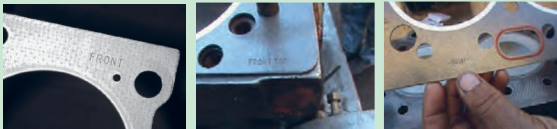
شکل ۸۶. علامت های روی واشر سرسیلندر
