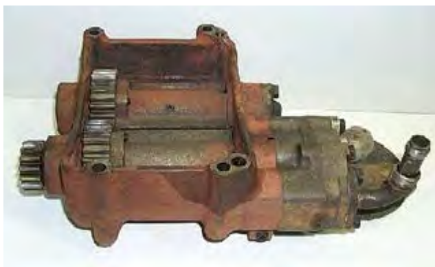
شکل ۴۴. بالانس‌های نصب شده روی پمپ روغن
