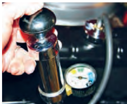
شکل ۶. آزمایش نشت یابی تحت فشار
