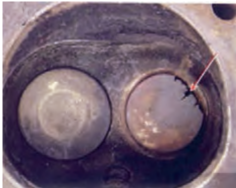
شکل ۷۰. عیوب ظاهری سوپاپ‌ها
