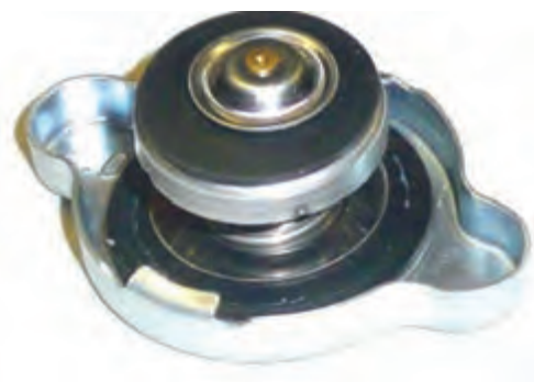
شکل ۱۲. درب رادیاتور و سوپاپ های آن
