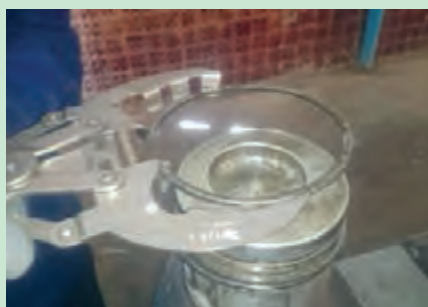
شکل ۵۲. نحوه خارج کردن رینگ از روی پیستون
