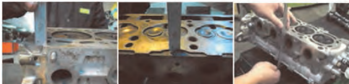
شکل ۸۳. کنترل ارتفاع مجاز کف تراشی سر سیلندر
