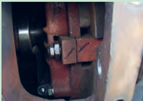
شکل ۲۶. علامتگذاری قطعات مجموعه کلاچ
