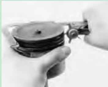
شکل ۵۸. روش های تمیز کردن شیار رینگ پیستون
