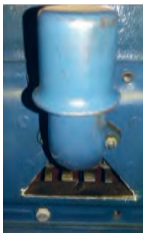
۴۰. تهویه محفظه کارتر در تراکتور U650
