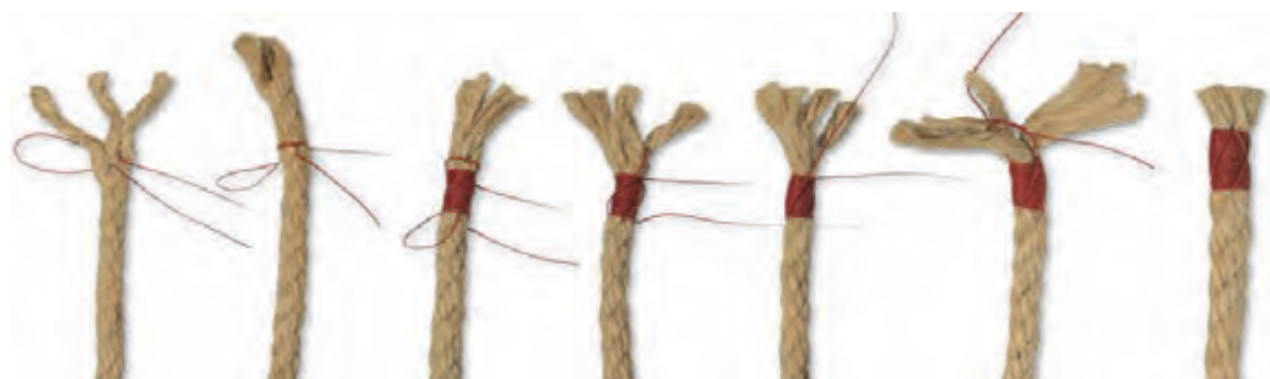
شکل ۲۱-۲- نخ‌پیچی کردن انتهای طناب
