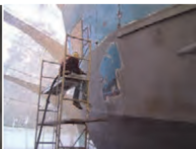
شکل ۱-۷ زنگ‌زدایی در اسکله خشک
