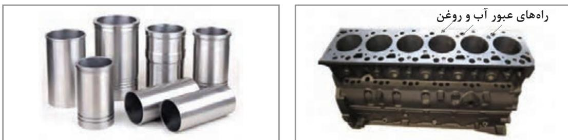
شکل ۸- بلوک سیلندر و بوش سیلندر
