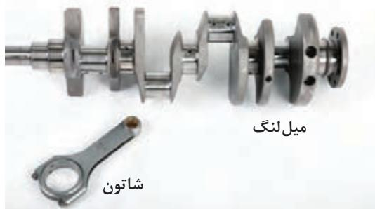
شکل ۱۰- میل لنگ و شاتون
