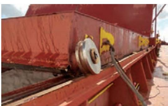
شکل ۳- دریک انبار که چرخ‌های آن خراب شده است.
