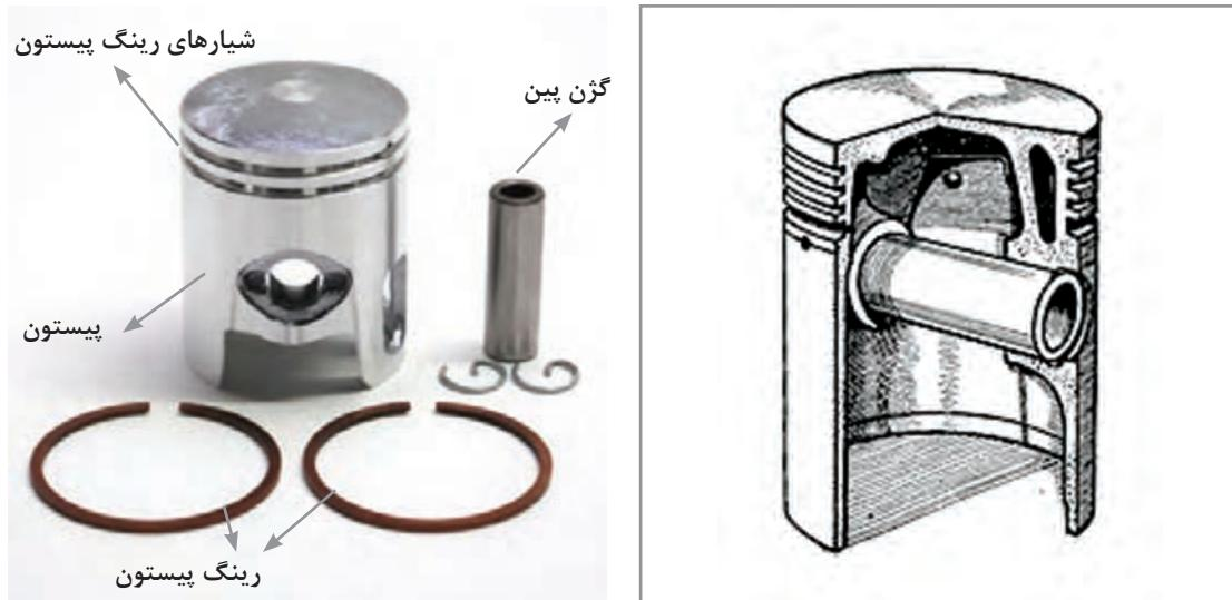
شکل ۷- پیستون به همراه گزن پین و رینگ پیستون ها
