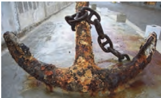
شکل ۳- نمونه‌هایی از خوردگی آب دریا
