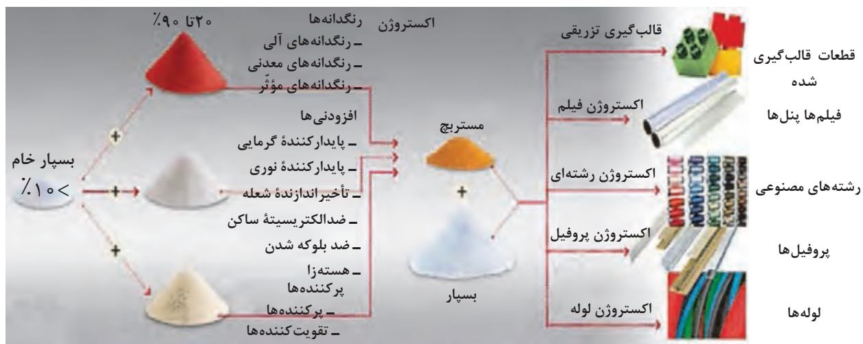
شکل ۶- فرایند تولید ماستر بیچ و قطعات بسیاری
