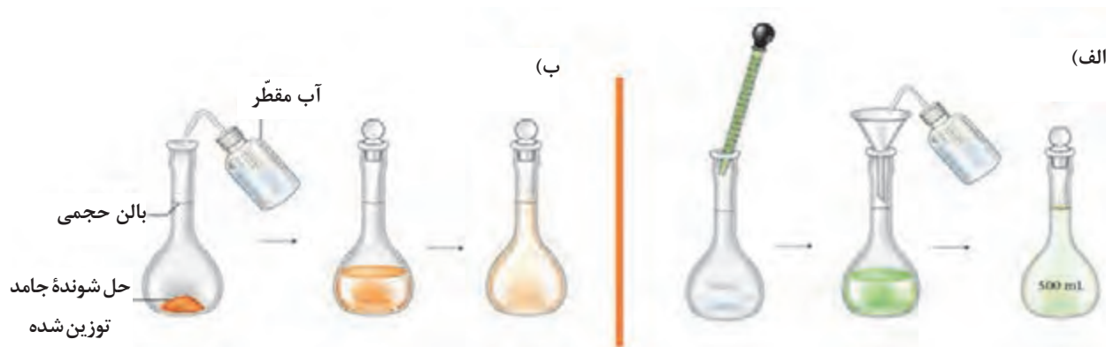
شکل ۲- تهیه محلول با نرمالیت مشخص از الف) نمونه مایع ب) نمونه جامد
