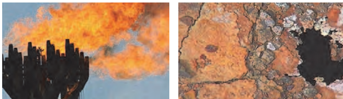
شکل ۶- نمونه‌هایی از خوردگی در دمای بالا
