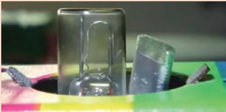
شکل ۳۶- راه انداز (استارت) لامپ مهتابی پس از گرم شدن
