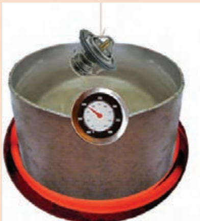
شکل ۴۸- طرح ساده‌ای از فعالیت عملی عملکرد یک ترموستات
