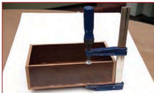
شکل ۹-۱۶. بستن جعبه به وسیلهٔ پیچ دستی
