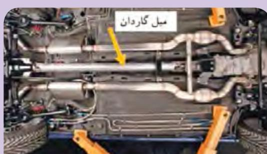
شکل ۳۲- میل گاردان بارگذاری پیچشی را
