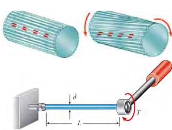
شکل ۳۰- پیچش در یک قطعه
