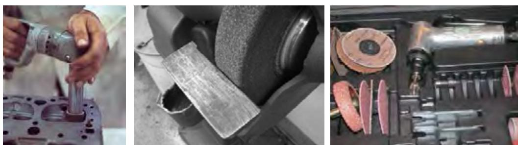
شکل ۱۱- انواع دستگاه سنگ سنباده و سنگ فرز
