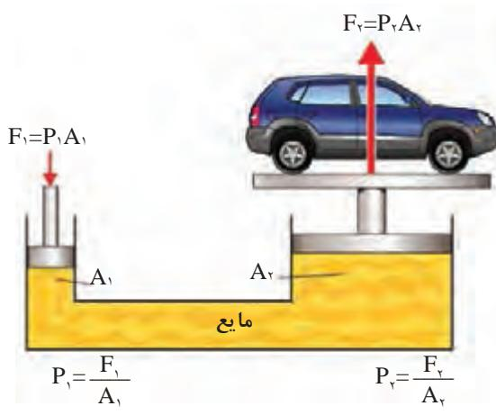
شکل ۱۸- جک هیدرولیکی
