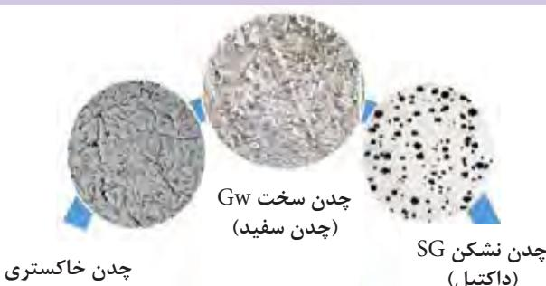
شکل ۱۴- انواع چدن و شکل متالوگرافی آنها
