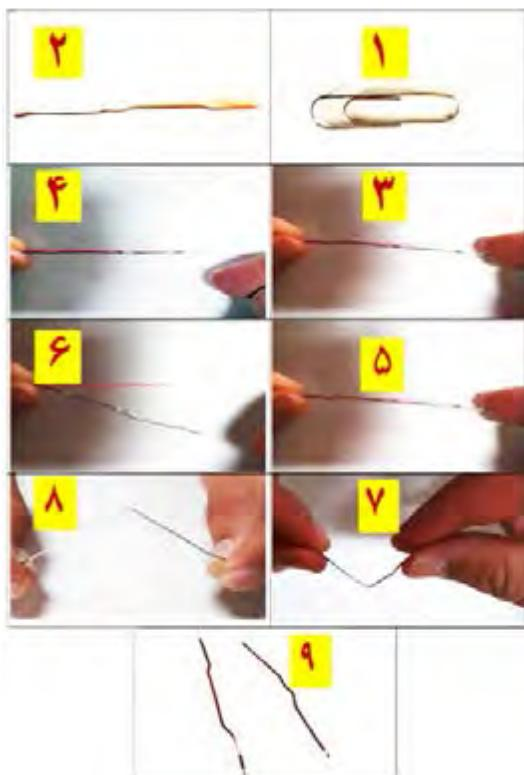
شکل ۱۲- آزمایش بارگذاری روی یک مفتول گیره کاغذ
