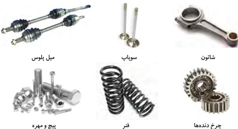
شکل ۱۳- کاربرد فولاد آلیاژی در قطعات خودرو
