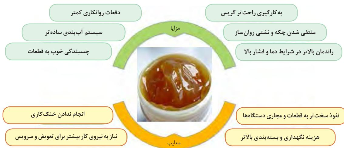
شکل ۵۱- مزایا و معایب گریس‌ها نسبت به روانکارهای مایع
