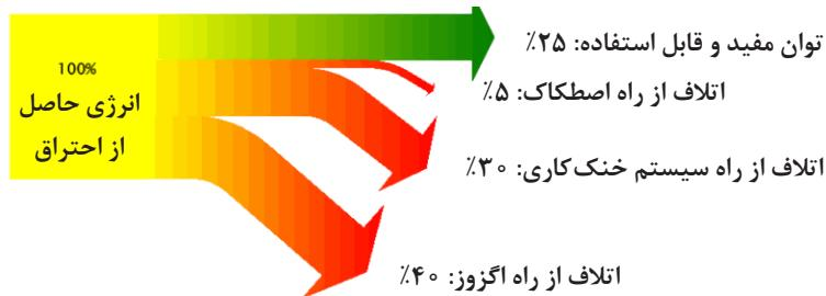
شکل ۲۶- بازده حرارتی موتور
