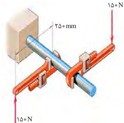
شکل ۶- وارد کردن گشتاور بر میله با دو آچار شلاقی
