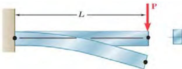
شکل ۲۵- خمش یک قطعه تحت بارگذاری خمشی
