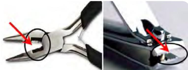
شکل ۱۹- لبه های برنده خراب شده در ناخن گیر و دمباریک
