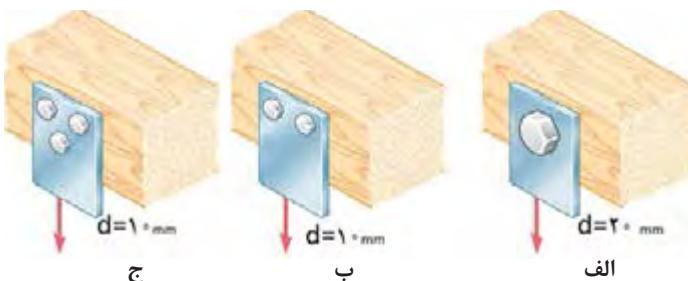
شکل ۲۰- اتصالات چند روش اتصال تسممه به دیوار چوبی تحت بارگذاری برشی
