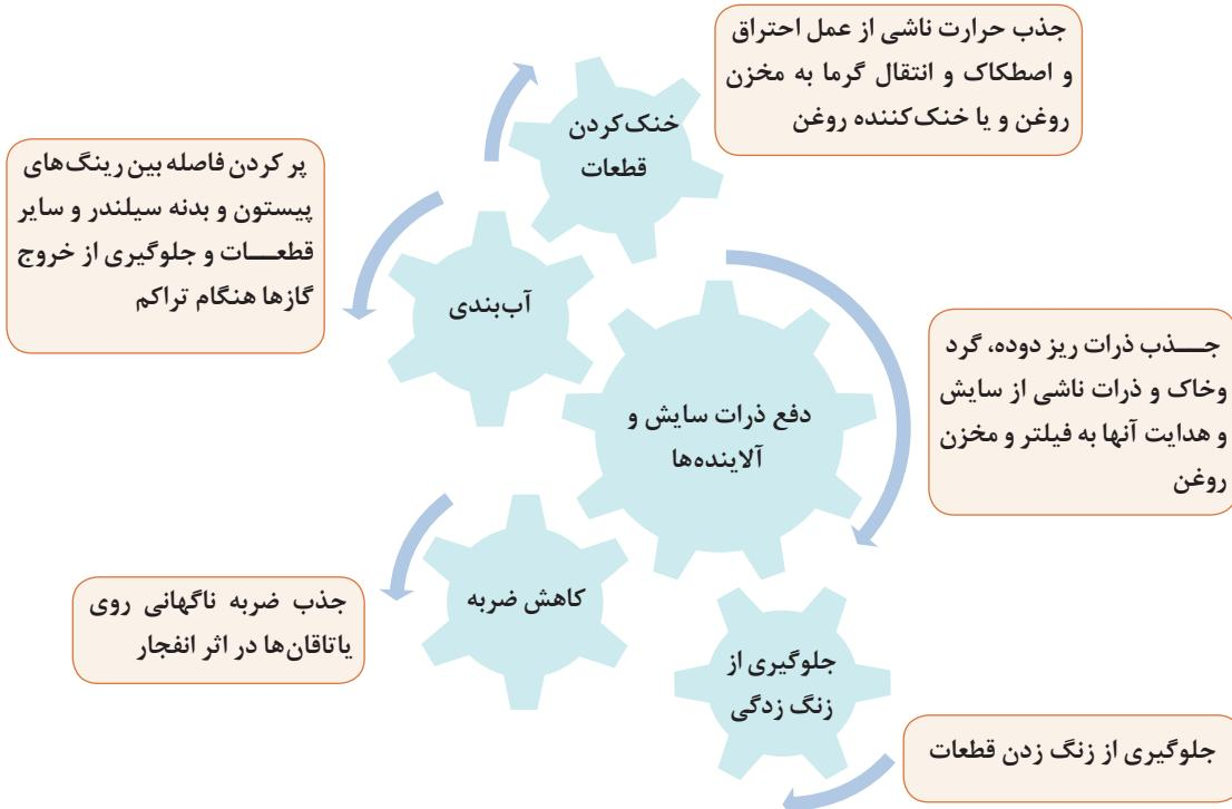
شکل ۴۹-وظایف روانکار در موتور
