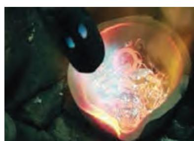
شکل ۴- رسیدن به نقطه ذوب
