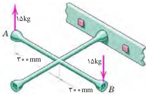
شکل ۸- وارد کردن گشتاور بر پیچ با آچار چرخ
