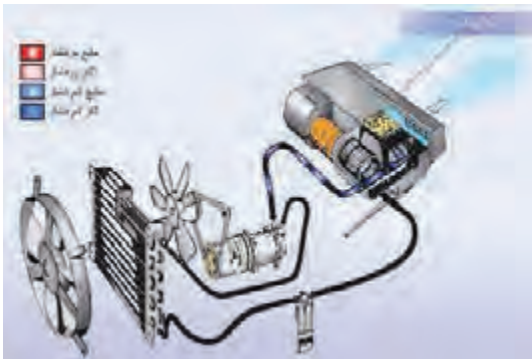
شکل ۴۱- استفاده از گاز مبرد در کولر خودرو
