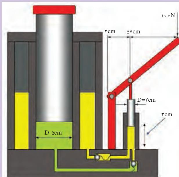
شکل ۲۰- جک هیدرولیکی
