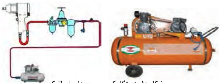
شکل ۱۰- دستگاه کمپرسور و مدار پنوماتيک
