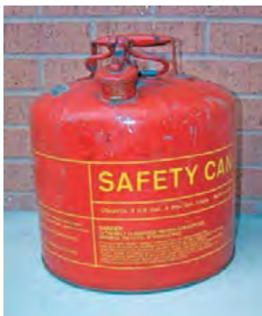
شکل ۴- ظرف مناسب نگهداری بنزین و گازوئیل
