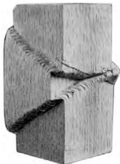
شکل ۳۴-۵- شکست چوب در اثر نیروهای فشاری
