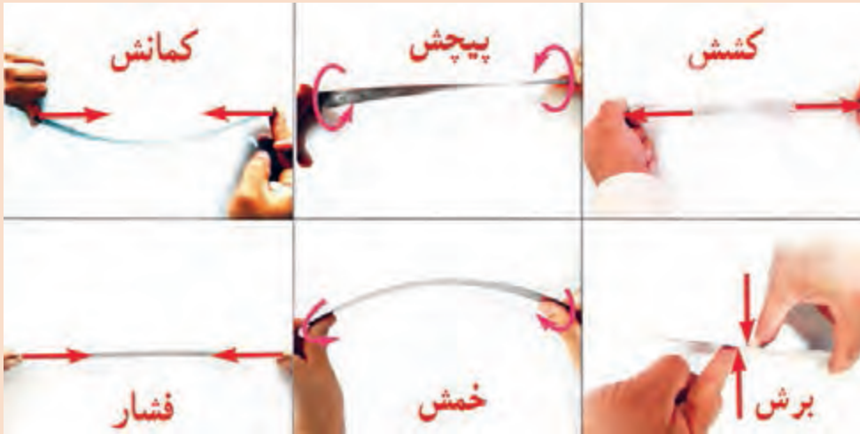
شکل ۵-۱۲ - انواع بارگذاری بر روی خط کش فلزی
