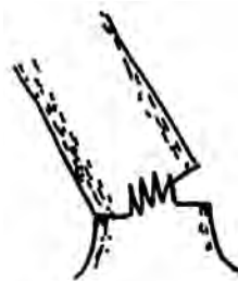
شکل ۱۵-۲- برای قطع درخت ابتدا عمل زیر برش مطابق شکل انجام می شود.
