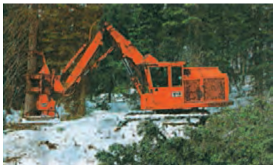
شکل ۱۸-۲- قطع درختان به وسیله ماشین های مخصوص با چرخ زنجیری که برای فصل زمستان مناسب است، انجام می شود.
