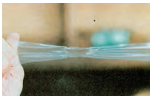
شکل ۵-۲۱ - یک نوار پلاستیکی که پس از کشیده شدن در حالت اول برگشت نداشته است.
