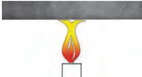
شکل ۸-۸ خنثی کردن اثر مغناطیسی یک آهن‌ریا به وسیله گرما
