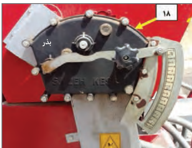
شکل ۳۸- جعبه دنده تنظیم ریزش بذر
