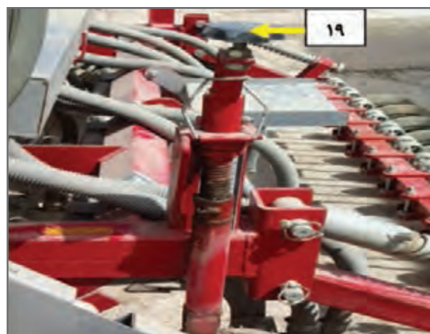
شکل ۳۹- اهرم تنظیم عمق کاشت
