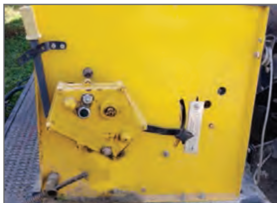
شکل ۱۵- جعبه دنده و درجه ریزش بذر
