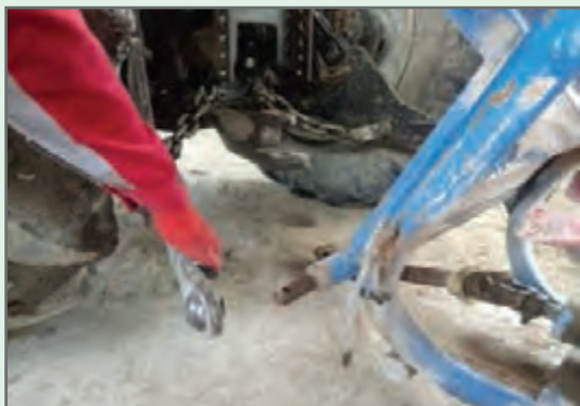
شکل ۹- اتصال بذریاش به بازوهای کناری تراکتور
