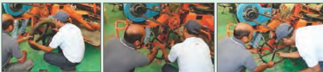
شکل ۲۸- تعویض چرخ‌های نشاکار
