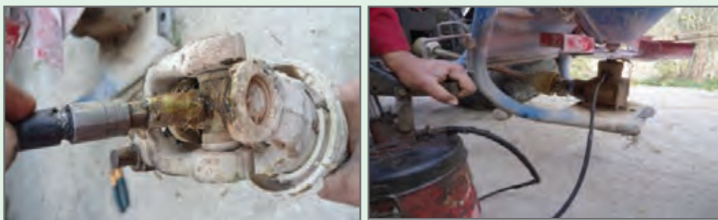
شکل ۱۶- گریس کاری گاردان و بذریاش
