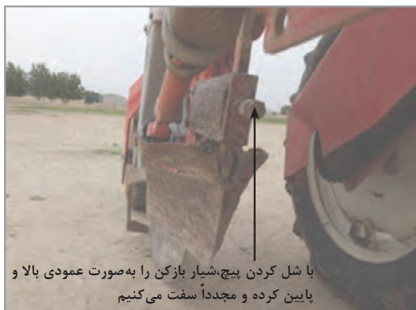
شکل ۲۰- تنظیم شیار بازکن
