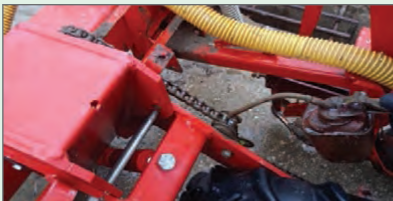
شکل ۱۴- روغن کاری زنجیره و تویی های انتقال نیروی ردیف کار
