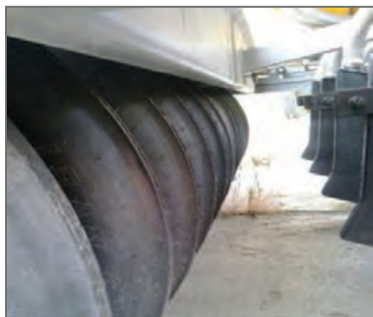
شکل ۵۵- چرخ‌های فشار دهنده بوشورت به هم پیوسته
