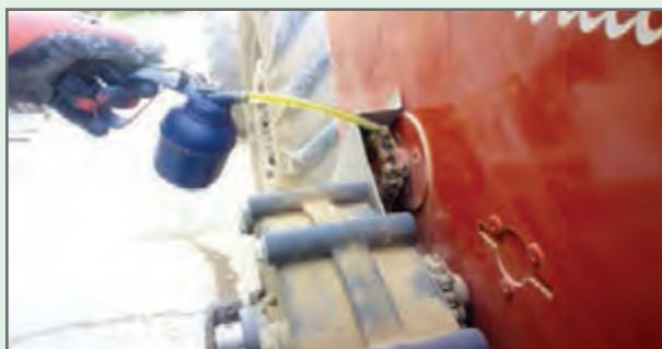
شکل ۴۳- روغن کاری چرخ دنده‌ها
