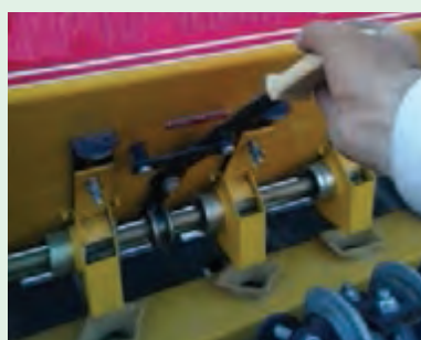
شکل ۵۸ - بخشی از تنظیمات که قبلاً انجام شده، در شروع عملیات کاشت، واریسی می‌گردد
