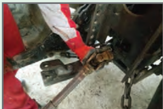
شکل ۱۰- نصب گاردان بین بذریاش و تراکتور
