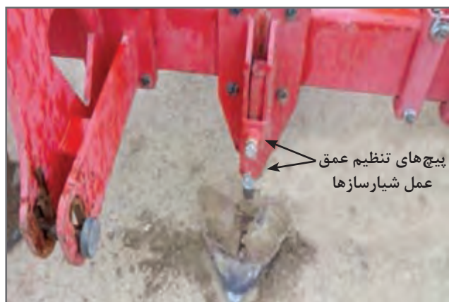
شکل ۱۷- پیچ‌های تنظیم عمق شیارساز
