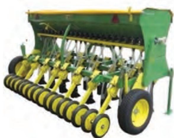
شکل ۳۳- نمونه‌ای ماشین کاشت مستقیم مکانیکی مناسب جهت کاشت دیم مدل: ۳۰۰۰-rock
