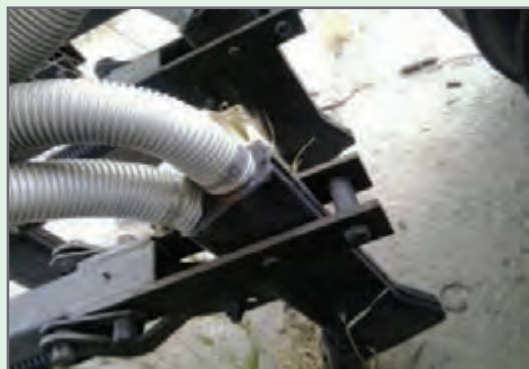
شکل ۴۶- ماشین کاشت دیم دارای لوله‌ها و شیلنگ‌های متعددی اغلب با بست پیچی یا پرسی هستند
