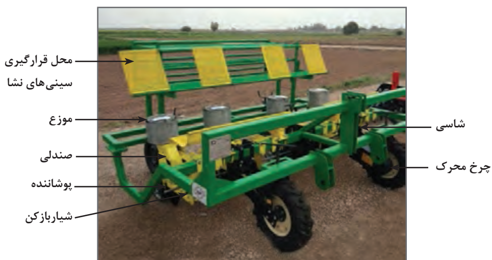
شکل ۴- اجزای ساختمانی یک نمونه نشاکار صیفی
