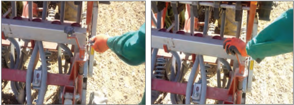
شکل ۵۱ - آزاد کردن ضامن و تنظیم عمق کاشت با چرخش اهرم
