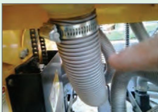
شکل ۴۶- ماشین کاشت دیم دارای لوله‌ها و شیلنگ‌های متعددی اغلب با بست پیچی یا پرسی هستند
