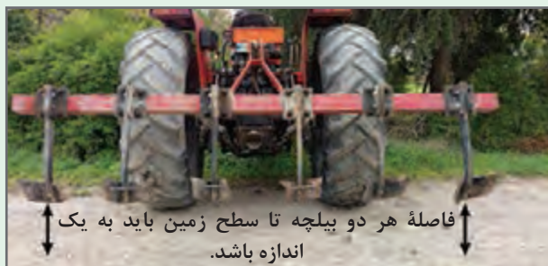
شکل ۱۴- تراز طولی شیارک
