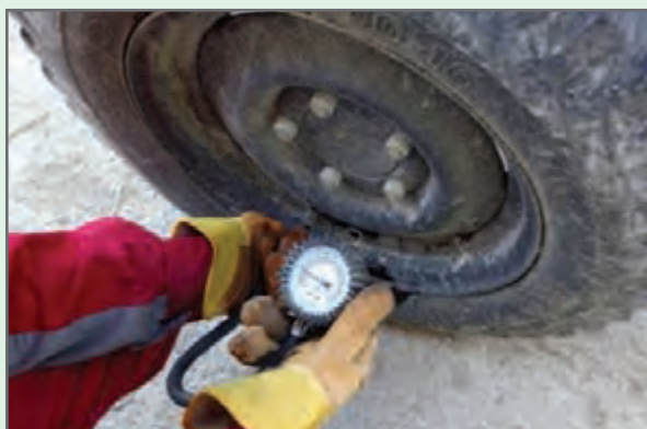
شکل ۱۳- تنظیم باد چرخ‌ها به مقداری که در دفترچه راهنمایی ماشین نوشته شده است
