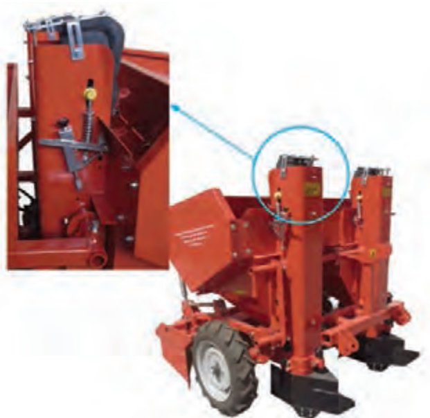
شکل ۱۳- مکانیزم تنظیم کشش نوار نقاله و تک دانه کن
