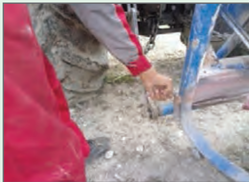
شکل ۹- اتصال بذریاش به بازوهای کناری تراکتور
