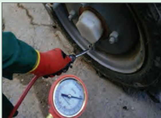
شکل ۴۴- تنظیم باد چرخ‌های دستگاه
