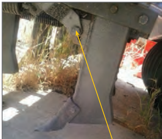
شکل ۵۴- سوراخ روی بازوی بیلچه شیار بازکن
