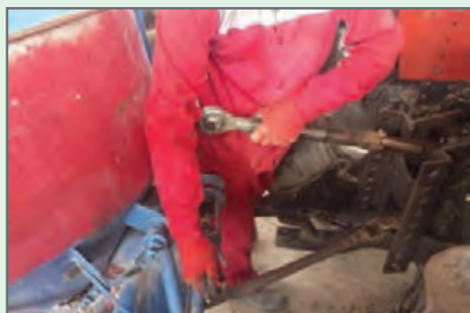
شکل ۱۱- اتصال بازوی وسط تراکتور به بذریاش
