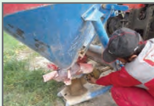
شکل ۱۰- نصب گاردان بین بذریاش و تراکتور
