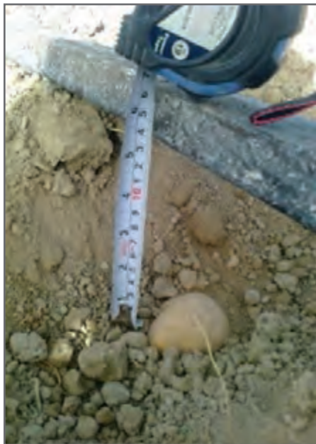
شکل ۲۰- عمق کاشت (فاصله کف شیار کاشت تا سطح زمین)
