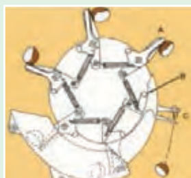
شکل ۷- تصویر شماتیک نحوه کار موزع انگشتی
