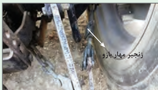
شکل ۲۴- زنجیر مه‌ار برای تنظیم تعادلی
