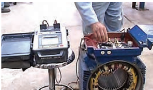
آزمایش تست بدنه موتور با دستگاه میگر
