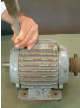
شکل ۱۵- علامت گذاری قطعات جداشونده موتور با سنبه نشان
