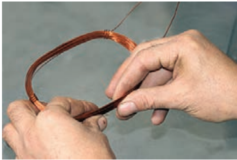
شکل ۳۸-۲ مرتب کردن سیم‌ها جهت کلاف گذاری
