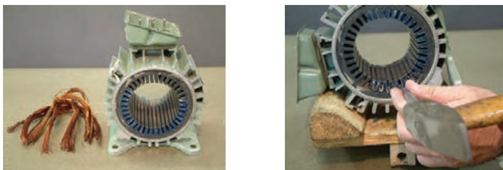
شکل ۲۴- سیم های خارج شده از شیارها
