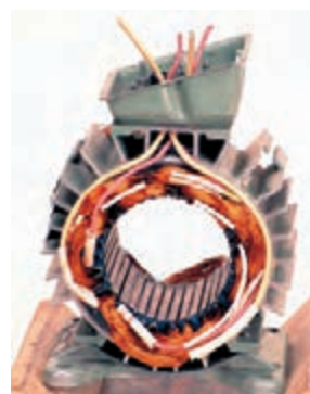
شکل ۵۷- عایق برداری، سربندی، وارنیش گذاری، لحیم کاری و هدایت سیم ها به تخته کلم
