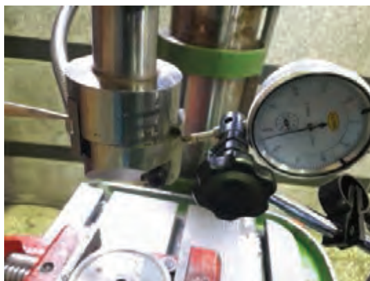
شکل ۱۰- تنظیم مته لنگ بدون میکرومتر و با ساعت اندازه گیری
