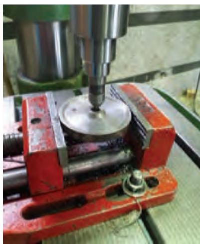
شکل ۹- استفاده از مرگک در ایجاد هم‌مرکزی صحیح
