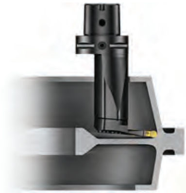
شکل ۵- ایجاد شیار در داخل سوراخ
