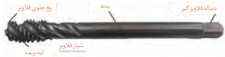
شکل ۲- ساختمان قلاویز ماشینی
