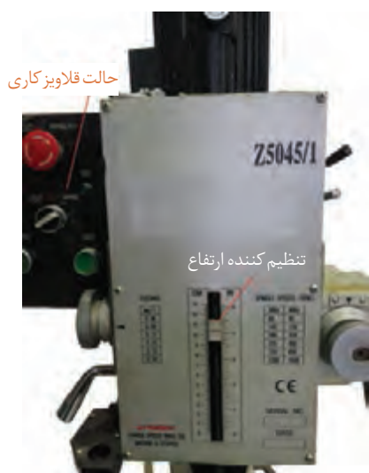
شکل ۴- کُلگی قلاویز ماشینی با قابلیت تنظیم ارتفاع
