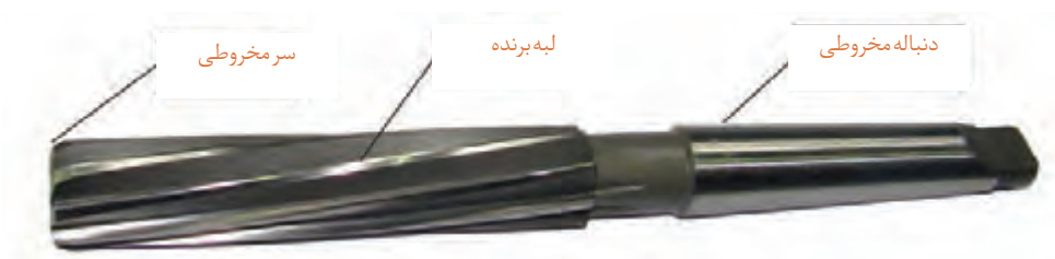
شکل ۹- ساختمان برقوی ماشینی
