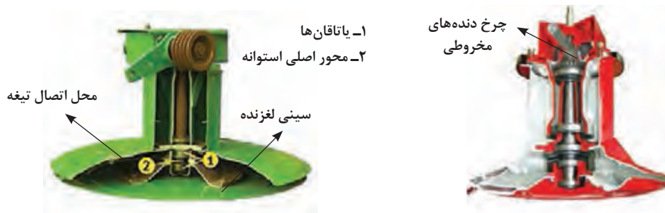
شکل ۴- شماتیک داخلی جعبه دنده و محور اصلی استوانه‌ها و سینی زیر دروگر استوانه‌ای
