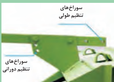
شکل ۵۱- هدایت کننده علوفه و پیچ‌های تنظیم آن
