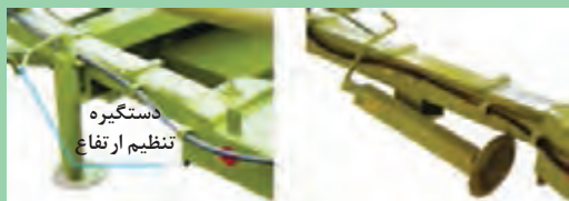
شکل ۶۸- پایه نگه دارنده در حالت حمل و نقل (راست) و در حالت استراحت (چپ)
