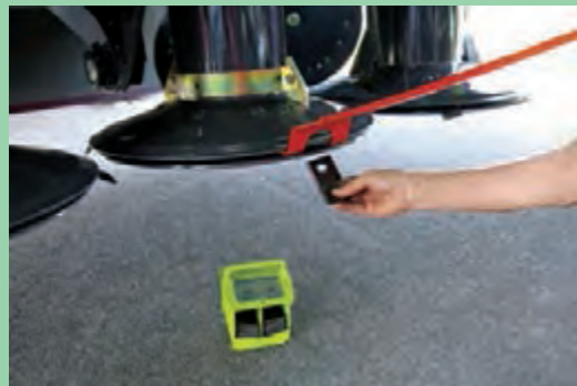
شکل ۲۰- نحوه تعویض تیغه در دروگر استوانه‌ای
