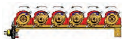
شکل ۸- جهت چرخش بشقاب‌ها در دروگر بشقابی
