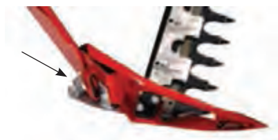
شکل ۳۱- کفشک تنظیم ارتفاع برش
