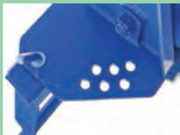
شکل ۱۳- صفحه سوراخ دار روی شاسی شانه خورشیدی
