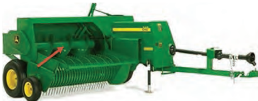
شکل ۵- استوانه مارپیچ برای هدایت علوفه به محفظه تراکم
