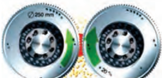
شکل ۵۵- استوانه‌های واحد دوباره خردکن
