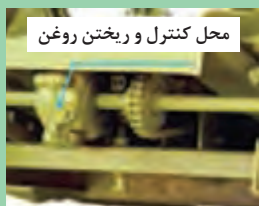
شکل ۶۷- جعبه دنده دوکفه‌ای
