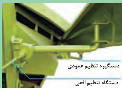
شکل ۵۰- دستگیره‌های تنظیم صفحه جداکننده محافظ علوفه
