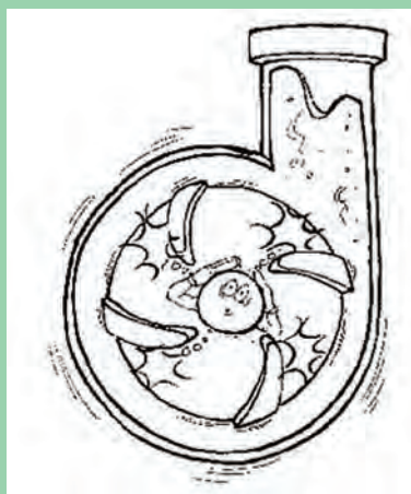
شکل ۱۵- کاویتاسیون در پروانه پمپ
