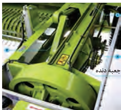
شکل ۱۲- مسیر انتقال توان در دستگاه بسته‌بند
