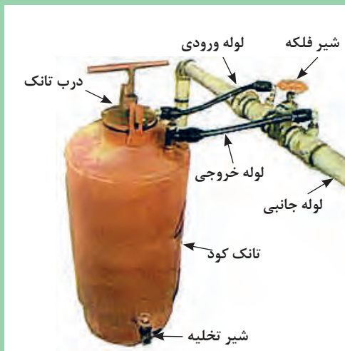
شکل ۳۳- اجزای سیستم توزیع کود
