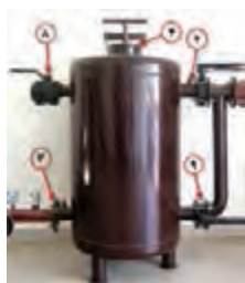
ب) تصویر واقعی شکل ۲۲- صافی شن
