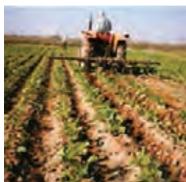
شکل ۳۲- کنترل مکانیکی علف‌های هرز با استفاده از کولتیواتور شمشیری (راست) و U شکل (چپ)
