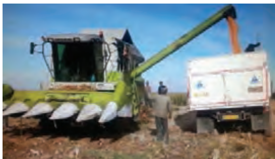
شکل ۱۳- برداشت ذرت دانه‌ای با کمباین و تخلیه انبار در کامیون
