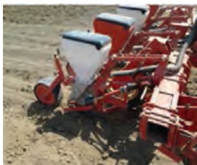
شکل ۱۴- کشت سویا با ردیف کار پنوماتیک دوردیفه
