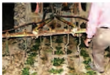
شکل ۳۲- کنترل مکانیکی علف‌های هرز با استفاده از کولتیواتور شمشیری (راست) و U شکل (چپ)
