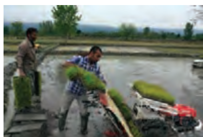
شکل ۲۰- قراردادن جعبه نشا بر روی نشاکار
