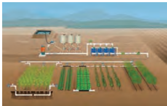
شکل ۲- سامانه آبیاری قطره‌ای
