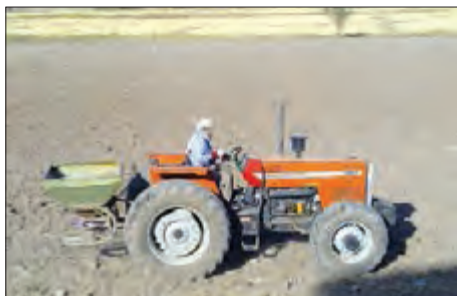
پاشیدن بذر و زیر خاک کردن آن با ماشین
