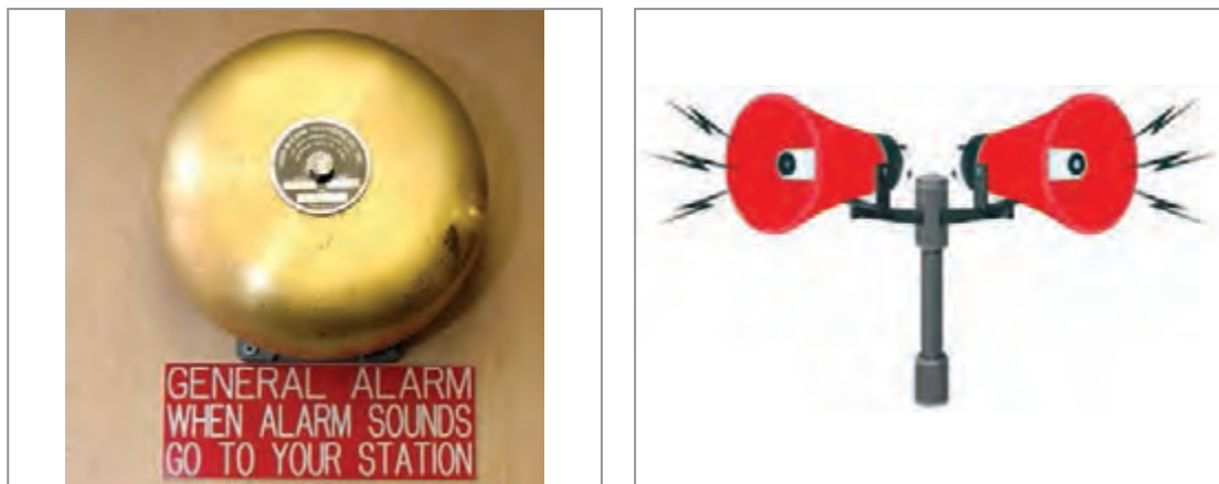
شکل ۱۳- سیستم اخطار شناور
