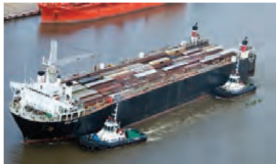
شکل ۳۰- عملیات یدک کشی به روش پهلو به پهلو یا هل دادن
