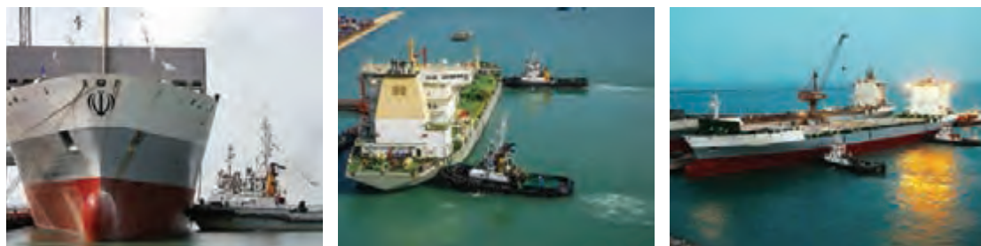
شکل ۲۹- عملیات یدک‌کشی پهلوپهلو
