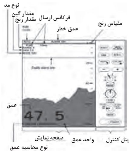
شکل ۱۸- مشخصه‌ها و نشانه‌های نمایشگر عمق یاب
