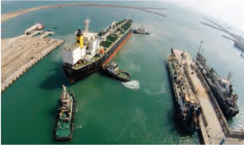
شکل ۲۰- عملیات پهلو دهی کشتی به اسکله
