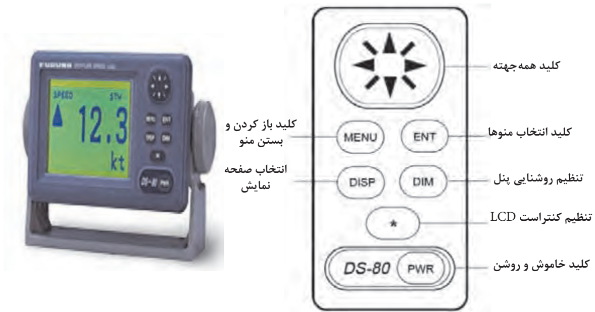
شکل ۳۱- نمای کلی کلیدهای کنترل سیستم سرعت سنج
