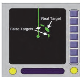
شکل ۱۶- نمایش پژواک‌های جانبی در صفحه نشانگر رادار
