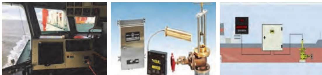
شکل ۲۶- نمایشگر و قسمت‌های تشکیل‌دهنده سرعت‌سنج الکترومغناطیسی
