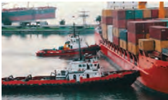
شکل ۳۰- عملیات یدک کشی به روش پهلو به پهلو یا هل دادن
