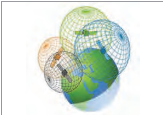
شکل ۹- نحوه موقعیت‌یابی در سامانه G.P.S با سه یا چهار ماهواره
