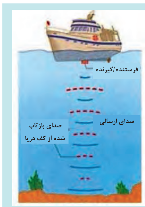
شکل ۱۶- نحوه ارسال و دریافت امواج در دستگاه عمق یاب
