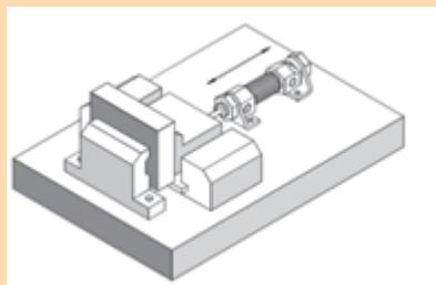
مداری ترسیم کنید که سیلندر دوطرفه‌ای پس از استارت با رسیدن به ابتدا و انتهای کورس خود با رسیدن به فشار ۲۰ Bar به طور اتوماتیک حرکت رفت و برگشت انجام دهد.
