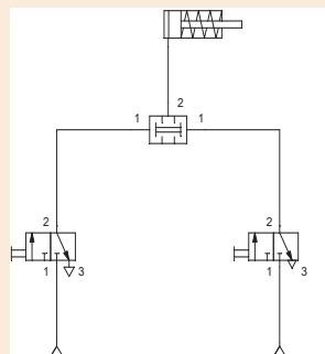
۲- در تصویر رو به رو مدار پنوماتیکی یک سیلندر یک کاره که استارت آن از طریق دودست انجام پذیرفته و با رهای نمودن شستی برگشت نماید آورده شده است. ابتدا با استفاده از نرم افزار فلوبیدسیم عملکرد مدار را شبیه سازی کنید سپس بر روی میز آموزشی مدار را نصب کنید.
