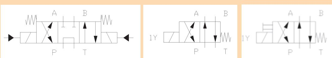
علامت اختصاری شیر هیدرولیک برقی در مدار فرمان (مدار الکتریکی) به شکل زیر می‌باشد.
