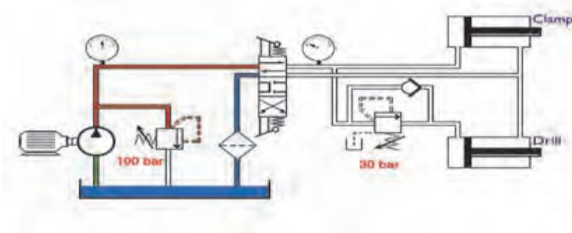
جهت باز شدن سیلندر کلمپ قبل از سیلندر دریل نیاز است از یک شیر ترتیبی قبل از سیلندر دریل استفاده شود. شیر ترتیبی باعث می شود تا زمانیکه فشار در سیلندر کلمپ به مقدار تنظیم شده بر روی شیر ترتیبی نرسد، سیلندر دریل باز نشود.
