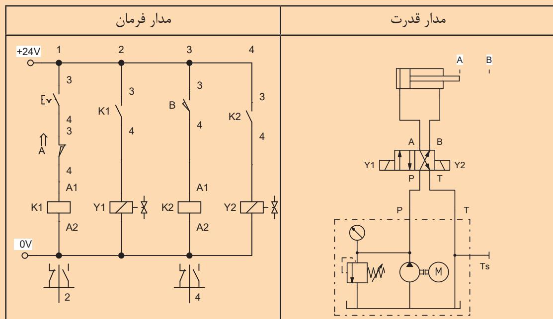
مدار هیدرولیکی ترسیم کنید که با فشار دادن یک شستی استارت، سیلندر دو طرفه به جلو حرکت کرده سپس با برخورد به یک میکروسوئیچ به عقب باز گردد. سپس این مدار را بر روی تابلو بیندید.
