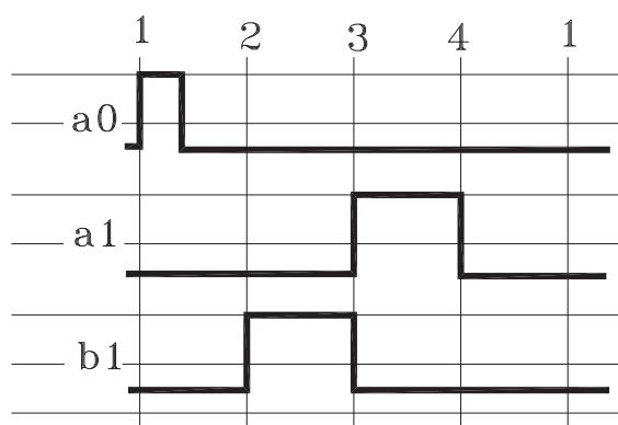
۷- دیاگرام فرمان: هدف از ترسیم این دیاگرام بررسی موقعیت و وضعیت فرمان‌دهنده‌ها در مدارات پنوماتیک می‌باشد. به طوری که موقعیت فیزیکی هر فرمان‌دهنده و عامل تحریک آن در دیاگرام مشخص شود.
