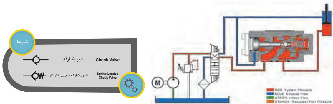
با توجه به مدار زیر، محل قرارگیری مناسب شیرهای کنترل جهت یک طرفه را مشخص کنید.
