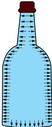
فشار هیدرولاستاتیک در داخل یک بطری آب
