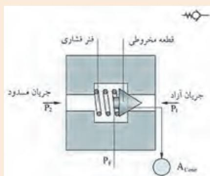
در شکل زیر، شیر کنترل جهت یک طرفه نشان داده شده است. این نوع از شیرها، ساده‌ترین شیر کنترل جهت می‌باشد که اجازه عبور جریان سیال را در یک جهت می‌دهد و از حرکت جریان در جهت مخالف جلوگیری می‌کند. با توجه به شکل نحوه عملکرد این شیر را توضیح دهید.
