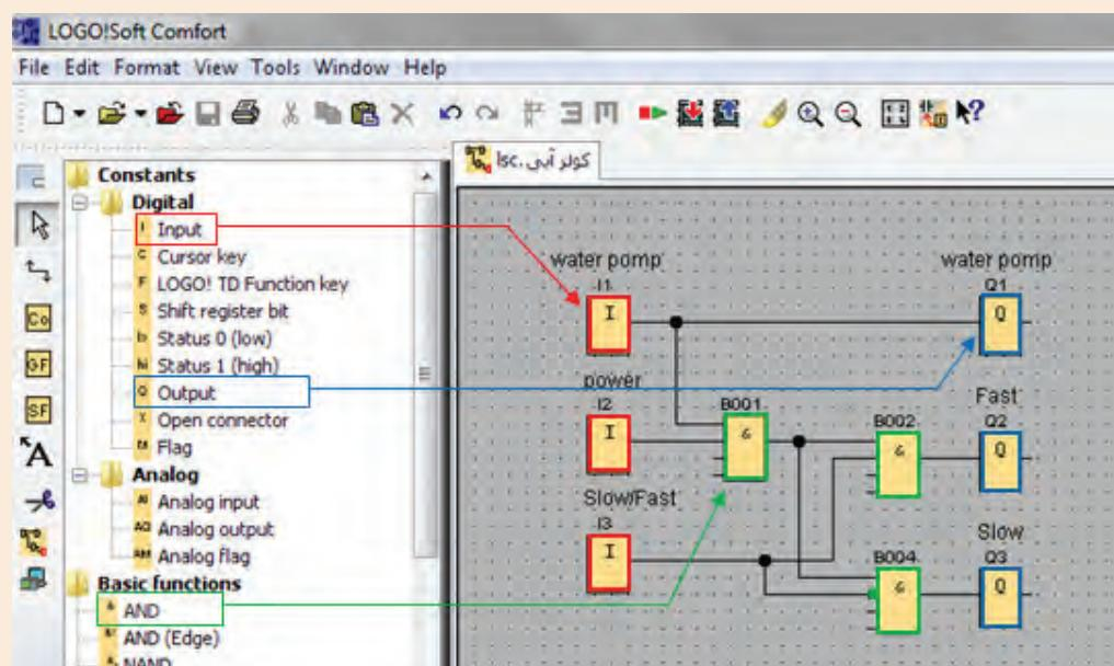
در مدار فوق عناصر I2، I1 و I3 ثابت دیجیتال ورودی<sup>۱</sup> و Q1، Q2 و Q3 ثابت دیجیتال خروجی<sup>۲</sup> و B001، B002 و B004 تابع پایه AND می باشند که در ادامه در مورد آنها توضیح داده خواهد شد.
