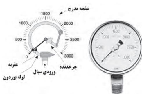
در صنعت فهمیدن مقدار فشار موجود در سیستم بسیار مهم است. در واقع تکنسین ها با خواندن مقدار نشان داده شده بر روی فشارسنج<sup>۱</sup>، صحبت عملکرد سیستم را بررسی می کنند. وسیله ای که با آن فشار را اندازه گیری می کنند فشارسنج نام دارد. شکل زیر یک فشارسنج و اجزای سازنده آن را نشان می دهد.
