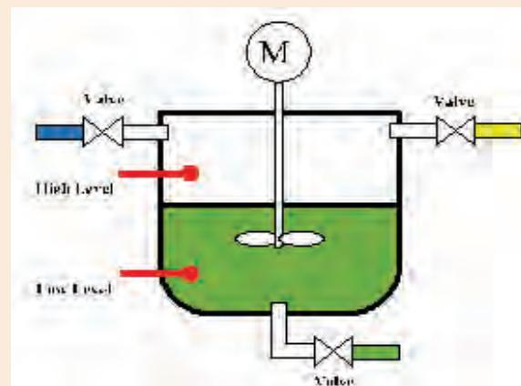
۲- مداری طراحی کنید که با رسیدن مایع درون مخزن به حسگر پایین، شیر ۳ بسته و شیرهای ۱ و ۲ باز شود. با رسیدن سطح مایع به حسگر بالایی، موتور همزن به مدت ۳۰ ثانیه روشن گردد و با خاموش شدن موتور، شیر ۳ مجدد باز شود. طراحی خود را هم به روش نرdbانی و هم به روش بلوکی پیاده سازی نمایید.
