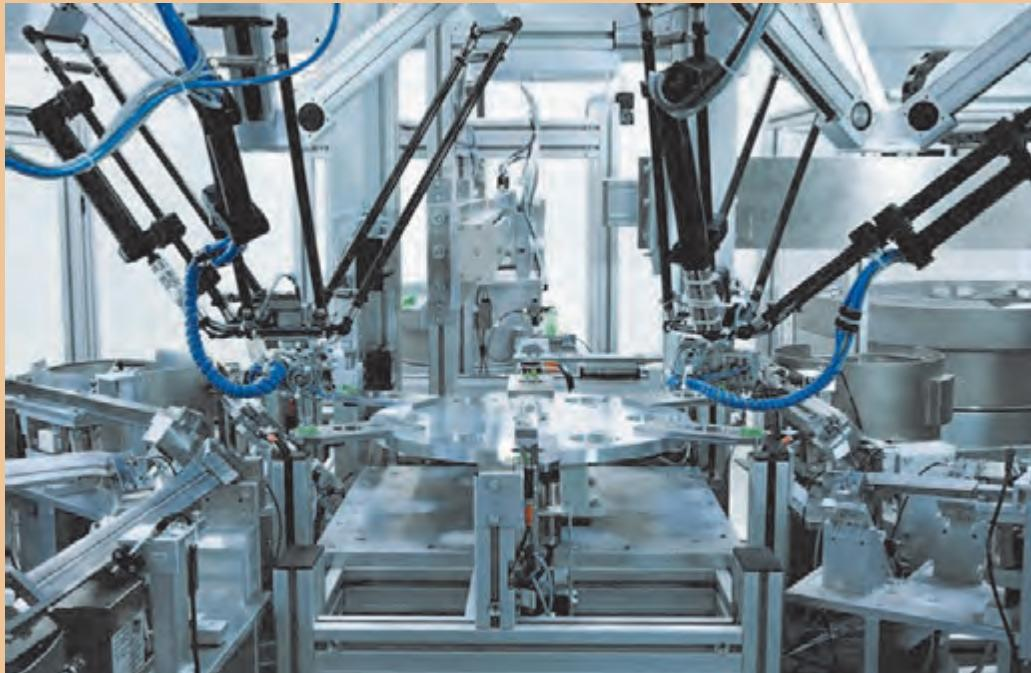
یکی از سیالات مورد استفاده در صنعت، هوا فشرده می‌باشد. از هوا فشرده جهت کنترل و انتقال نیرو به سیستم‌ها استفاده می‌شود که علم پنوماتیک گفته می‌شود. کلمه پنوما از زبان یونان قدیم مشتق شده است و به عنوان تنفس باد و در فلسفه به عنوان روح است. در علم پنوماتیک استفاده از هوا فشرده در تجهیزات صنعتی بحث می‌شود. در واقع پنوماتیک دانش تولید، کنترل و به کارگیری نیروی هوا فشرده می‌باشد.
