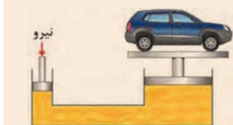
با توجه به نتایجی که از آزمایش بالا گرفتید، طرز کار جک هیدرولیکی را بیان کنید.
