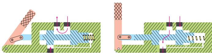
مجراهای با نام‌های P,T,A,B نام‌گذاری می‌کنند که P مجرای اتصال به پمپ (جریان پرفشار) و T مجرای اتصال به مخزن (جریان کم فشار) و A، B مجراهای خروجی شیر می‌باشند. در شکل زیر نمایی از عملکرد یک شیر کنترل مسیر نمایش داده شده که با تحریک دستی اسپول، مسیر جریان تغییر کرده است. نواحی قرمزرنگ نشان‌دهنده جریان پرفشار (متصل به پمپ) و نواحی آبی رنگ، خطوط کم فشار (متصل به تانک) را نشان می‌دهد.
