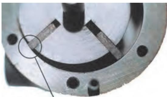
تماس تیغه با پدنه کمپرسور به دلیل نیروی گریز از مرکز
