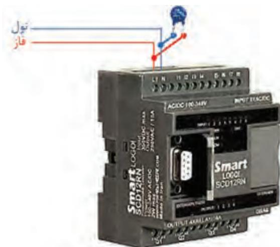
اما در اتصال رله های هوشمند با ولتاژ نامی ۲۲۰ جریان متناوب با توجه به اینکه تجهیز بطور مستقیم به شبکه برق شهری متصل می شود لازم است جهت حفاظت در مقابل ولتاژهای شدید و ناگهانی، یک مقاومت تابع ولتاژ<sup>۱</sup> ۲۰% بیشتر از ولتاژ نامی انتخاب و مطابق شکل بین دو پایه L1 و N نصب گردد.
