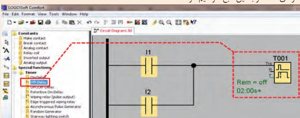
جهت تنظیم زمان تایمر بر روی آن کلیک راست نموده از پنجره باز شده گزینه اول (Block Properties...) را انتخاب و در پنجره جدید، مطابق شکل زمان تأخیر در خاموشی را تنظیم می نماییم. با تایید و بستن این پنجره، در گوشه سمت چپ شمای تایмер، زمان تنظیم شده نمایش داده می شود.
