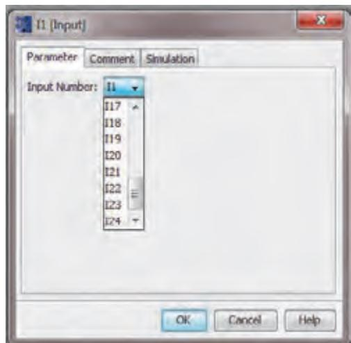
ورودی‌های دیجیتال می‌توانند دارای مقادیر صفر یا یک باشند. رله‌های هوشمند حداکثر می‌توانند تعداد ۲۴ ورودی دیجیتال داشته باشند. با دو بار کلیک چپ بر روی هر ورودی دیجیتال در محیط برنامه نویسی پنجره مشخصات آن باز می‌شود. در سربرگ **Parameter** از این پنجره می‌توان شماره مربوط به ورودی را که حداکثر ۲۴ می‌باشد، انتخاب نمود.
