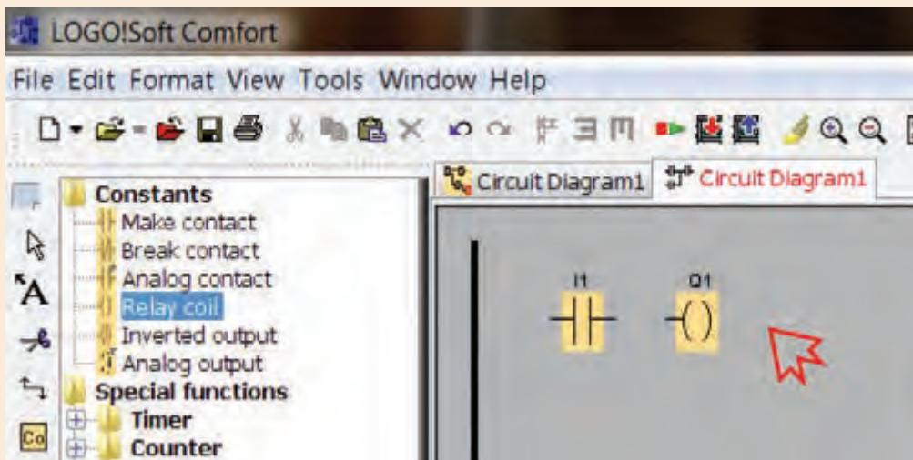
۴- اکنون از نوار ابزار سمت چپ، با انتخاب گزینه Connect، اتصال بین ورودی I1 و خروجی Q1 را با تکییک Drag&Drop بین پایه های المان ها برقرار کنید. شما می توانید از کلید میانبر F5 نیز برای فعال نمودن گزینه Connect استفاده نمایید.
