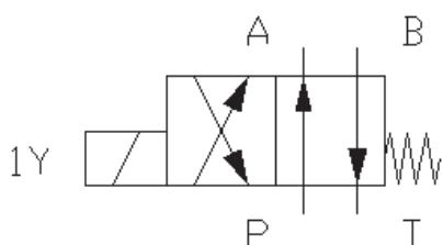
شیرهای هیدرولیک برقی نیز دارای وضعیت و حالت‌های مختلف هستند و می‌توانند  $2/2$  و  $3/2$  و  $4/2$  و  $4/3$  و غیره باشند.
