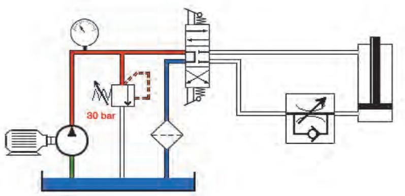
۱. در صورت تحریک شیر کنترل جهت، حرکت رفت و برگشت سیلندر به چه صورت خواهد بود؟
