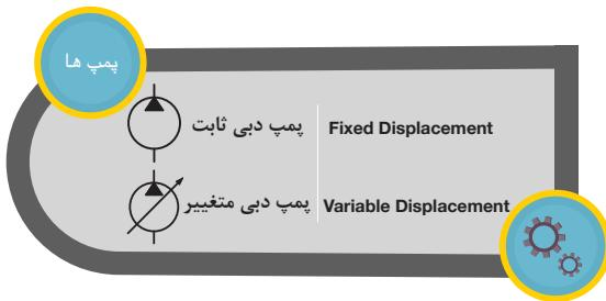
قبل از آدامه بحث آشنایی با اجزا سیستم‌های هیدرولیکی لازم به ذکر است جهت نمایش اجزا هیدرولیکی از نمادهای استانداردی استفاده می‌شود تا هم نمایش و فهم عملکرد اجزا راحت‌تر شود و هم در زمان ترسیم مدارات هیدرولیکی صرفه‌جویی گردد.
