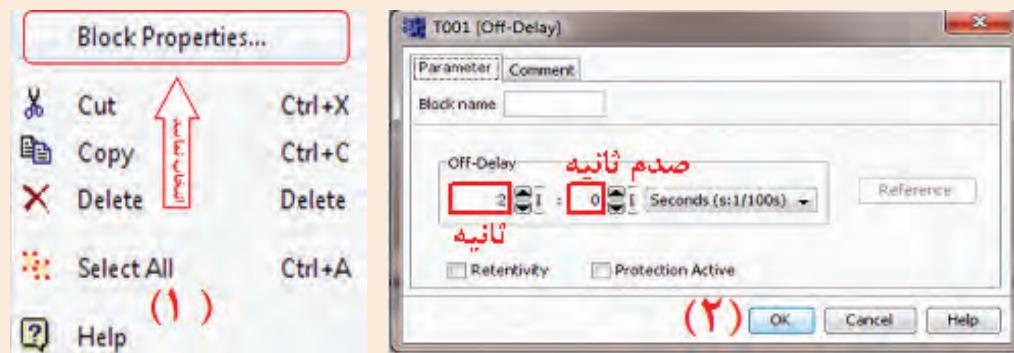
اکنون می بایست خروجی تایمر موجب روشن شدن لامپ گردد. اما همانطور که در شکل نیز مشهود است، تایمر هیچگونه پایه خروجی ندارد. پس مطابق تصویر یک ورودی تعریف می کنیم که مقادیر این ورودی معادل مقادیر خروجی تایمر باشد.
