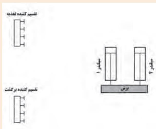
• شما می بایست یک مدار هیدرولیکی طراحی کنید تا سیلندرها به کمک یک شیر کنترل جهت بتوانند باز و بسته شوند. این شیر می بایست به گونه ای انتخاب شود که قادر باشد سیلندر را باز، بسته و نیمه باز کند. مدار را با استفاده از نمادهای استاندارد که تا به حال آموخته اید رسم کنید.
