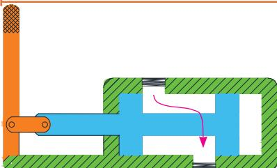
این نوع شیرها، مسیر مورد نظر حرکت سیال در مدار را تعیین می‌کند. به عبارتی از این شیرها برای کنترل مسیر جریان، حرکت و توقف جریان سیال و همچنین تغییر جهت عملگرها، در سیستم‌های هیدرولیکی استفاده می‌شود. در شکل زیر نمایی از مکانیزم یک شیر کنترل مسیر که دارای دو دهانه (ورودی و خروجی) و دو وضعیت (بسته و باز) می‌باشد، نشان داده شده است.
