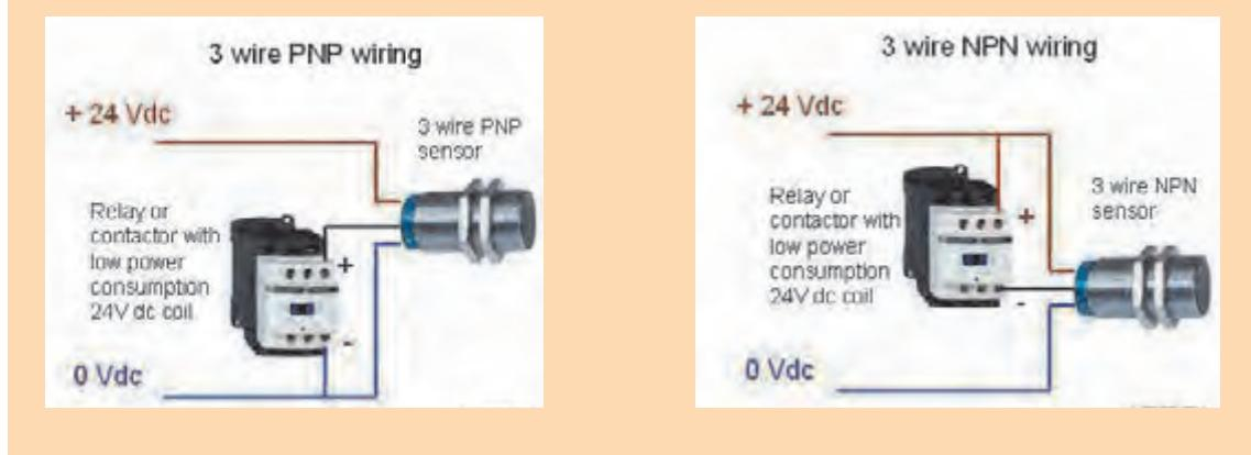
سنسورهای نوری ممکن است یک طرفه و یا دو طرفه باشند. همچنین می‌توانند دو سیم تا چهار سیم باشند که نوع چهار سیم حالت‌های مختلف نرمال باز و بسته و PNP و NPN را می‌تواند ارایه دهد.
