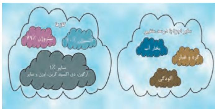
هوایی که برای سیستم‌های پنوماتیکی استفاده می‌شود هوای اطراف ما یعنی اتمسفر است. اتمسفر از گازهای مختلفی تشکیل شده است که در شکل رو به رو اجزای آن بیان شده است.
