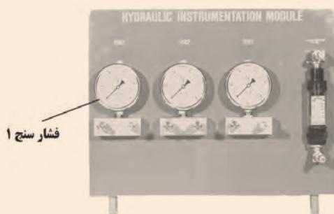
**خواندن فشار سیستم به کمک فشار سنج**
