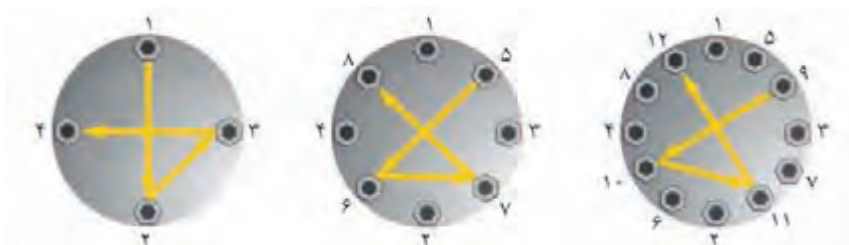
شکل ۲۳- ترتیب سفت کردن پیچ‌های فلنج
