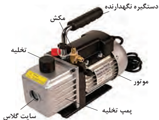
شکل ۱۳- اجزای پمپ تخلیه هوا
