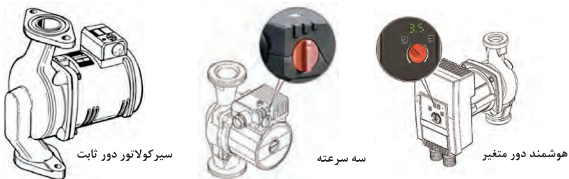
شکل ۴- قابلیت تغییر دور در سیرکولاتورها
