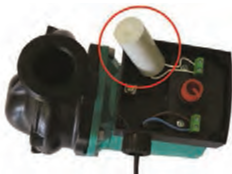
شکل ۳۵- خازن در جعبه برق موتور
