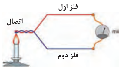
شکل ۵- نحوه اندازه گیری دما با ترموکوپل
