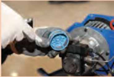
بازکردن درپوش پمپ و تمیز کردن فیلتر
