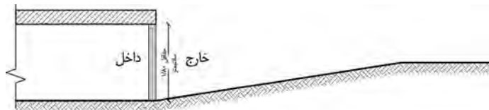
تمام رمپ در خارج ساختمان قرار دارد
