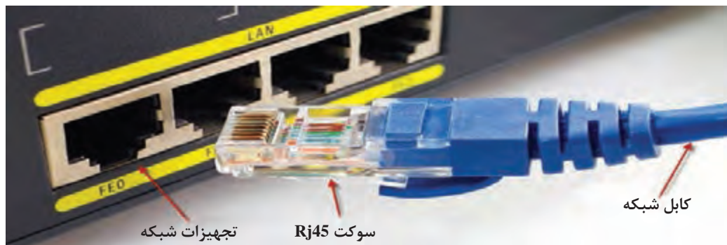
شکل ۶- اتصال سوکت Rj45 به تجهیزات شبکه
