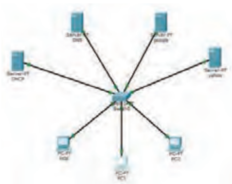
شکل ۳۹- شبیه‌سازی سرویس HTTP
