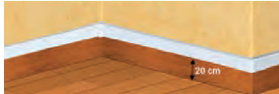
شکل ۵۲ - فاصله داکت یا ترانک از کف
