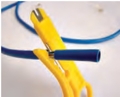
شکل ۲۵- لخت کردن سر کابل
