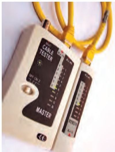
شکل ۲۰- تست کابل شبکه
