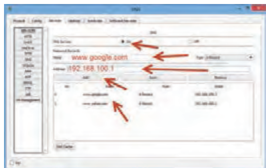
شکل ۴۰ – تنظیمات DNS Server
