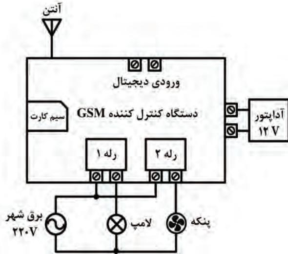
شکل ۲-۵۵- سیم کشی دستگاه کنترل کننده GSM
