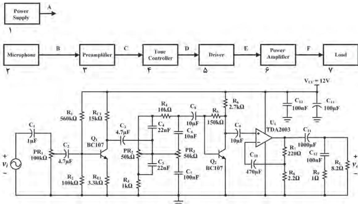
شکل ۶- بلوک دیاگرام و نقشه فنی مدار تقویت‌کننده صوتی
