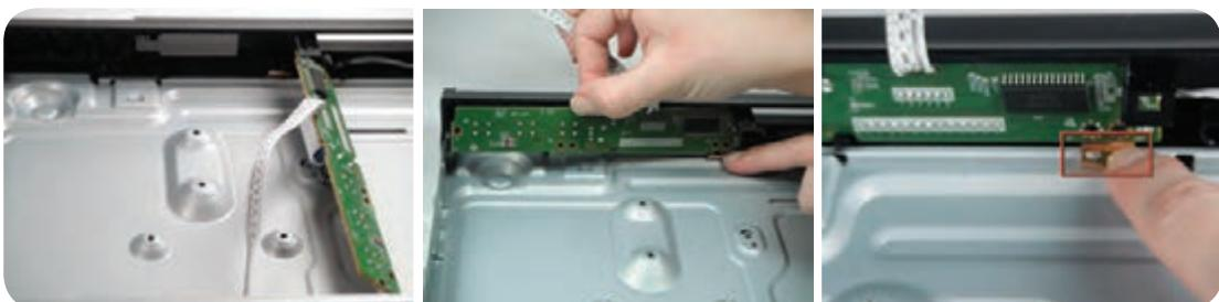
شکل ۶-۳۰-۶ زائد سمت راست      شکل ۶-۳۱-۶ فشار دادن زائد و خارج کردن برد      شکل ۶-۳۲-۶ پنل دمونتاز شده
