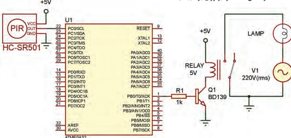
شکل ۲-۳۴- نقشه الکترونیکی اتصال مژول HC-SR501 به میکروکنترلر
