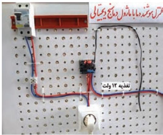
شکل ۲-۴۵ نحوه سیم‌کشی مژول دماسنج WX-۱۰۱W
