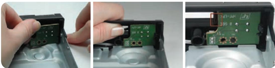
شکل ۶-۳۵-۶ دمونتاز برد کوچک      شکل ۶-۳۴-۶ فشار دادن زائد پلاستیکی      شکل ۶-۳۳-۶ محل زائد پلاستیکی
