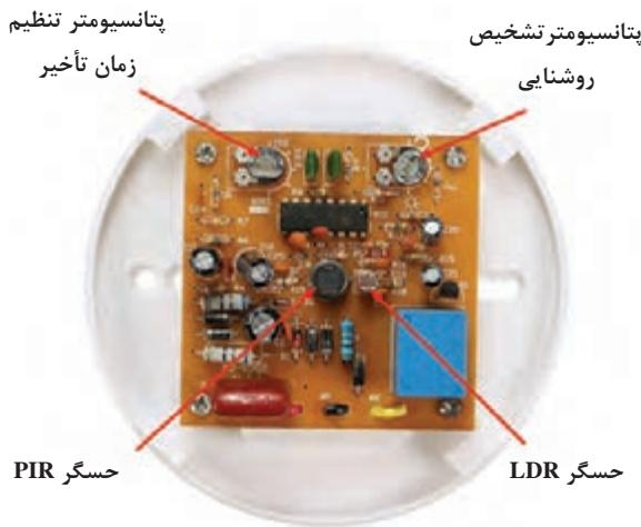
شکل ۲-۲۷- مدار داخلی یک نمونه حسگر سقفی
