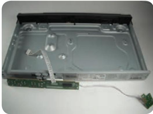
شکل ۶-۳۷- دمونتاژ پنل‌ها
