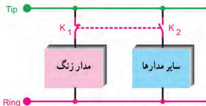
کلید هم محور  $K_1$  بسته و کلید  $K_2$  باز و دستگاه آماده دریافت سیگنال زنگ است.
