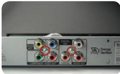
شکل ۶-۲۲ باز کردن پیچ های اتصال دهنده برد
