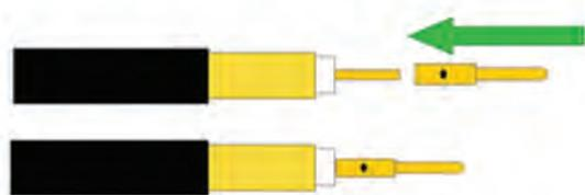
شکل ۳-۲۳- چگونگی اتصال فیش به کابل
