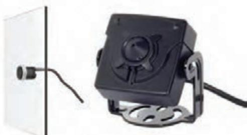
شکل ۳-۱۶- دو نمونه دوربین پین هول
