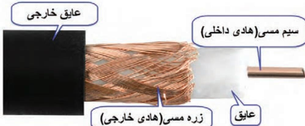
شکل ۴-۲- کابل کواکسیال و اجزای آن
