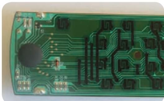
شکل ۱-۶- قطعات روی برد دستگاه ریموت کنترل
