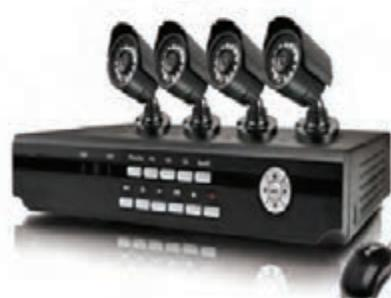
شکل ۳-۳۰- یک نمونه دستگاه DVR
