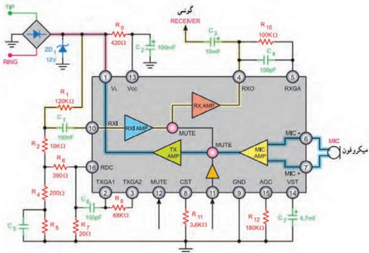
شکل ۵-۳۱-۵- مدار ساده مکالمه
