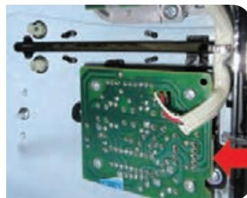
شکل ۶-۵۱-۶ محل اتصال سوکت به بُرد الکترونیکی      شکل ۶-۵۲ سوکت از بُرد جدا شده است
