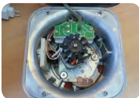
شکل ۱-۲۴- موتور، برد الکترونیکی و پروانه
