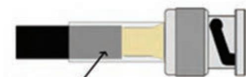
شکل ۳-۲۶- حلقه روی شیلد و قسمتی از بدنه قرار می گیرد.
