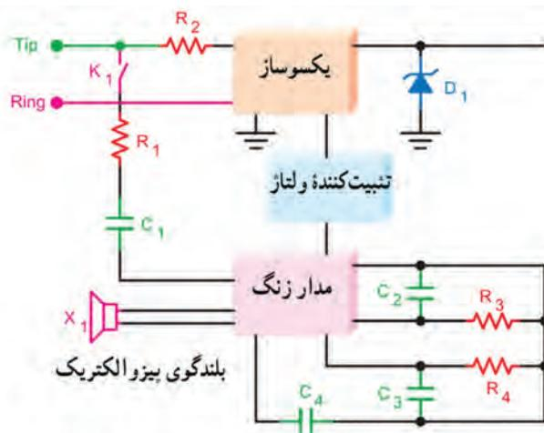
شکل ۵-۲۱- بلوک دیاگرام سیگنال زنگ
