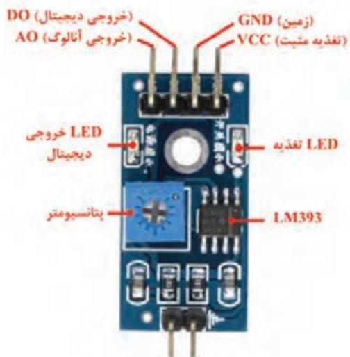
شکل ۲-۵۰ - اجزای برد الکترونیکی مژول رطوبت سنج YL-69
