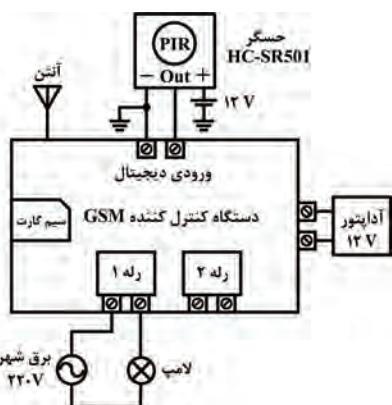
شکل ۲-۵۷- اتصال حسگر مادون قرمز به دستگاه کنترل کننده GSM
