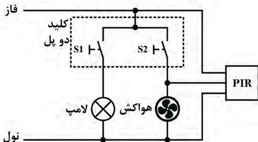
شکل ۲-۳۱- شماتیک مسیر جریان اتصال حسگر حرکتی
