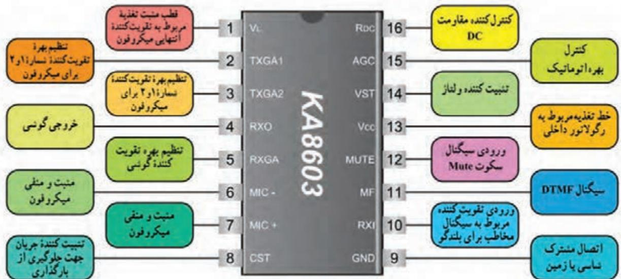
شکل ۵-۳۰- مشخصات پایه‌های ای‌سی KA8603
