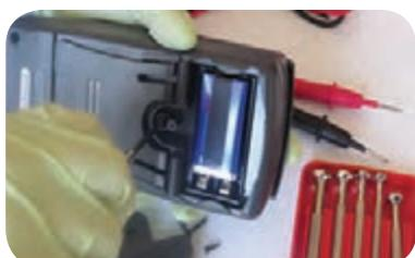
شکل ۱-۱۴- باز کردن پیچها و آزادسازی خارها
