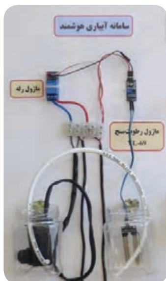
شکل ۲-۵۲- نحوه سیم‌کشی ماژول دماسنچ YL-۶۹
