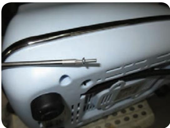
شکل ۶-۴۳- استفاده از ابزار خاص برای پیچ‌های ویژه
