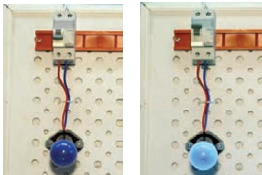
(الف) قبل از عمل کردن کلید FI      (ب) بعد از عمل کردن کلید FI
