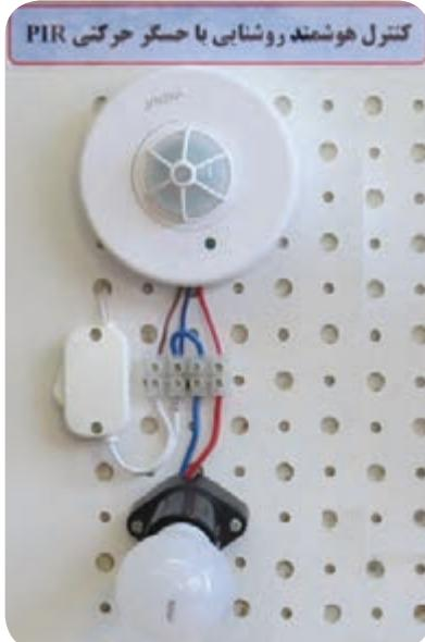
شکل ۲-۲۹- نحوه سیم‌کشی حسگر حرکتی PIR
