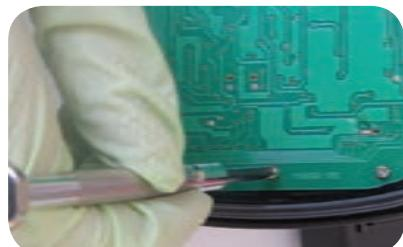
شکل ۱-۱۶- باز کردن پیچهای اتصال بدنه
