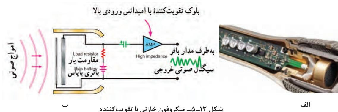
شکل ۱۳-۵- میکروفون خازنی با تقویت کننده
