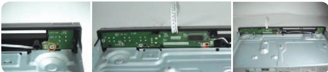
شکل ۶-۲۷-۶ قراردادن برد مدار چاپی      شکل ۶-۲۸-۶ باز کردن ۳ پیچ پنل بزرگ      شکل ۶-۲۹-۶ پیچ پنل کوچک
