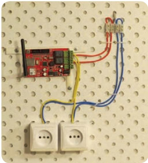
شکل ۲-۵۶- نحوه سیم کشی دستگاه کنترل GSM
