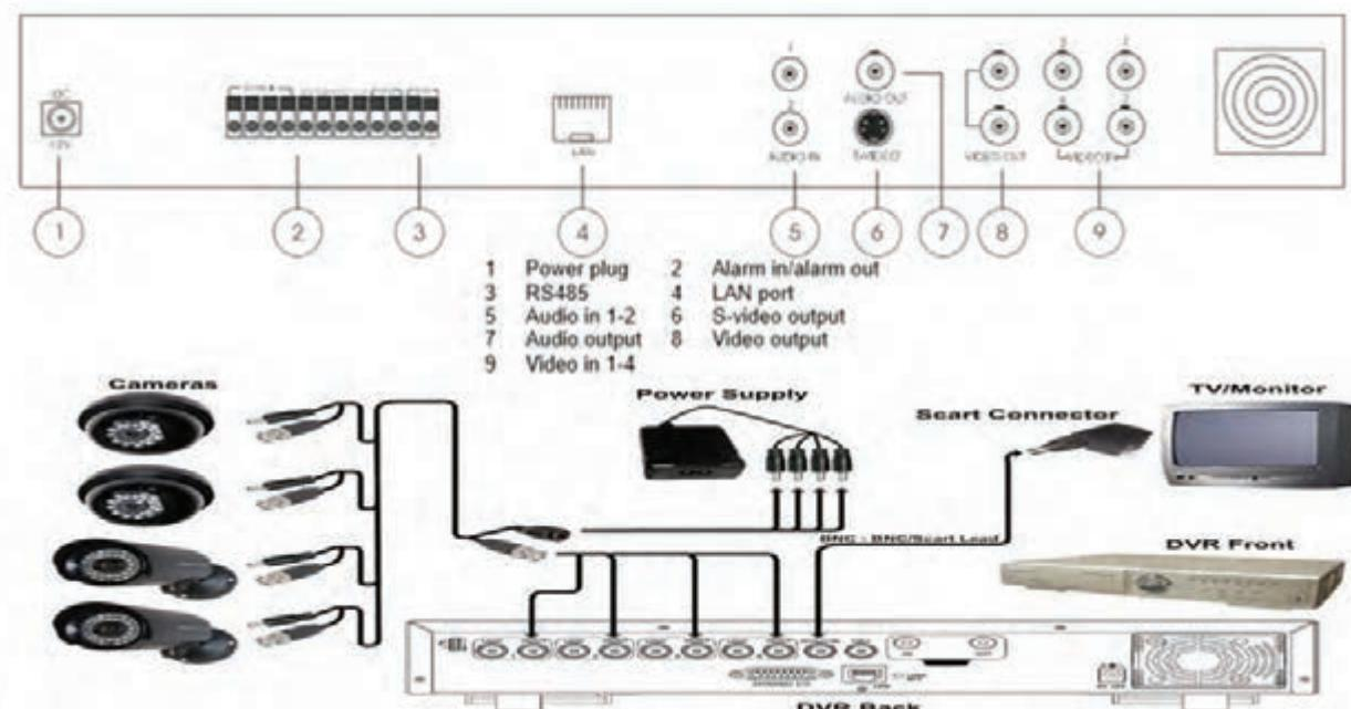
شکل ۳-۲۳-نمای پشتی یک نمونه دستگاه DVR
