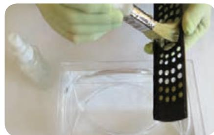
شکل ۱-۱۰- تمیز کردن کن tact ها با الکل
