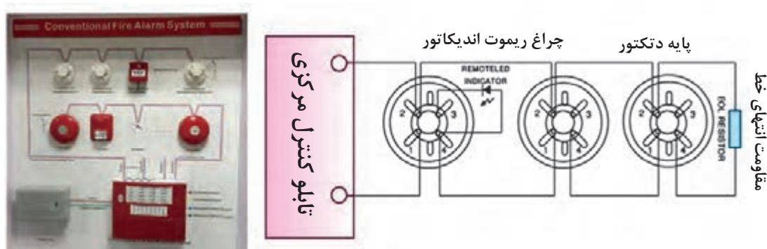
شکل ۳-۵۲- نقشه اتصال آشکارسازها به تابلو کنترل مرکزی
