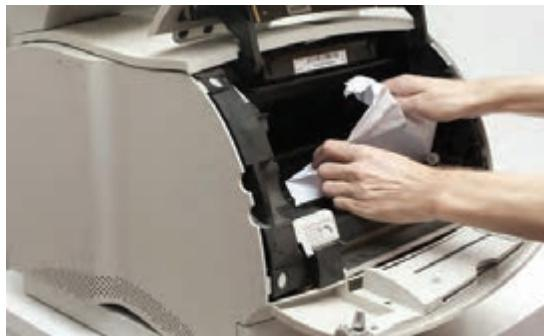
شکل ۱-۳۷- عیب یابی درگیر کردن کاغذ
