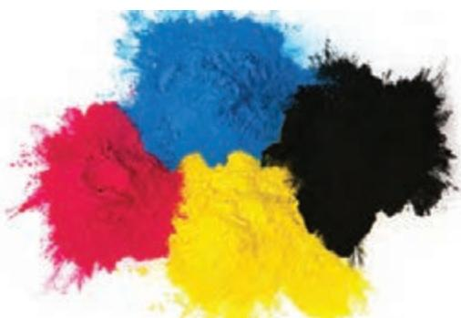
☒ **تونر (Toner):** طبق شکل ۲-۲۷ تونر ترکیبی از رنگدانه و پلاستیک است که در چاپ لیزری به جای جوهرهای مایع برای چاپ بر روی کاغذ استفاده می‌شود. مواد تشکیل‌دهنده تونر فقط جوهر نیست. پودر تونر بسیار نرم، از دانه‌های بسیار ریز پلاستیک ساخته شده که دانه‌های رنگی نیز به آنها چسبیده است.
