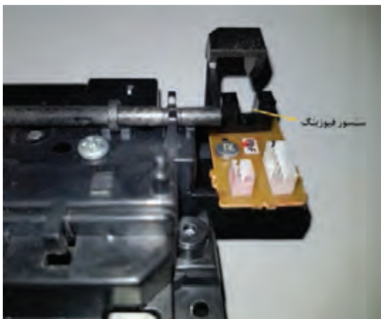
شکل ۳-۳۵- سنسور خروجی فیوزینگ یونیت
