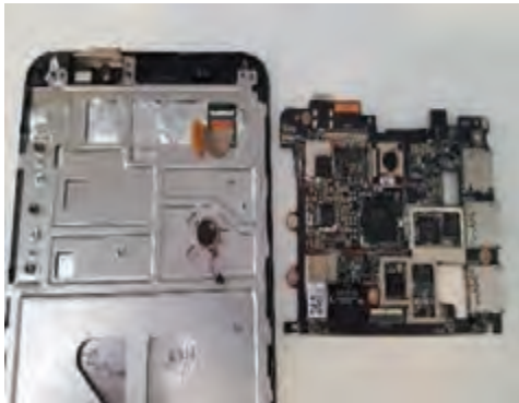
شکل ۵-۳۳- جدا کردن کامل برد از بدنه
