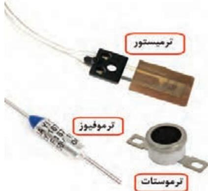
شکل ۲-۳۸ - قطعات حرارتی واحد فیوزینگ
