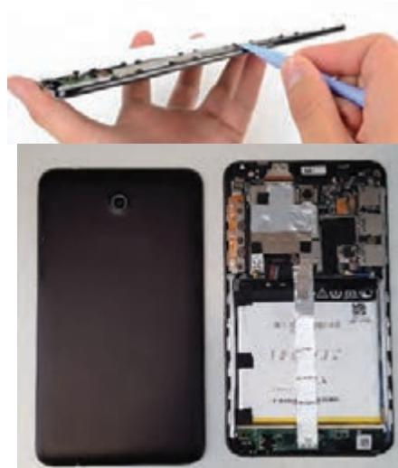
شکل ۵-۲۹- استفاده از کاردک برای جدا کردن قاب از بدنه
