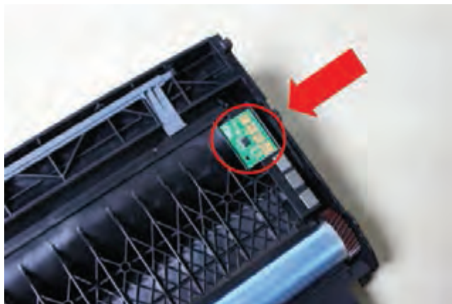
شکل ۴۶-۳- کارتریج مجهز به برد چیپ ست
