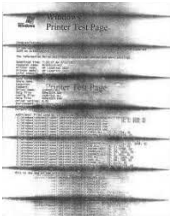
شکل ۱-۳۹- چاپ سیاه به دلیل خرابی کارت‌تریج
