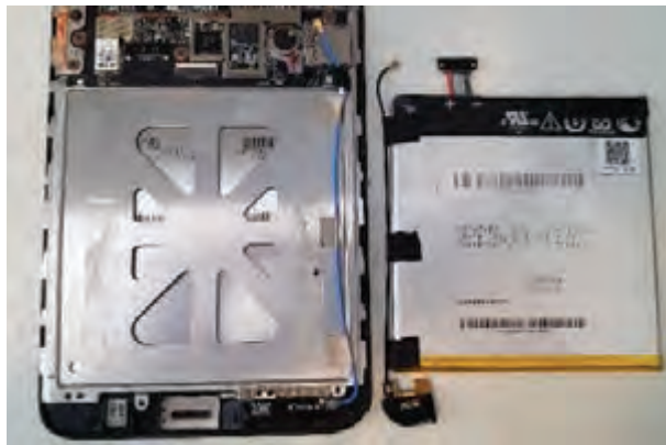
شکل ۳۰-۵- جدا کردن باتری از بدنه اصلی
