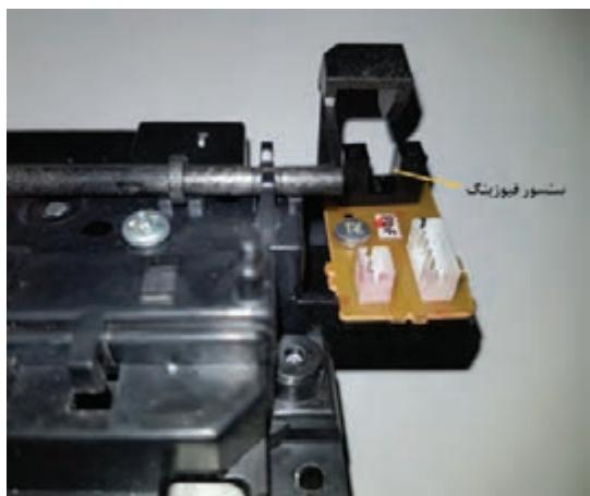
شکل ۳-۳۵- سنسور خروجی فیوزینگ یونیت
