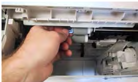
شکل ۲۲-۳ تعویض Separation Roller
