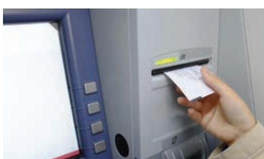
شکل ۱-۶- پرینتر حرارتی دستگاه ATM
