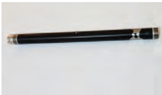
شکل ۳-۳۷- غلتک هات معیوب
