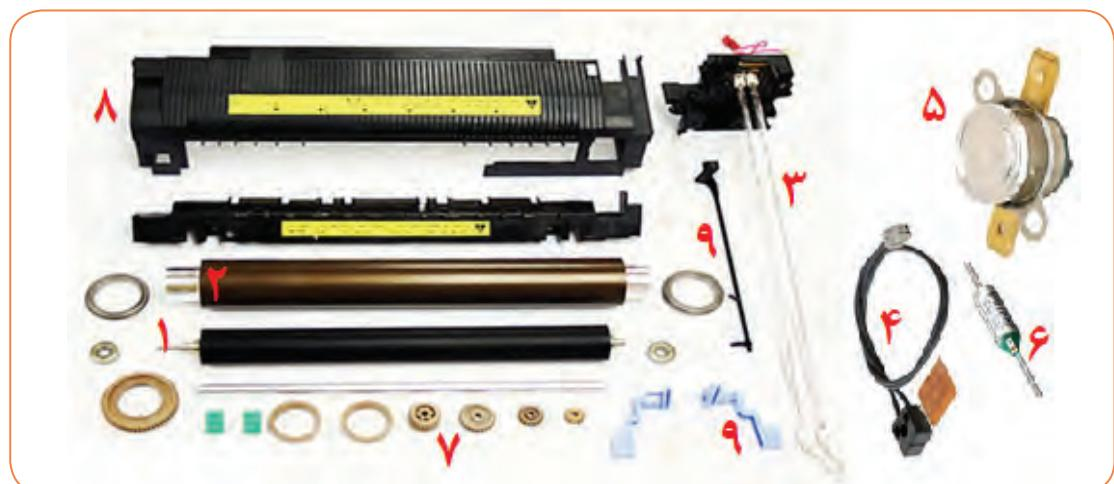
شکل ۲-۳۴ - اجزای تشکیل دهنده فیوزینگ یونیت
