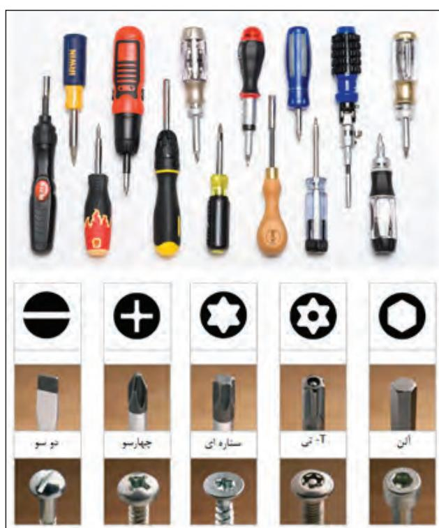
شکل ۳-۴- نمونه ابزار و انواع پیچ‌ها
