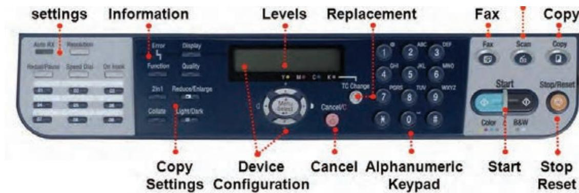
شکل ۲-۴- صفحه نمایش یک دستگاه چهارکاره (MFP)
