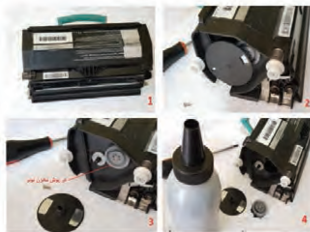
شکل ۴۸-۳- مراحل شارژ یک نمونه کارت‌تریج لیزری
