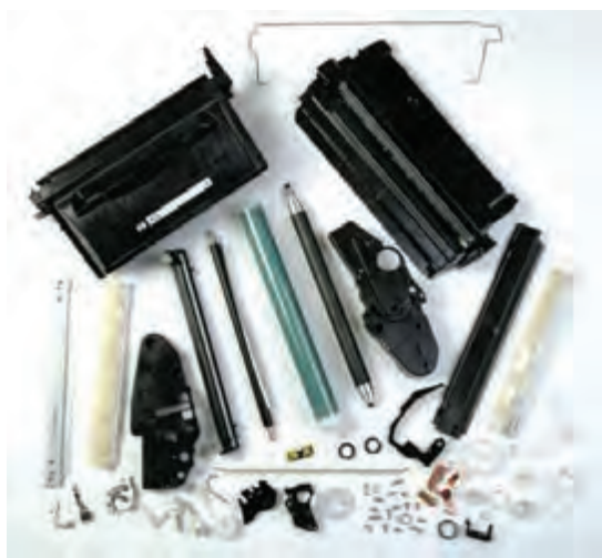
شکل ۲۸-۲ - قطعات تشکیل دهنده کارتریج All In One
