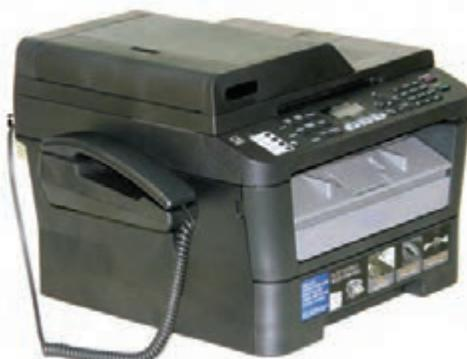
شکل ۲-۳ – دستگاه چهارکاره (MFP) گوشی‌دار
