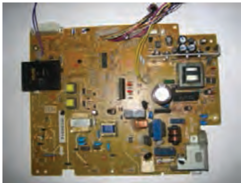
شکل ۲-۲۳- برد «های ولتاژ»
