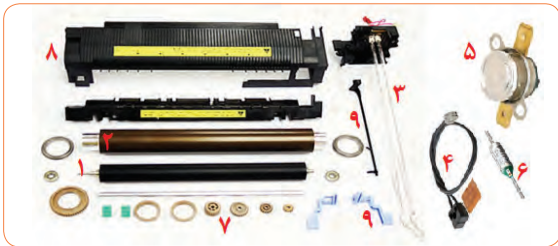
شکل ۲-۳۴ - اجزای تشکیل‌دهنده فیوزینگ یونیت
