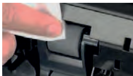
شکل ۶۱-۱. سرویس قطعات کششی
