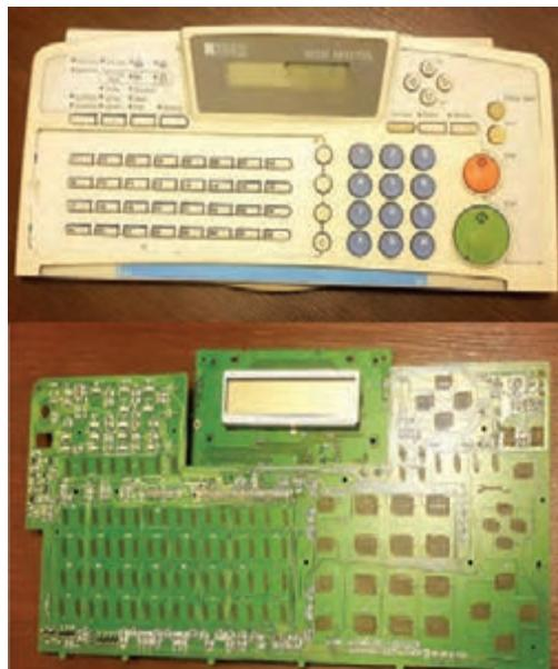
شکل ۳-۴۲- پنل گرافیتی (کربنی)
