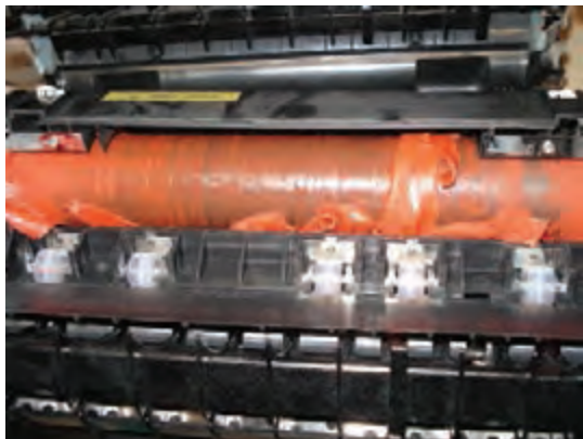
شکل ۳-۳۶- غلتک پرس معیوب
