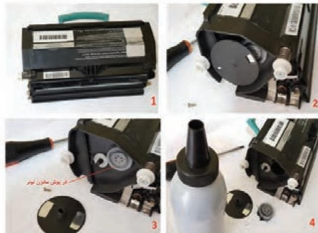
شکل ۳-۴۸- مراحل شارژ یک نمونه کارتريج لیزری
