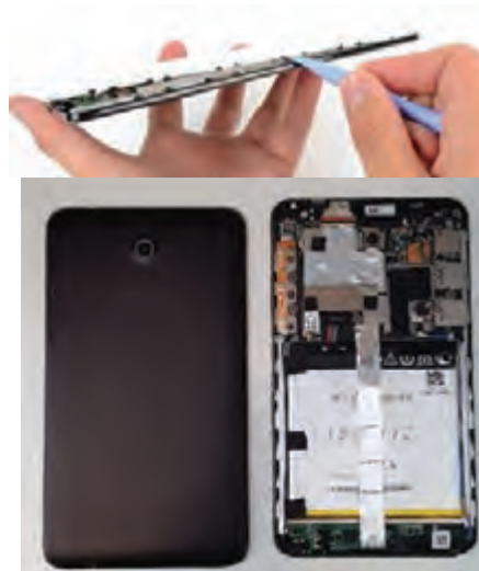
شکل ۲۹-۵- استفاده از کاردک برای جدا کردن قاب از بدنه
