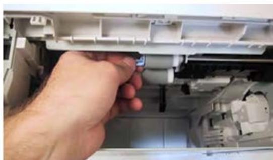
شکل ۳-۲۲- تعویض Separation Roller
