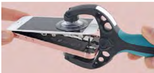
شکل ۵-۳۵- جدا کردن صفحه لمسی با ابزار وکیوم
