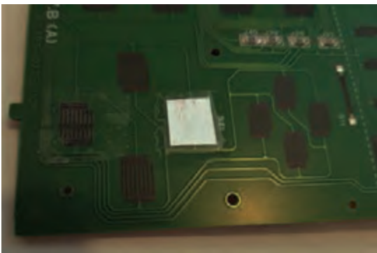
شکل ۴۳-۳ تعمیر لایه کربنی پنل با روش پیشنهادی
