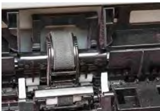
شکل ۳-۲۰- محل غلتک کاغذ کش در داخل پرینتر
